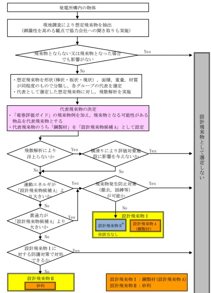
図3.3.1.1 設計飛来物の選定フロー
