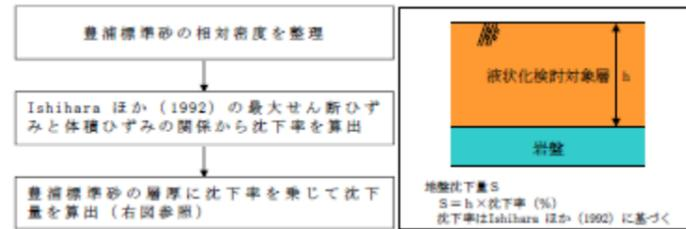
第6図 排水沈下量の算定フロー
