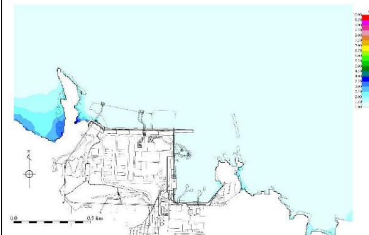
図 4 (2) 入力津波 4 (防波堤有り) 最高水位分布
