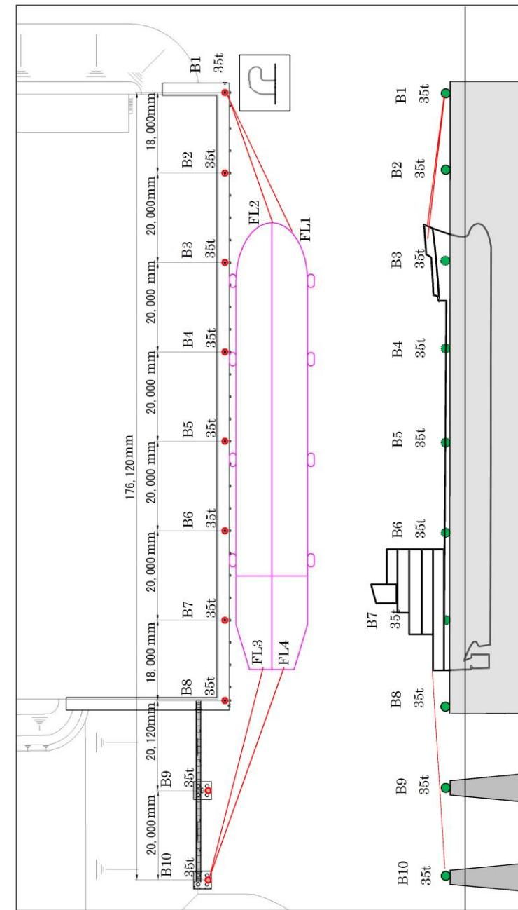
第1図 輸送船、係留索、係船柱の配置
