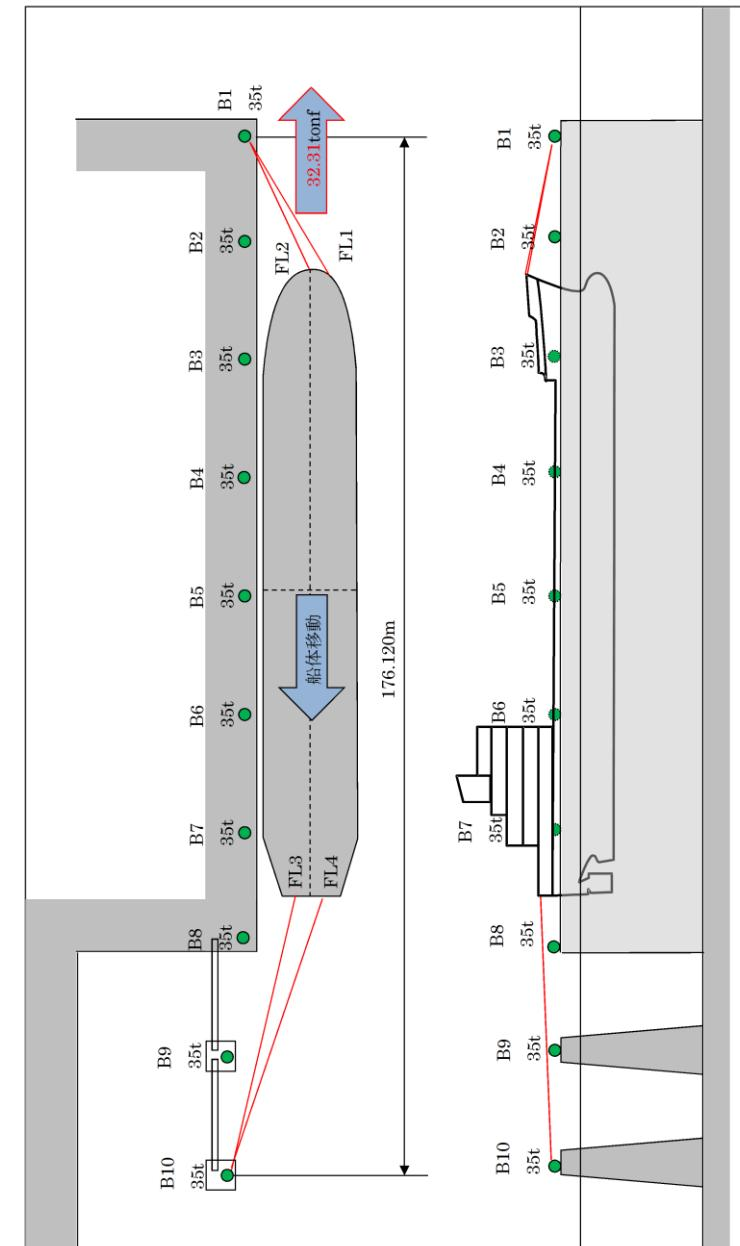
第5図 船尾方向への移動に対する船首方向係留力
