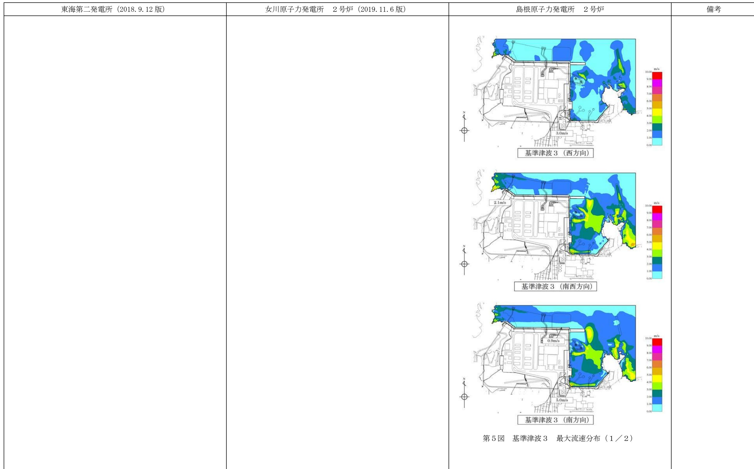
第5図 基準津波3 最大流速分布 (1／2)
