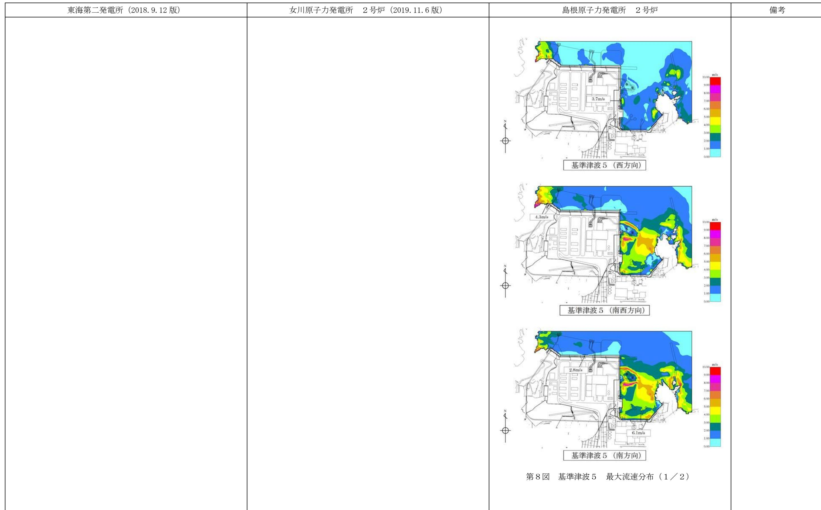
第8図 基準津波 5 最大流速分布 (1 / 2)
