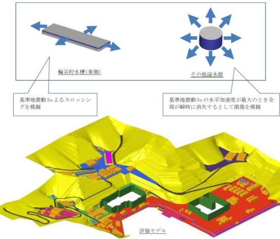
図 10-3-1 溢水伝播挙動の評価モデル
