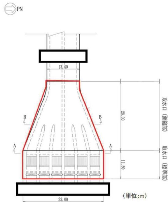
第II.1.2-4 図 取水口平面図
