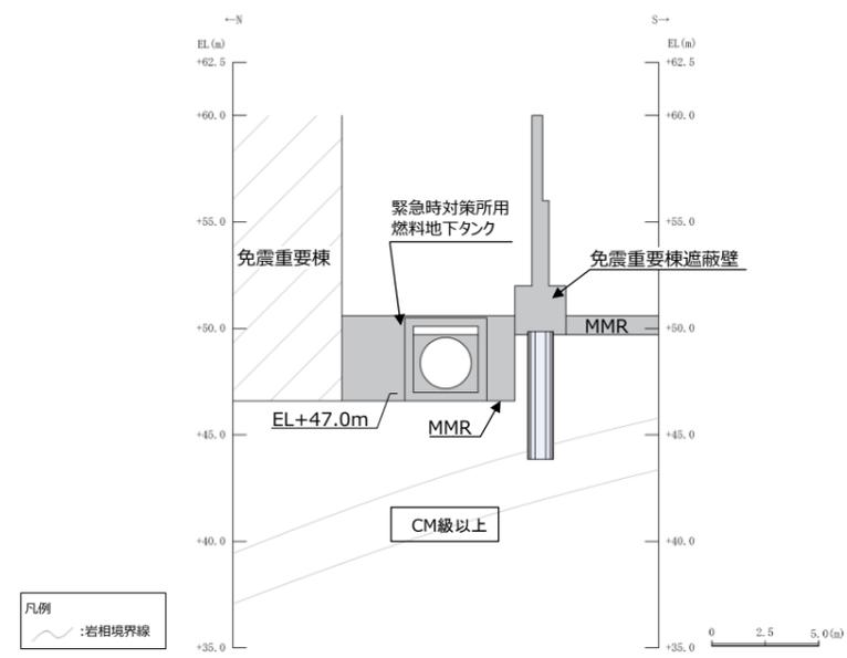
第6-2-6-6図 緊急時対策所用燃料地下タンク
