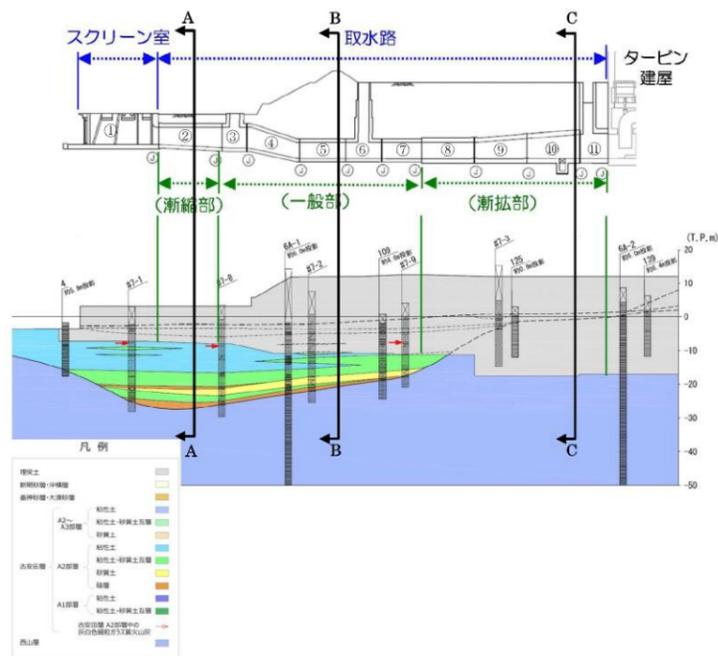
第12-1-7 図 7号炉取水路 縦断面図
