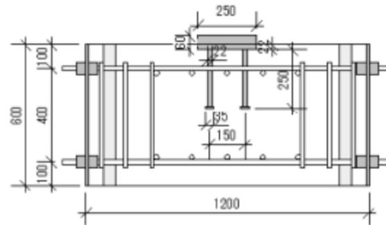
添付1-3 図 試験体の形状と寸法
