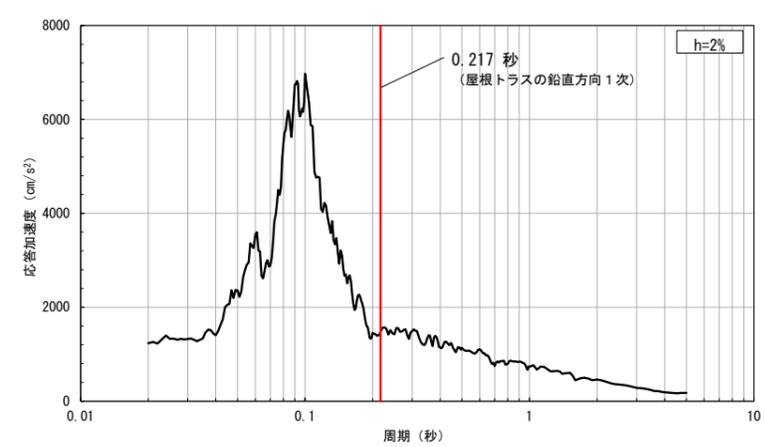
第1-2図 (1) 屋根トラスの固有周期と入力地震動の加速度応答スペクトル (基準地震動 S<sub>s</sub>-D) の関係 鉛直方向
