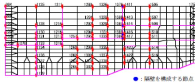
添付2-4 図 応答加速度算出節点
