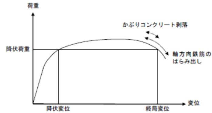
第 I. 2. 1-1 図 コンクリート標準示方書2002 による構造部材の終局変位の考え方
