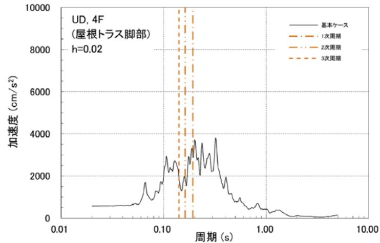
第2図 (a) 固有振動数と入力動の加速度応答スペクトルの関係
