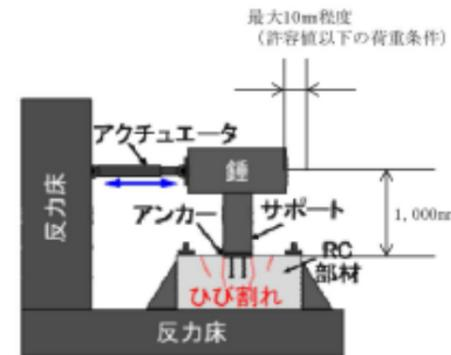
添付1-10 図 試験装置の概略図
