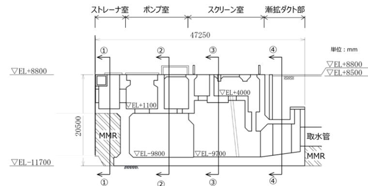
第6-2-2-5図 取水槽 縦断面図 (5-5断面)
