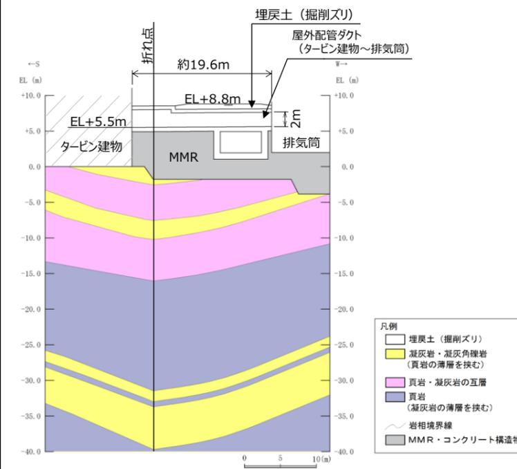
第6-2-7-9図 屋外配管ダクト（タービン建物～排気筒）地質
