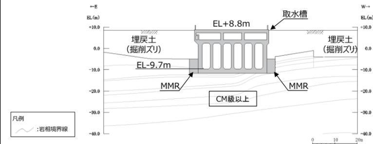
第6-2-2-13図 取水槽 岩級断面図 (③-③断面)
