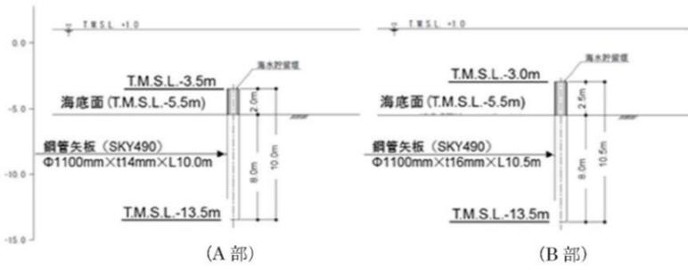
第12-1-17 図 6号及び7号炉海水貯留堰 断面図
