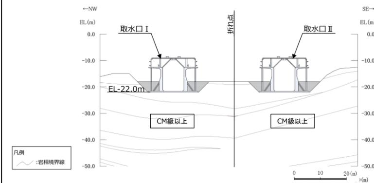
第6-2-11-8図 取水口 岩級断面図 (③-③断面)
