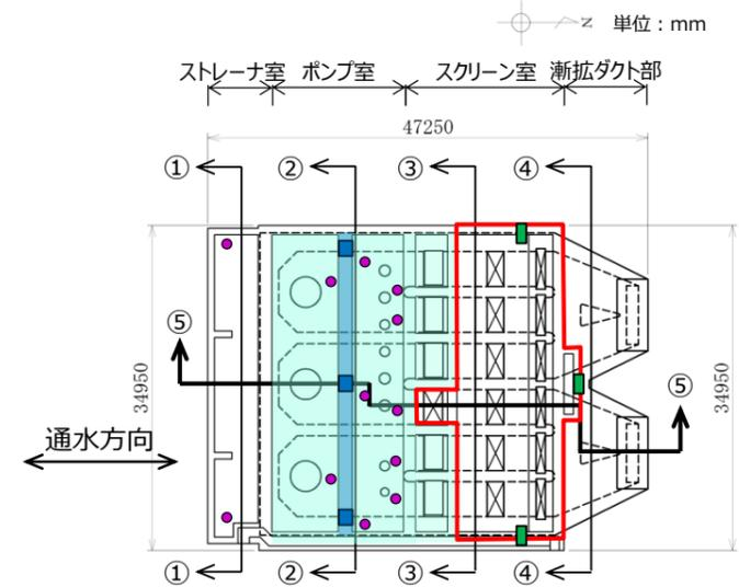
第6-2-2-3図 取水槽 設置される設備の配置図 (平面図)
