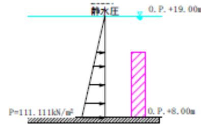
添付2-9 図 漏水量算定時の作用圧力
