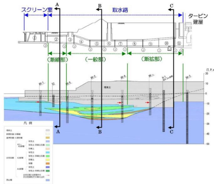
第12-1-6 図 6号炉取水路 縦断面図
