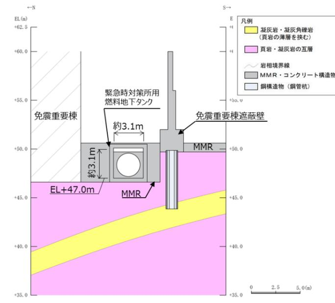
第6-2-6-5図 緊急時対策所用燃料地下タンク 地質断面図
