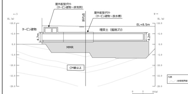
第6-2-8-8図 屋外配管ダクト (タービン建物～放水槽) 岩級
