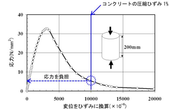
第5-2-2 図 コンクリートの圧縮試験例<sup>(3)</sup>
