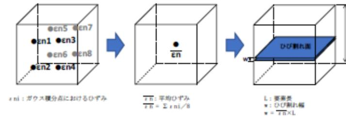
添付2-8 図 ひび割れ幅の算定方法
