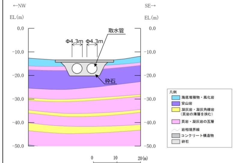
第6-2-13-10図 取水管 地質断面図 (④-④断面)
