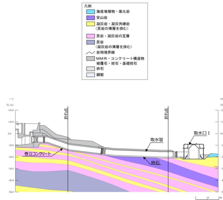
第6-2-13-12図 取水管 地質縦断面図 (⑥-⑥断面)
