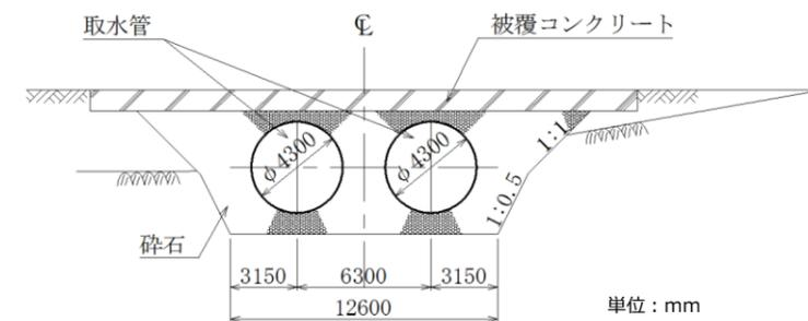
第6-2-13-6図 取水管 断面図 (③-③断面)
