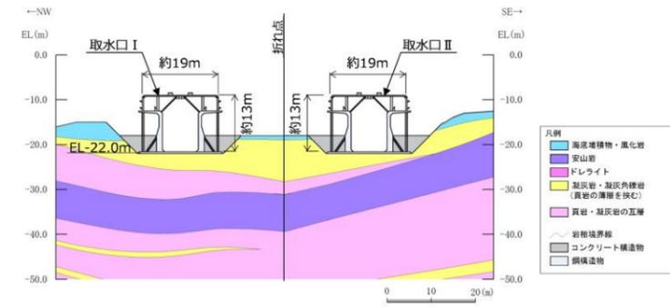
第6-2-11-6図 取水口 地質断面図 (③-③断面)
