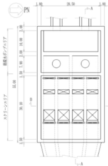
第II. 1. 2-15 図 3号炉海水ポンプ室平面図
