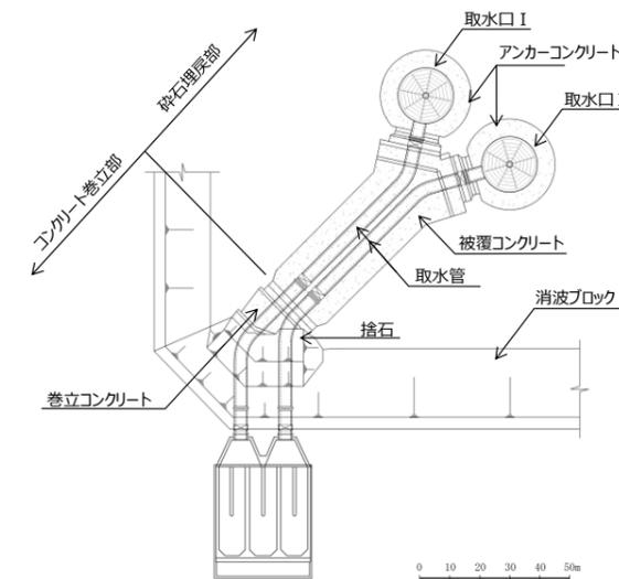
第6-2-13-5図 取水管 平面図 (詳細図)
