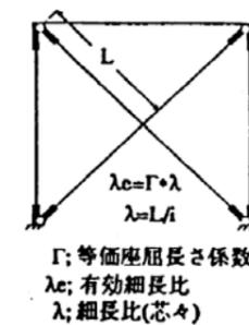
第2.4.2 図 試験体の概要 ([1]より引用)
