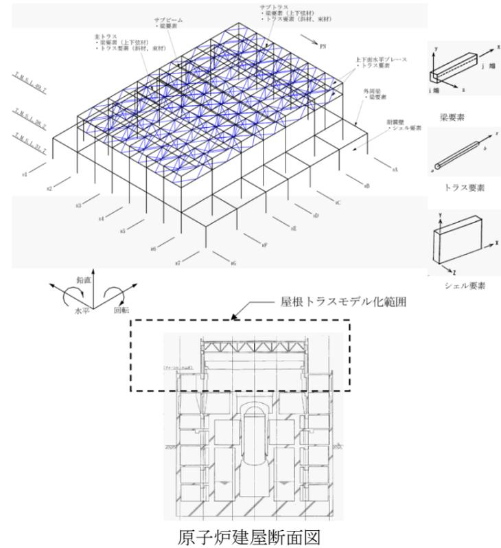
第 2.2.1 図 屋根トラスの解析モデルの概要
