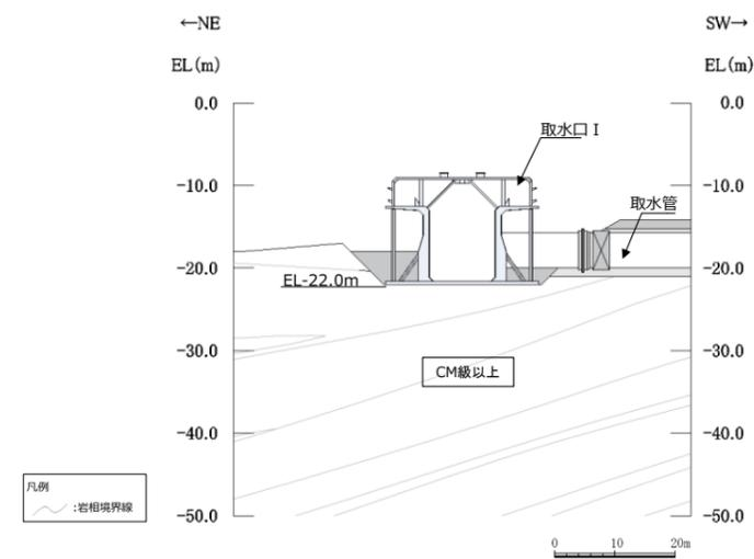
第6-2-11-7図 取水口 岩級断面図 (②-②断面)
