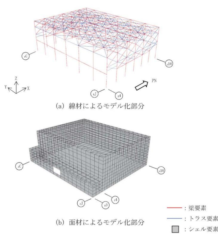
第 2.3-1 図 屋根トラスの解析モデルの概要
