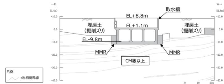
第6-2-2-12図 取水槽 岩級断面図 (②-②断面)
