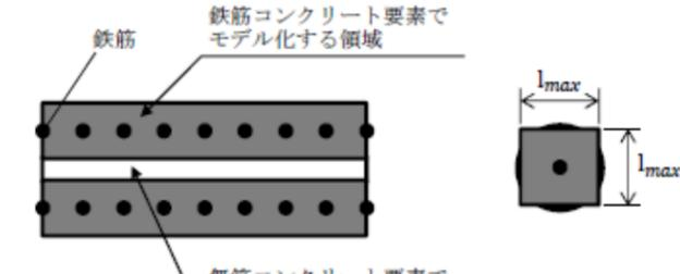
$l_{max} = \frac{\sqrt{\pi}}{2} D_b \sqrt{\frac{f_y}{f_t}}$ <p>ここに、<math>l_{max}</math> : 鉄筋一本当たりの付着有効面積を正方形で考えた場合の一辺の長さ<br/> <math>D_b</math> : 鉄筋の直径<br/> <math>f_y</math> : 鉄筋の降伏強度<br/> <math>f_t</math> : コンクリートの引張強度</p> <p>第5-2-9図 鉄筋付着有効領域と無筋領域の分割の概要</p> |    |
