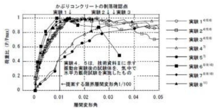
第 I. 2. 1-2 図 鉄筋コンクリート製ラーメン構造の破壊実験<sup>(1), (2)</sup>
