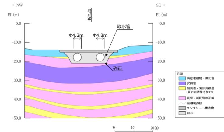
第6-2-13-11図 取水管 地質断面図 (⑤-⑤断面)
