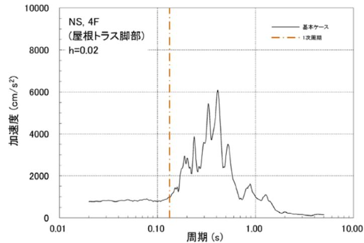
第2図 (b) 固有振動数と入力動の加速度応答スペクトルの関係
