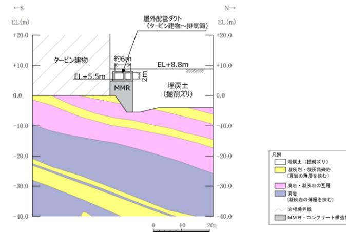
第6-2-7-8図 屋外配管ダクト（タービン建物～排気筒）地質
