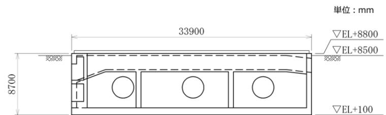
第6-2-2-6図 取水槽 断面図 (1-1断面)
