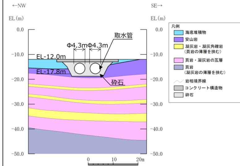
第6-2-13-9図 取水管 地質断面図 (③-③断面)
