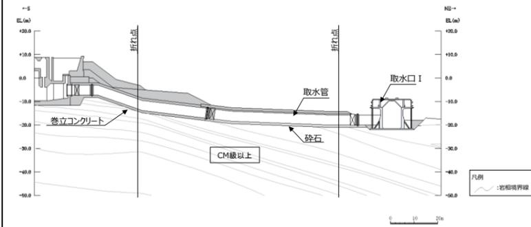
第6-2-13-13図 取水管 岩級縦断面図 (⑥-⑥断面)
