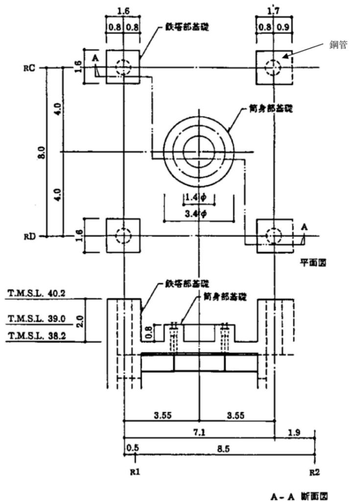
第1図 主排気筒基礎の概要
