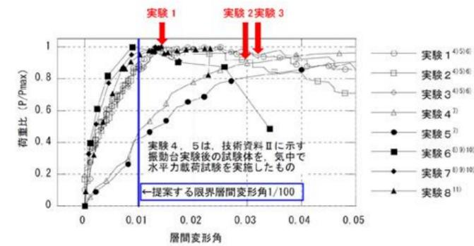
第3-2-2 図 鉄筋コンクリート製ラーメン構造の破壊実験例<sup>(4) 5)</sup>
