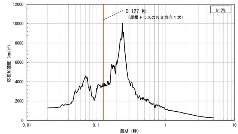
第1-2図 (2) 屋根トラスの固有周期と入力地震動の加速度応答スペクトル (基準地震動 S<sub>s</sub>-D) の関係 NS方向
