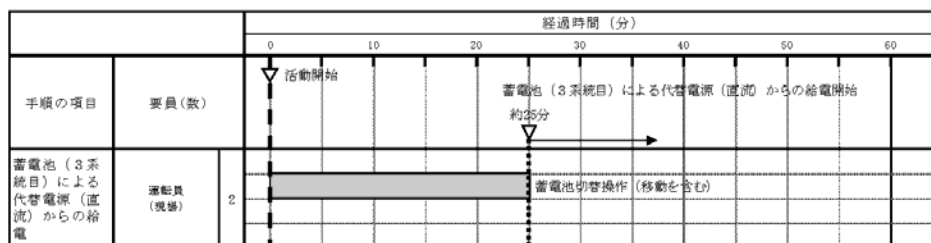
第 1.14.26 図 蓄電池 (3 系統目) による代替電源 (直流) からの給電 タイムチャート
