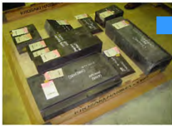
接液部耐火レンガの組立前検査 (外観、材料確認等)
