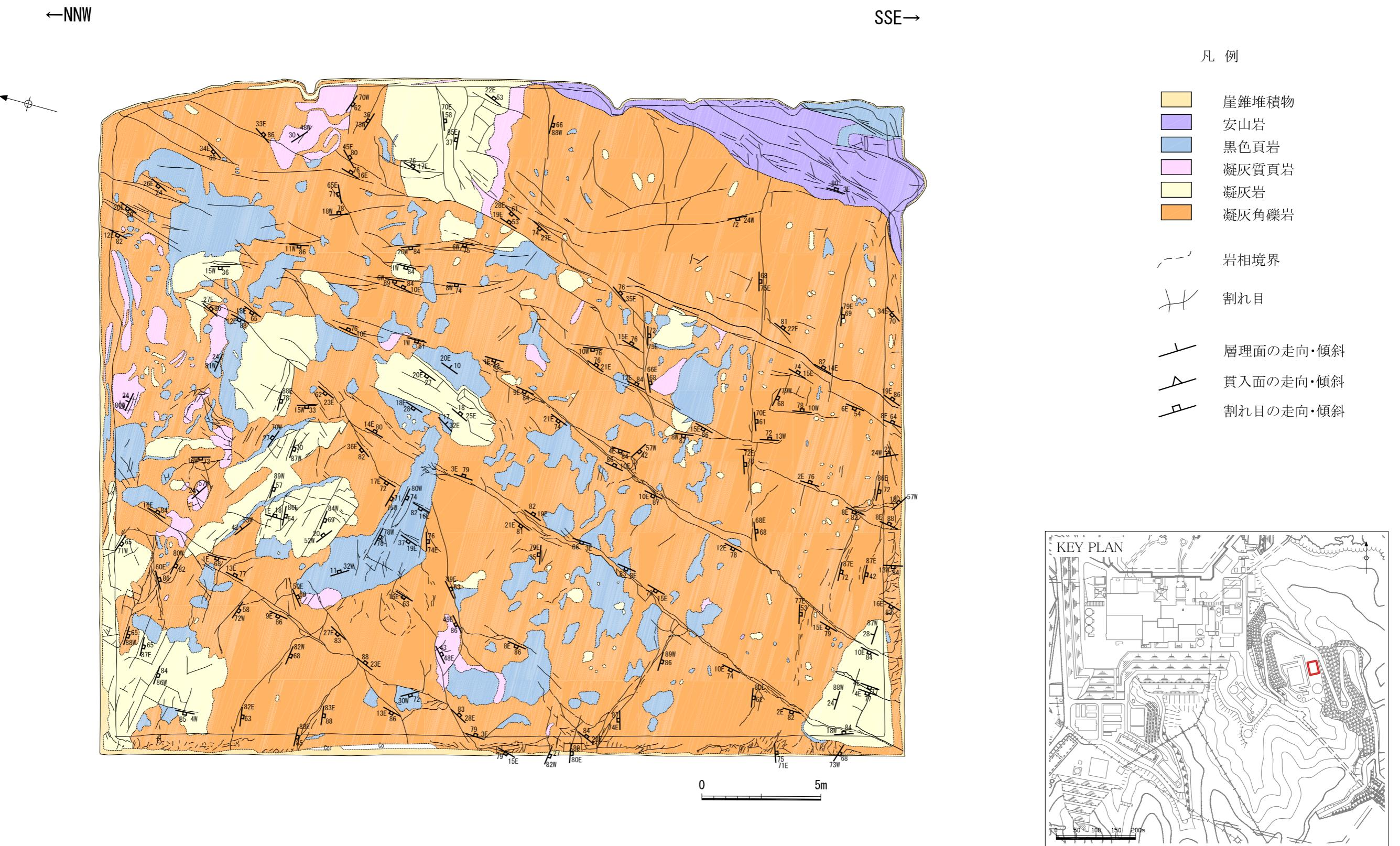
第3.4-9図 底面スケッチ（緊急時対策所設置位置）
