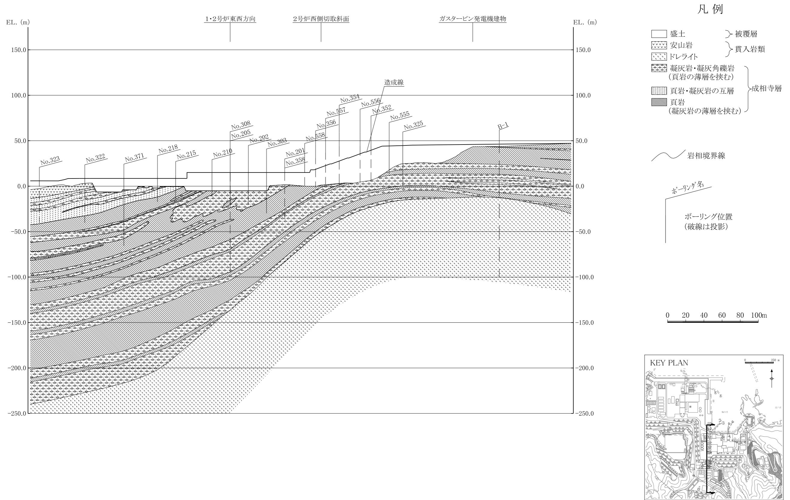
第3.4-6図(4) 地質鉛直断面図 (南側盛土斜面)
