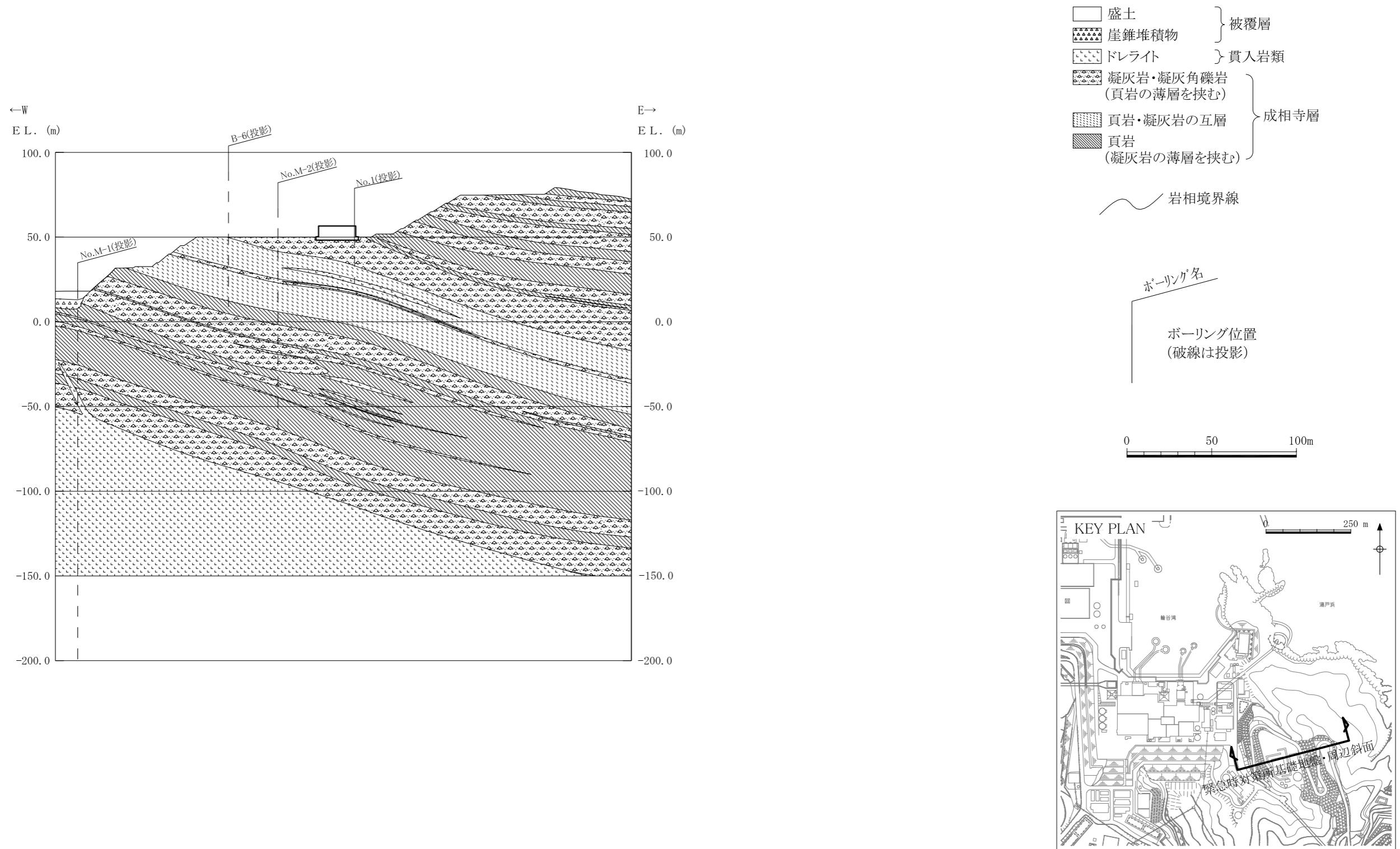
第3.4-10図 地質鉛直断面図（緊急時対策所設置位置）
