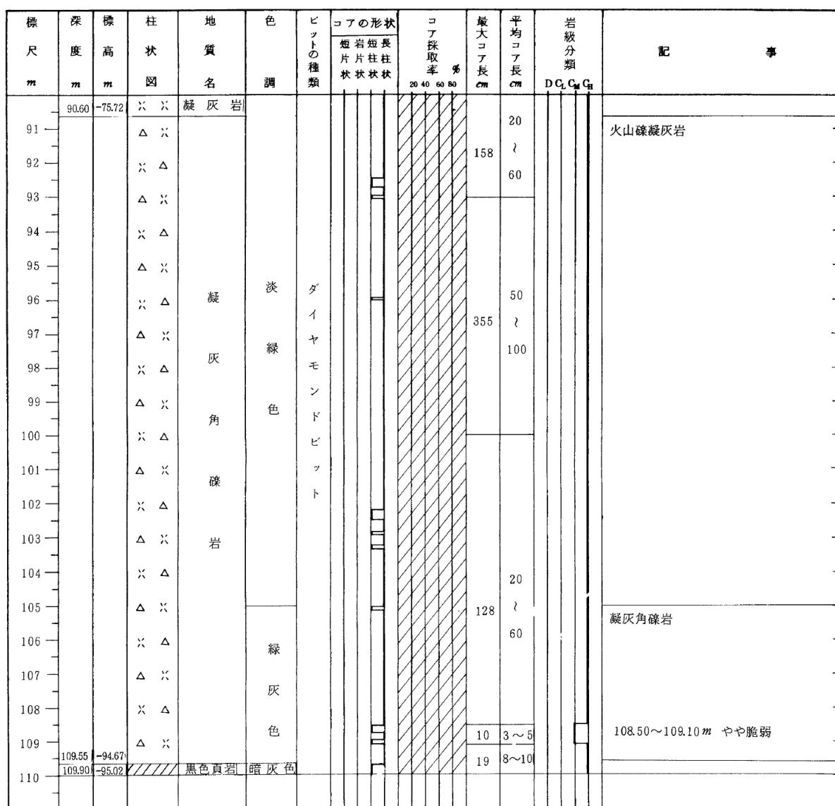
第3.4-12図(54) 地質柱状図 (N<sub>O.</sub> 308・その4)
