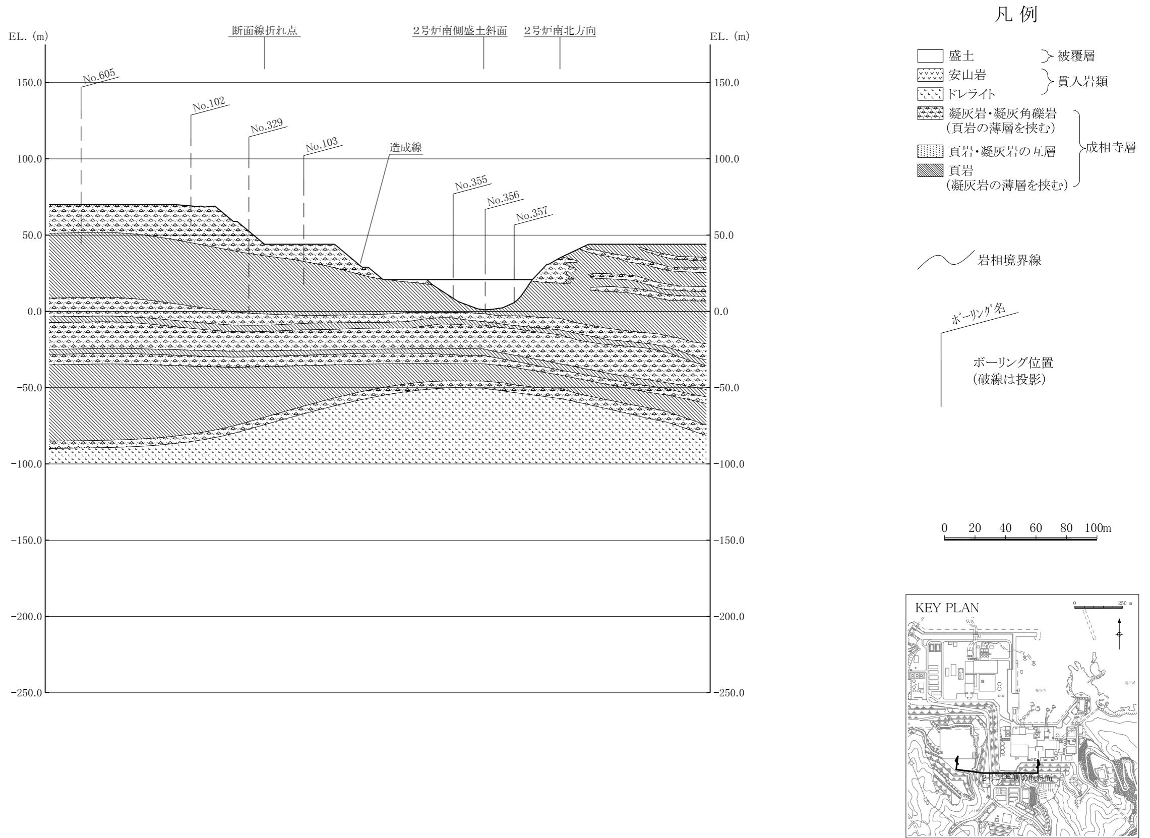
第3.4-6図(3) 地質鉛直断面図（西側切取斜面）
