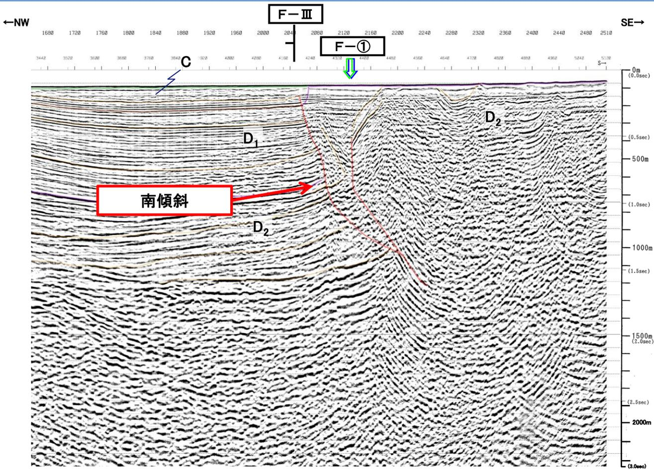
音波探査解析図(エアガン・マルチチャンネル) 約1km
