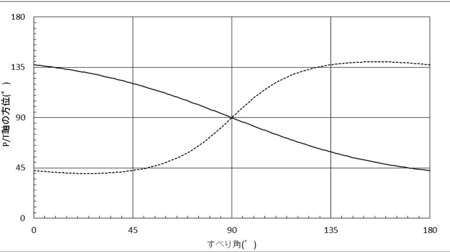
すべり角とP軸・T軸の方位の関係(断層走向0° 傾斜角67.5° の場合)
