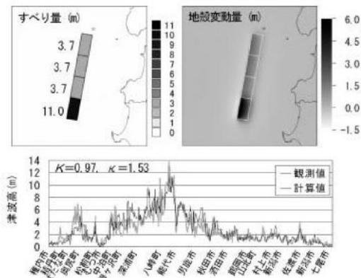
アスペリティモデルの断層モデルと計算津波高
