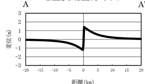
地盤変動量断面図
