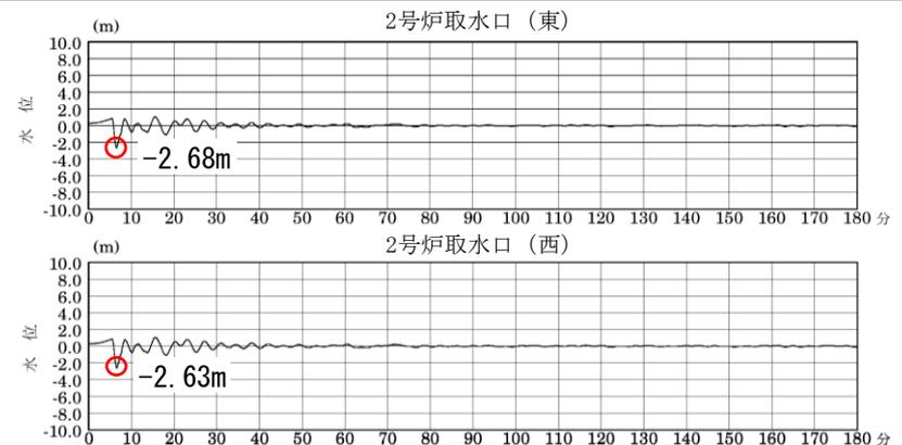
2号炉取水口(東): 最大水位下降量-2.68m+朔望平均干潮位T.P.-0.02m
