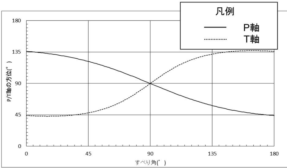
すべり角とP軸・T軸の方位の関係(断層走向0° 傾斜角75° の場合)
