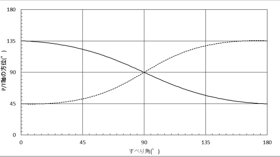
すべり角とP軸・T軸の方位の関係(断層走向0° 傾斜角82.5° の場合)
