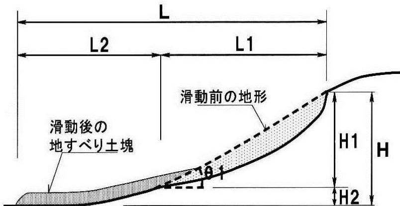
図-1 地すべり土塊の移動距離の計測方法
