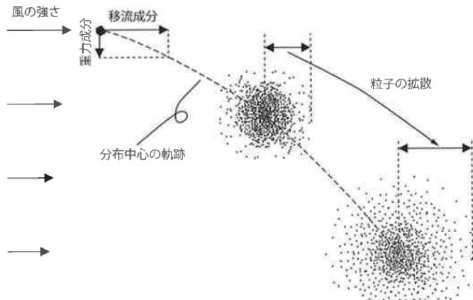
図 1 移流拡散モデルの概念図
