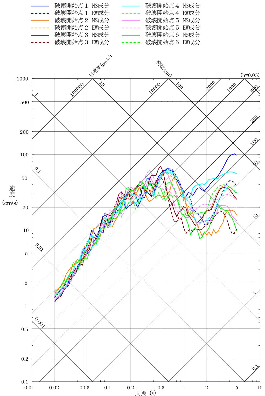
第 5.6-11 図(13)「F - III断層 + F - IV断層 + F - V断層による地震」の断層モデルを用いた手法による地震動評価結果（水平方向）
