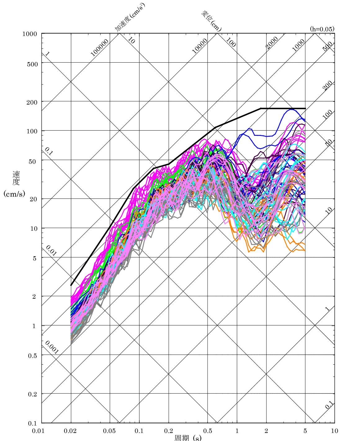
第 5.6-16 図(1) 基準地震動 S s - D H の設計用応答スペクトルと「F - III断層 + F - IV断層 + F - V断層による地震」の断層モデルを用いた手法による地震動評価結果の比較（水平方向）
