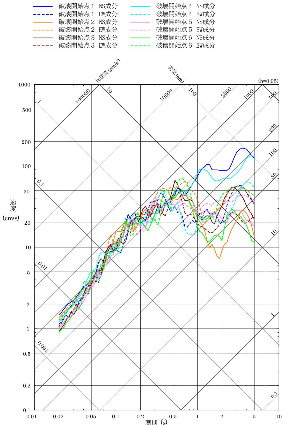
第 5.6-11 図(5) 「F - III断層 + F - IV断層 + F - V断層による地震」の断層モデルを用いた手法による地震動評価結果（水平方向）
