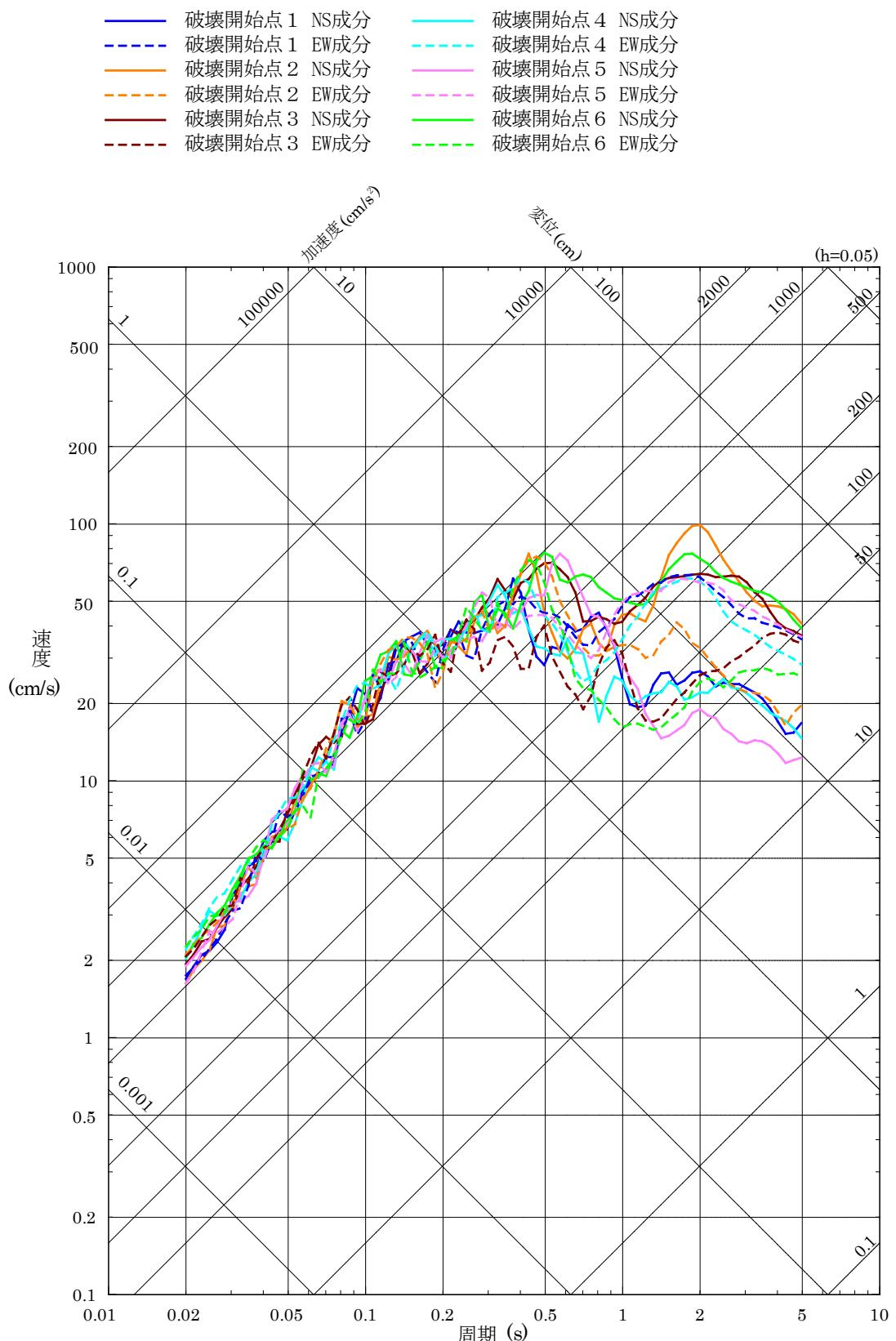
第 5.6-10 図(17) 「宍道断層による地震」の断層モデルを用いた手法による
