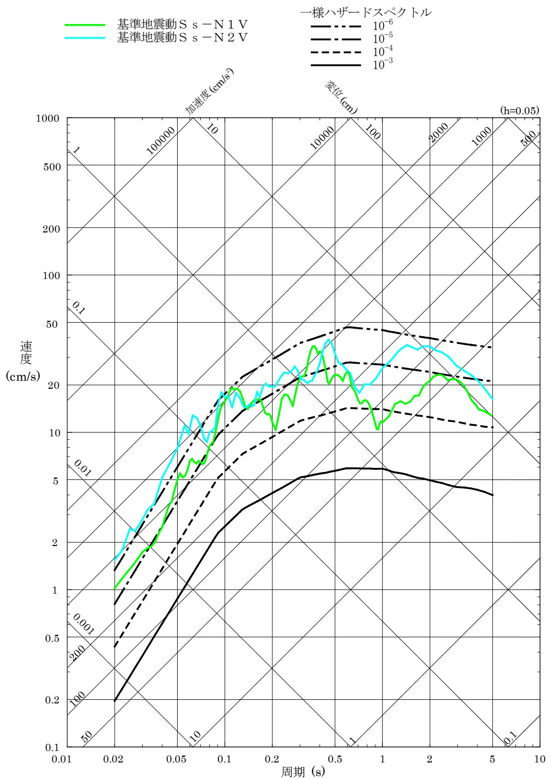
第 5.6-34 図(2) 基準地震動 Ss-N1 及び Ss-N2 の応答スペクトルと領域震源モデルによる一様ハザードスペクトルの比較（鉛直方向）
