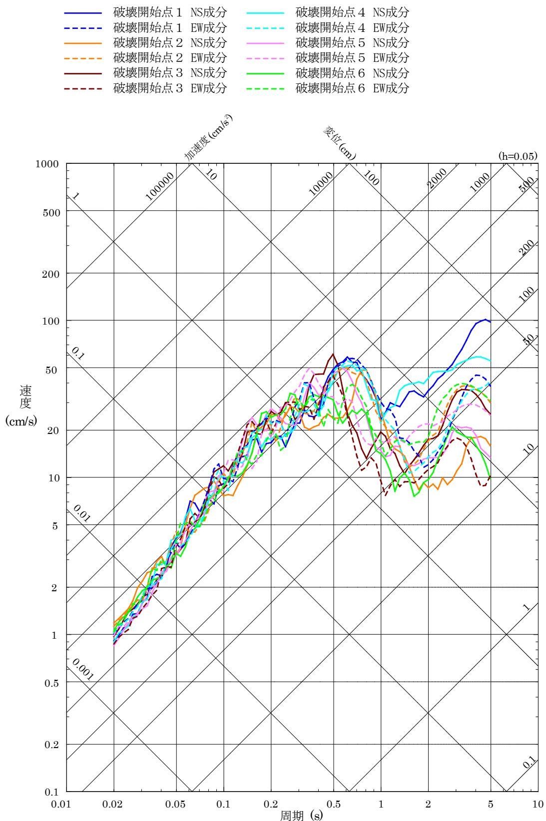
第 5.6-11 図(1) 「F - III断層 + F - IV断層 + F - V断層による地震」の断層モデルを用いた手法による地震動評価結果（水平方向）
