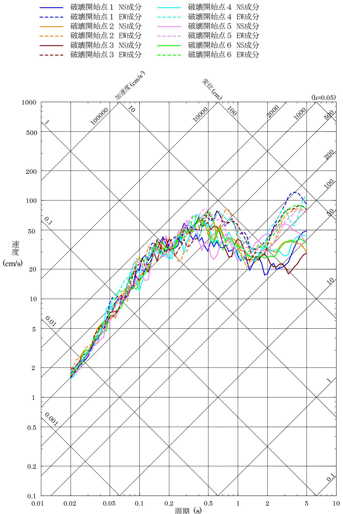
第 5.6-11 図(3) 「F - III断層 + F - IV断層 + F - V断層による地震」の断層モデルを用いた手法による地震動評価結果（水平方向）
