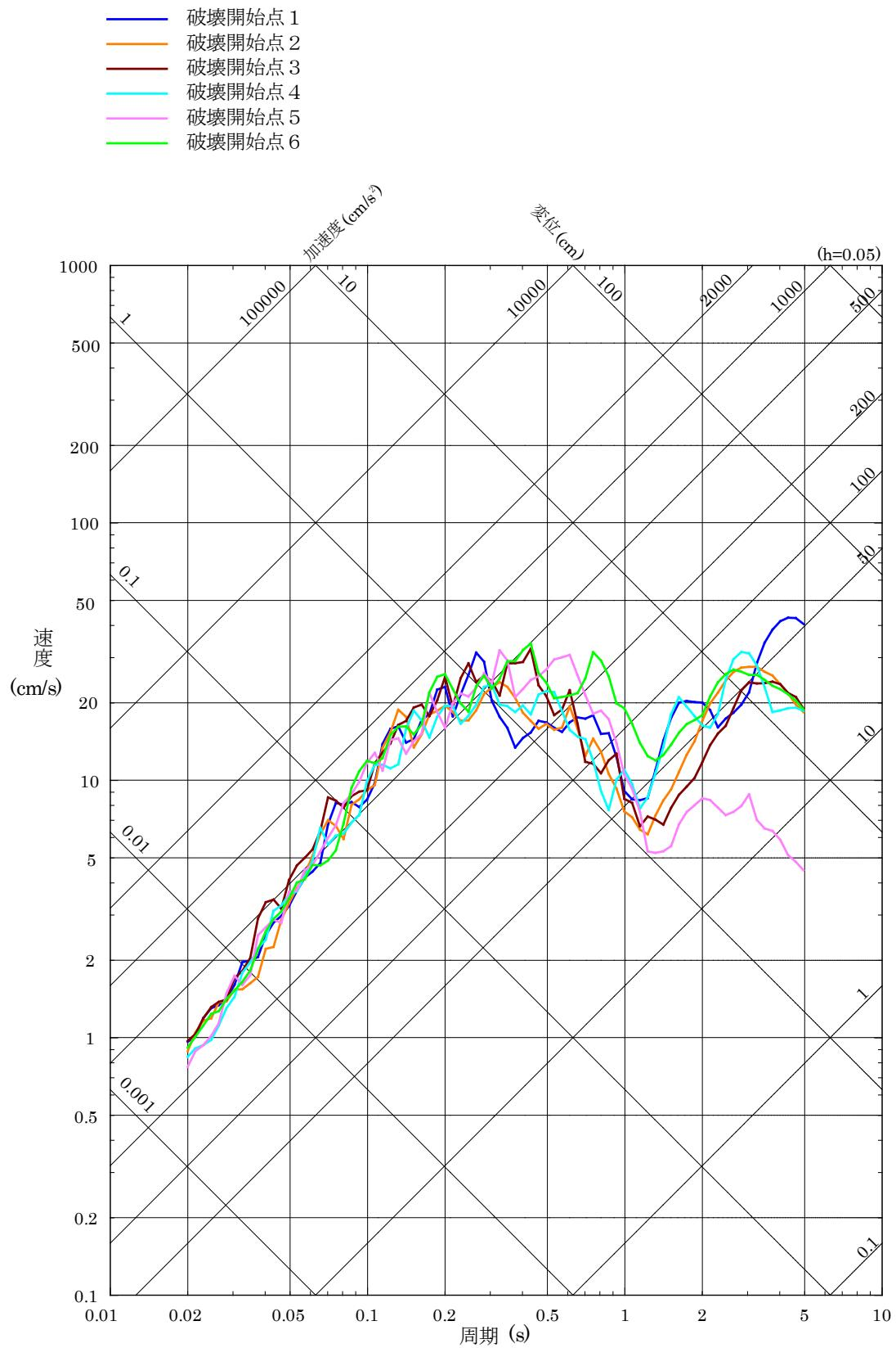
第 5.6-11 図(16)「F-III断層 + F-IV断層 + F-V断層による地震」の断層モデルを用いた手法による地震動評価結果（鉛直方向）
