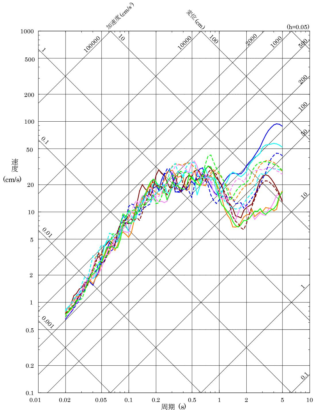
第 5.6-11 図(7) 「F-III断層 + F-IV断層 + F-V断層による地震」の断層モデルを用いた手法による地震動評価結果（水平方向）
