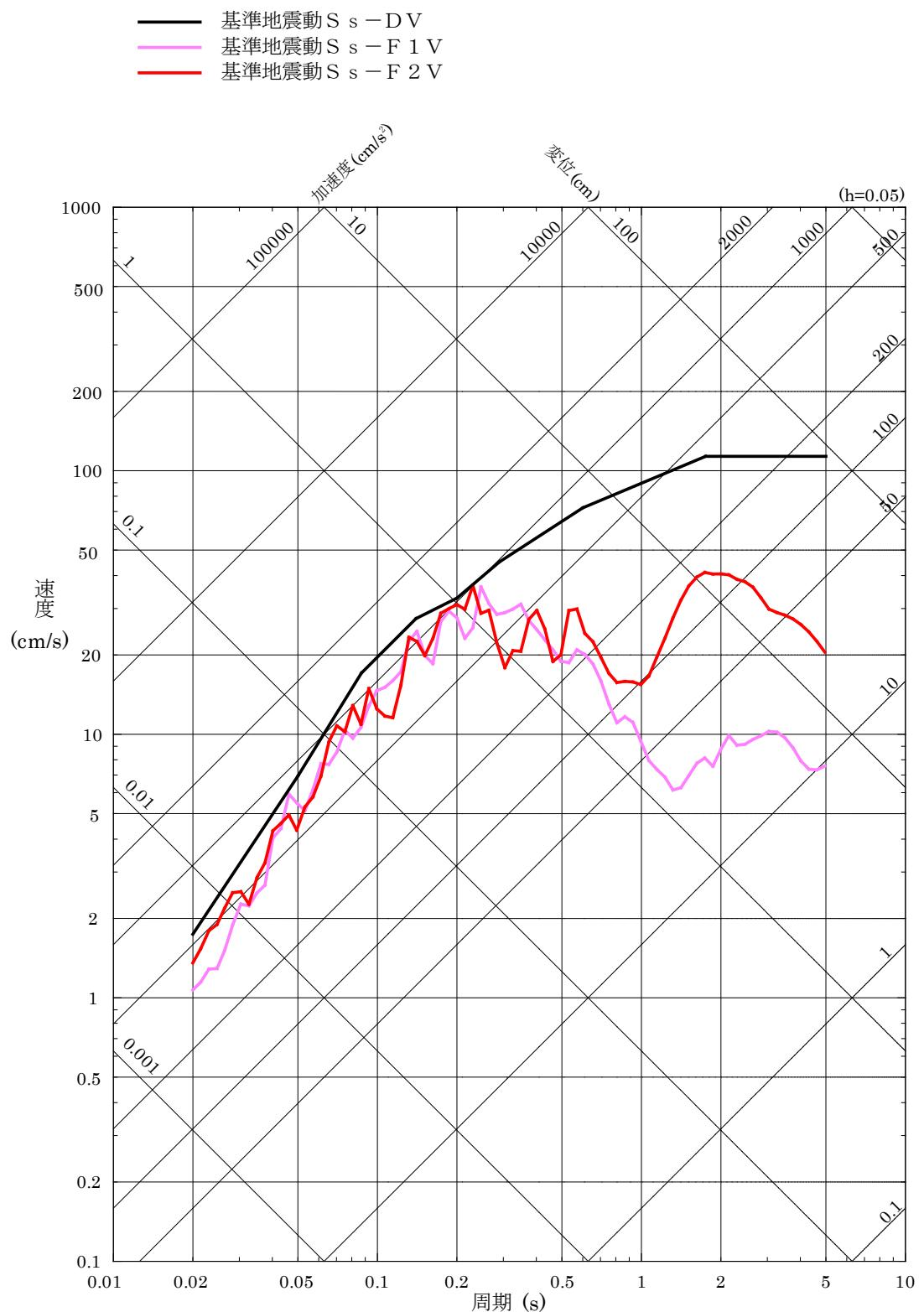
第 5.6-17 図(2) 「敷地ごとに震源を特定して策定する地震動」に基づく基準地震動 S s の応答スペクトル（鉛直方向）
