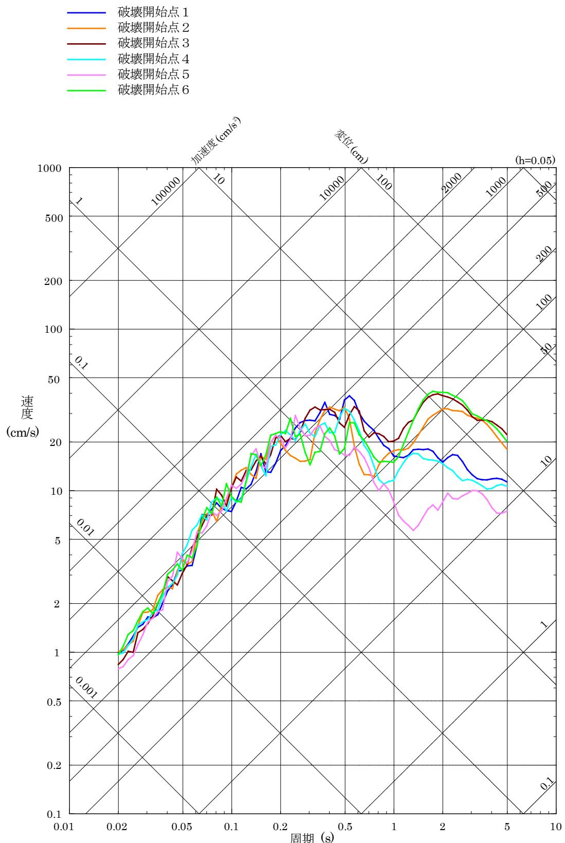
第 5.6-10 図(2) 「宍道断層による地震」の断層モデルを用いた手法による
