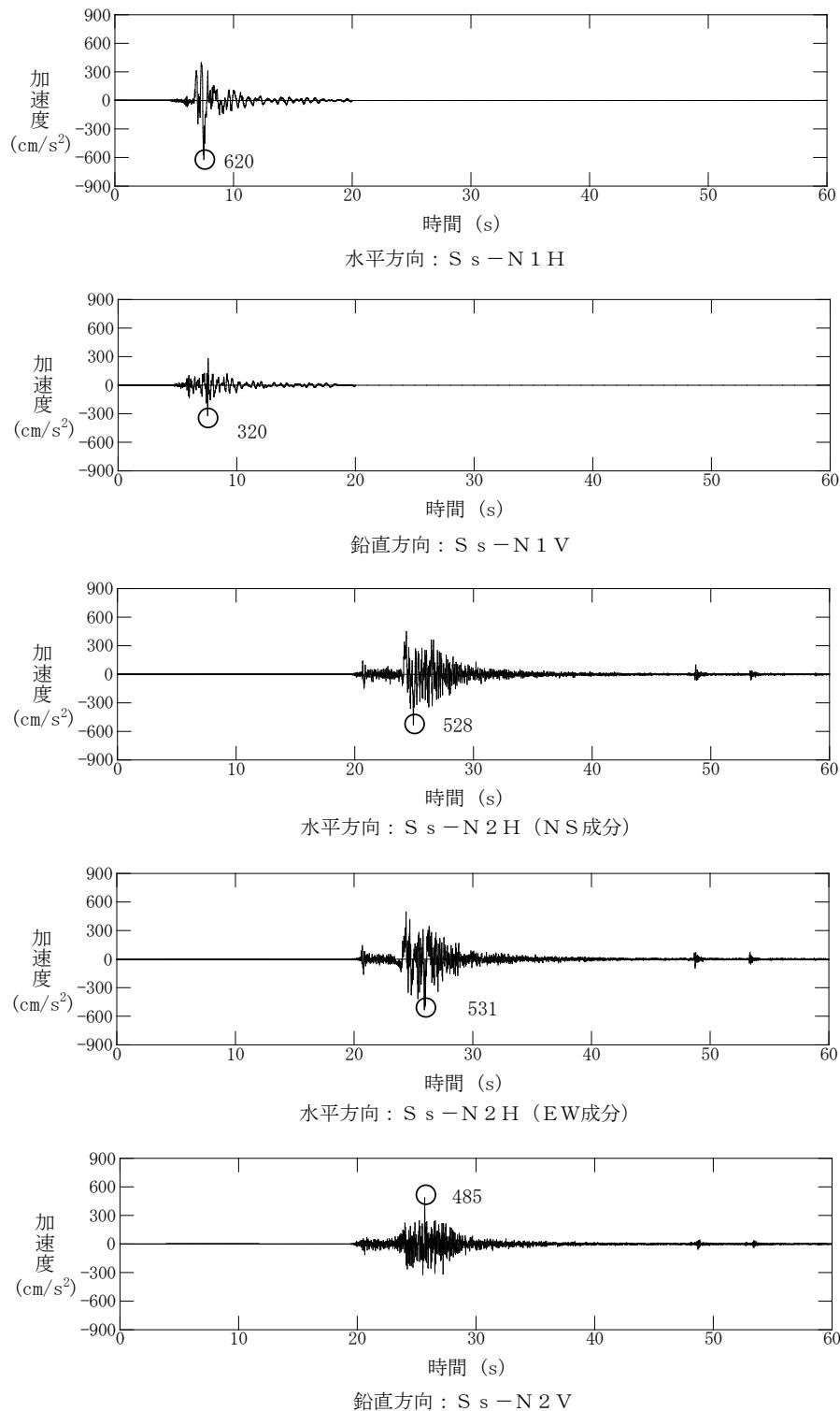
第 5.6-22 図 基準地震動 S s - N 1 及び S s - N 2 の時刻歴波形
