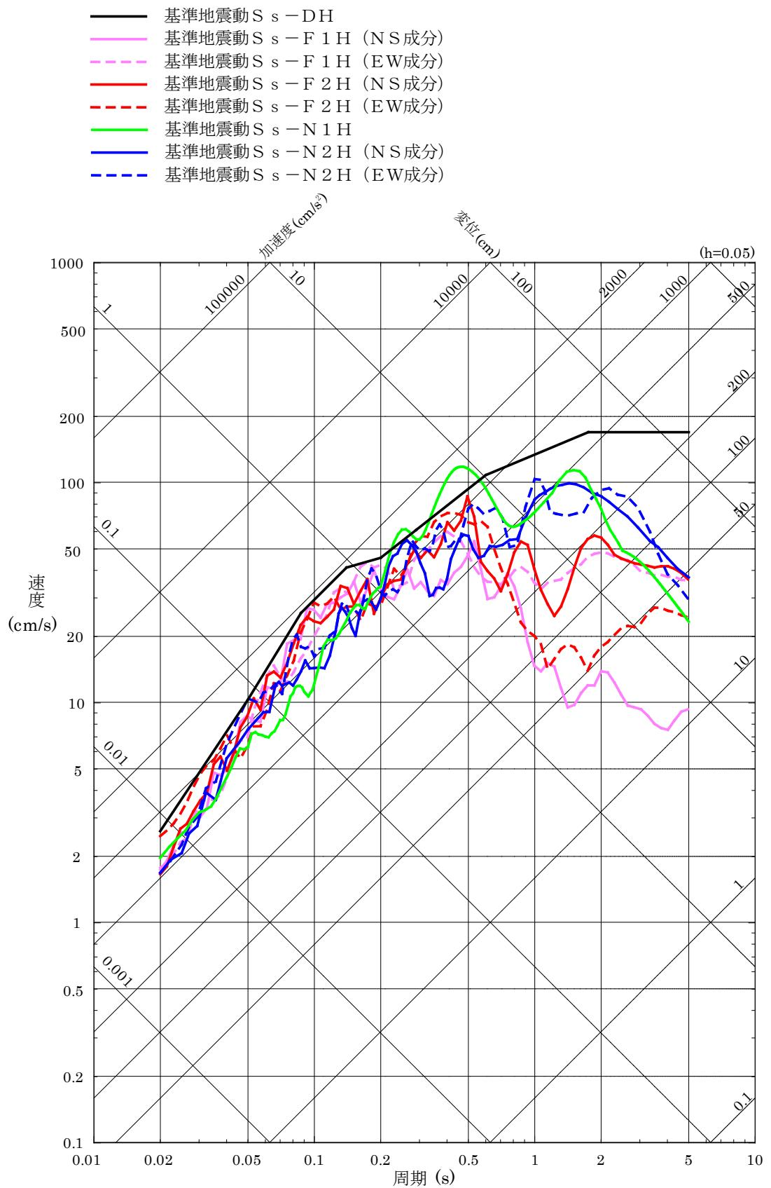
第 5.6-23 図(1) 基準地震動 S s の応答スペクトル (水平方向)
