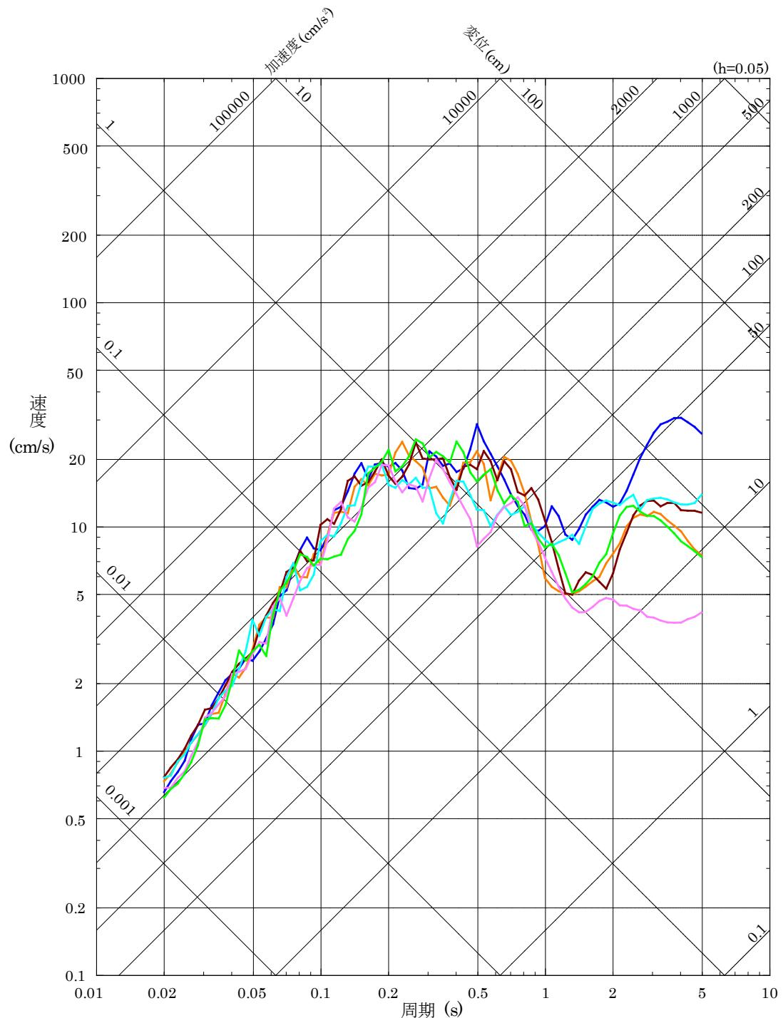
第 5.6-11 図(2) 「F - III断層 + F - IV断層 + F - V断層による地震」の断層モデルを用いた手法による地震動評価結果（鉛直方向）
