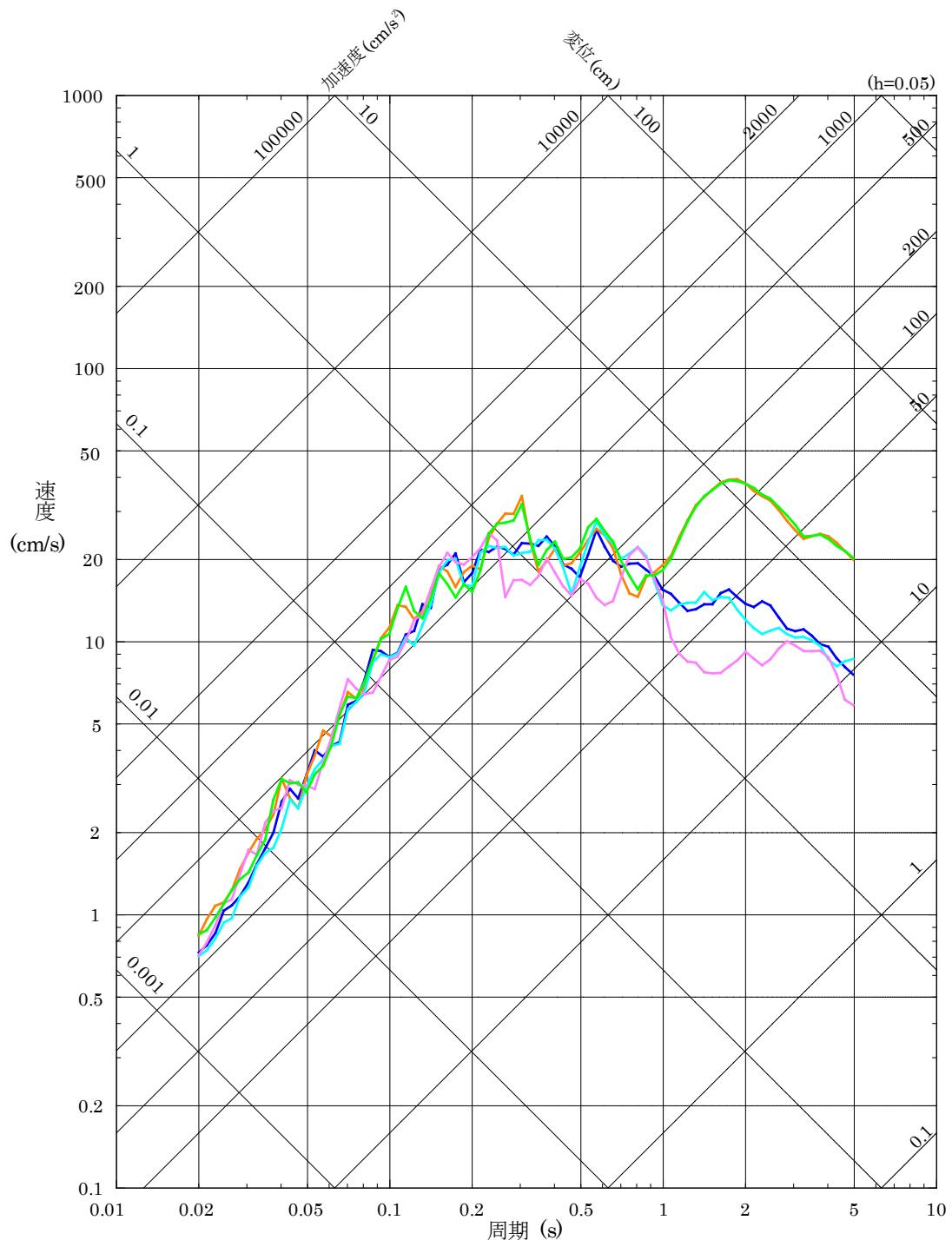
第 5.6-10 図(10) 「宍道断層による地震」の断層モデルを用いた手法による
