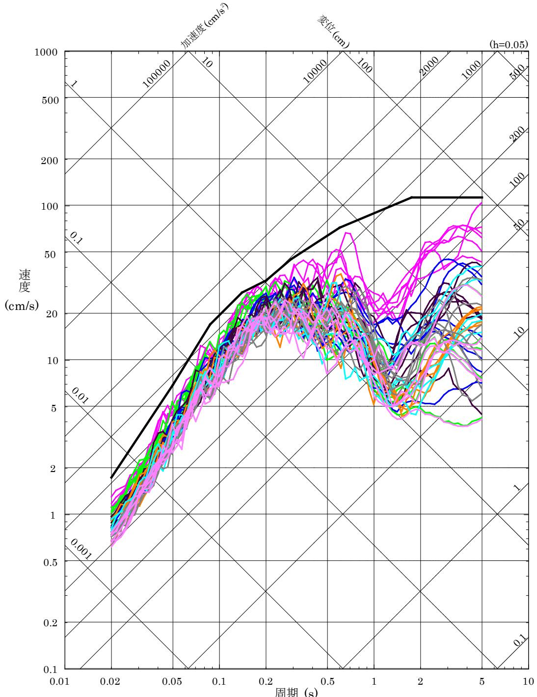
第 5.6-16 図(2) 基準地震動 S s – DV の設計用応答スペクトルと「F – III断層 + F – IV断層 + F – V断層による地震」の断層モデルを用いた手法による地震動評価結果の比較（鉛直方向）
