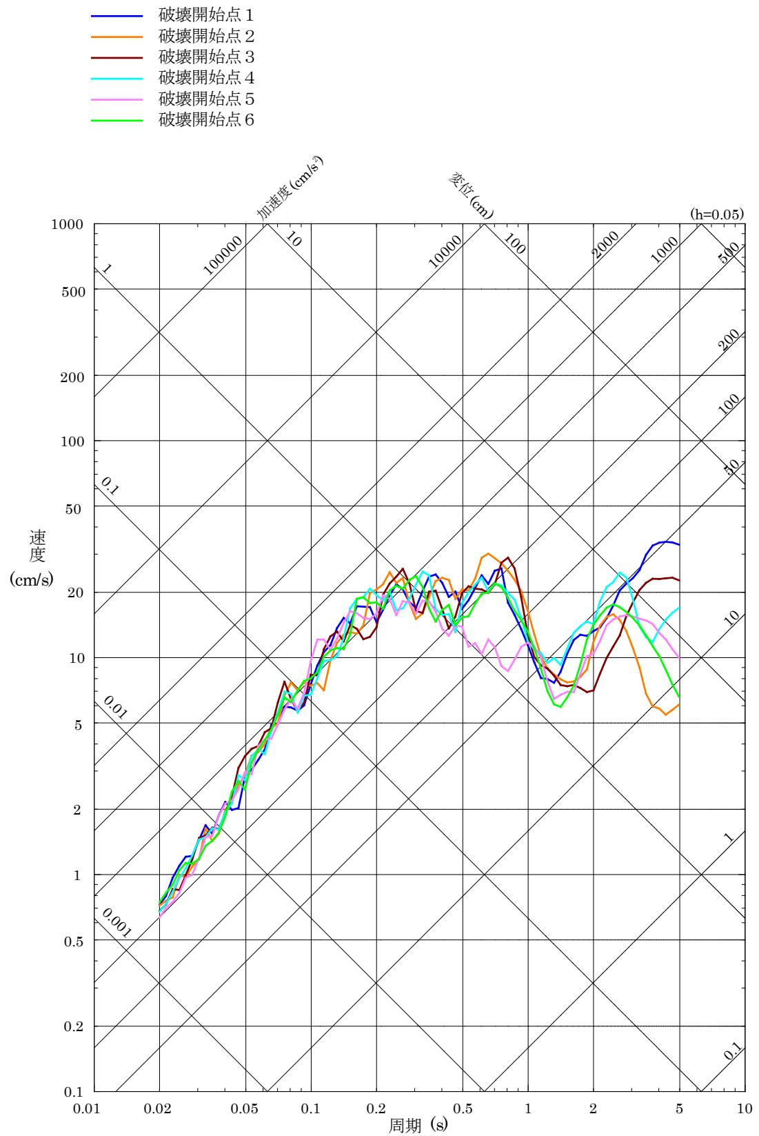
第 5.6-11 図(8) 「F - III断層 + F - IV断層 + F - V断層による地震」の断層モデルを用いた手法による地震動評価結果（鉛直方向）
