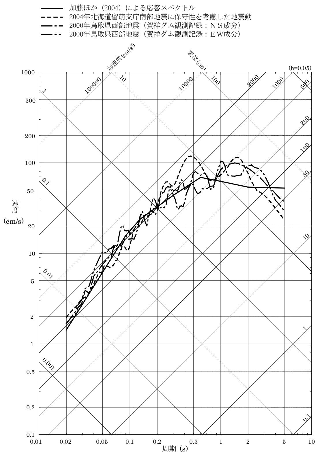
第 5.6-13 図(1) 「震源を特定せず策定する地震動」の応答スペクトル
