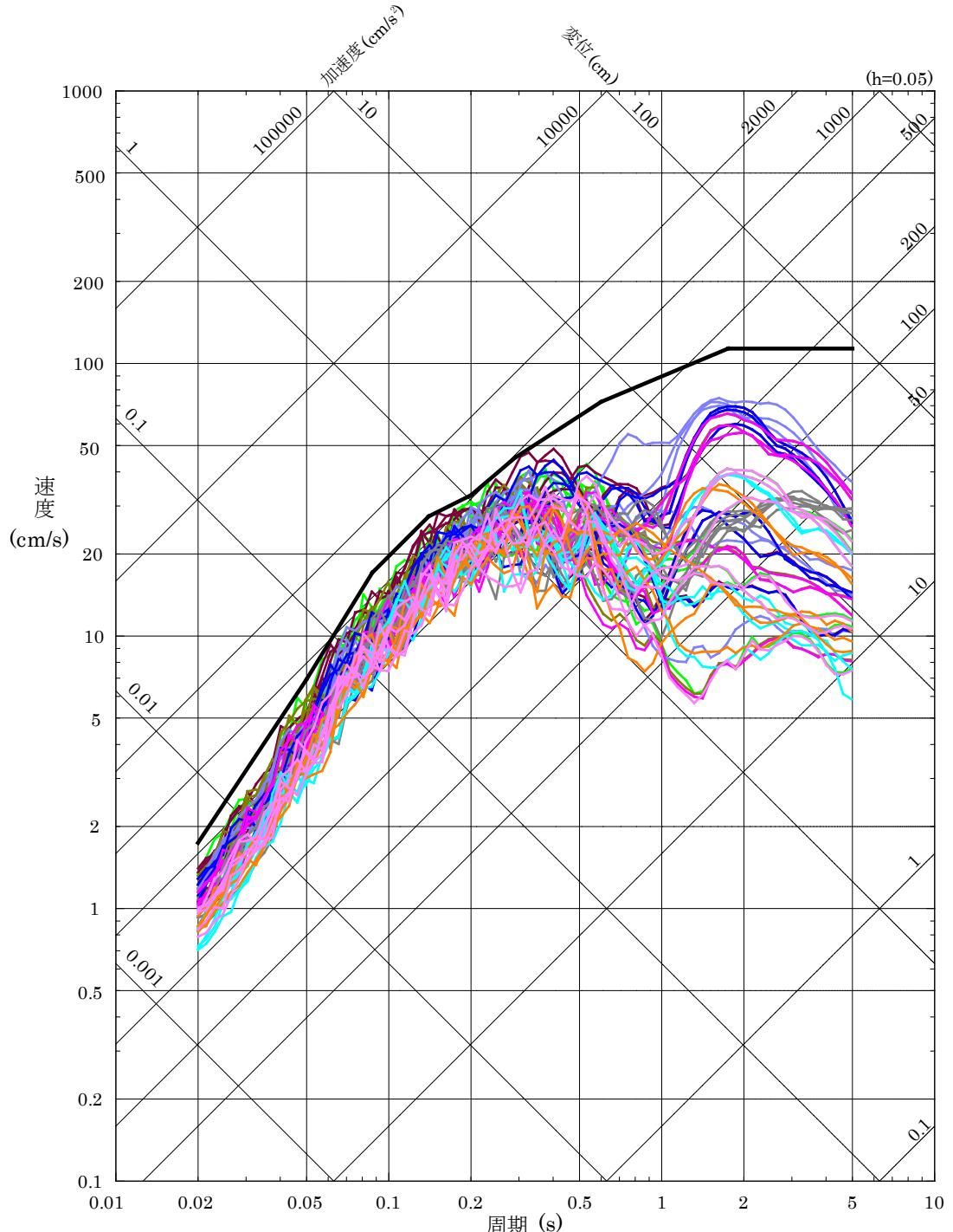
第 5.6-15 図(2) 基準地震動 S s - DV の設計用応答スペクトルと「宍道断層による地震」の断層モデルを用いた手法による地震動評価結果の比較（鉛直方向）
