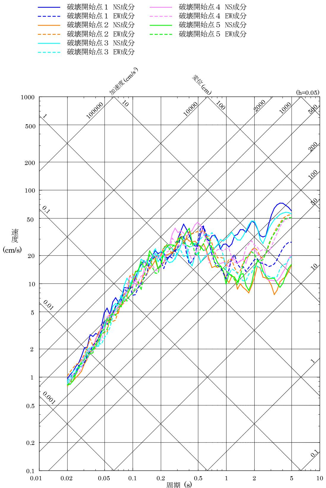
第 5.6-11 図(9) 「F - III断層 + F - IV断層 + F - V断層による地震」の断層モデルを用いた手法による地震動評価結果（水平方向）
