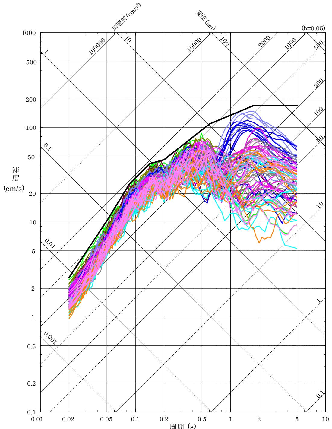
第 5.6-15 図(1) 基準地震動 S s - D H の設計用応答スペクトルと「宍道断層による地震」の断層モデルを用いた手法による地震動評価結果の比較 (水平方向)
