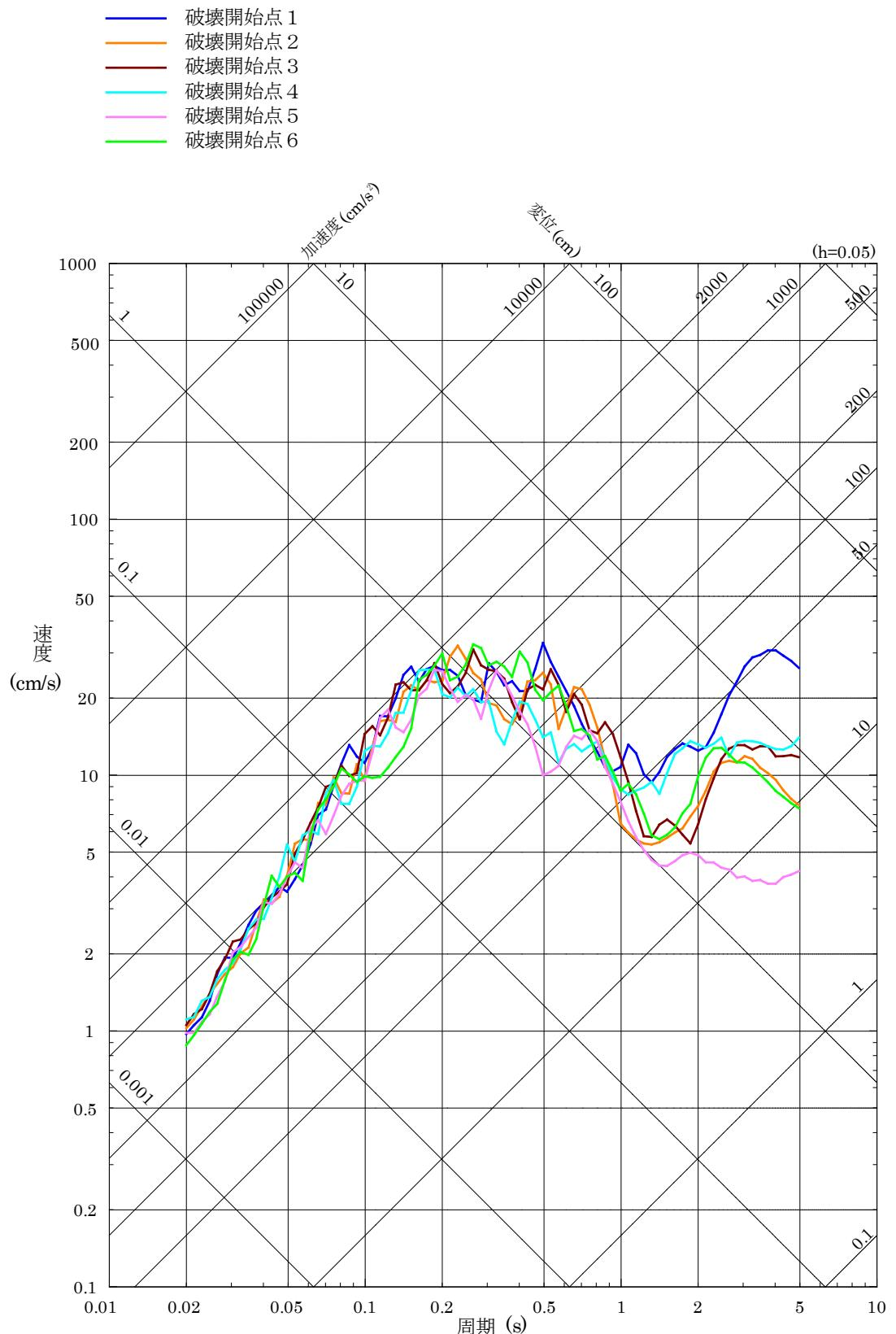
第 5.6-11 図(14)「F-III断層 + F-IV断層 + F-V断層による地震」の断層モデルを用いた手法による地震動評価結果（鉛直方向）
