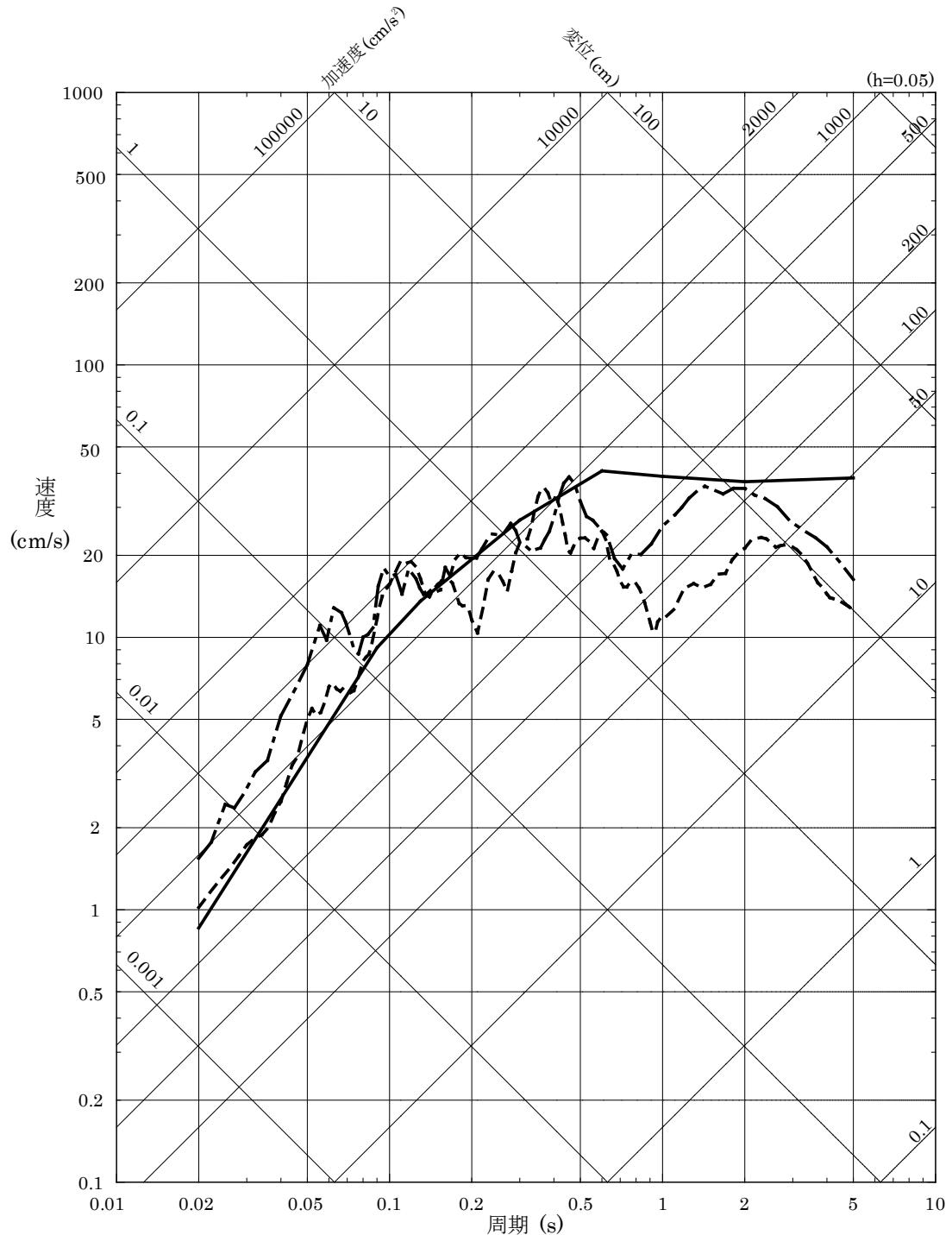
第 5.6-13 図(2) 「震源を特定せず策定する地震動」の応答スペクトル
