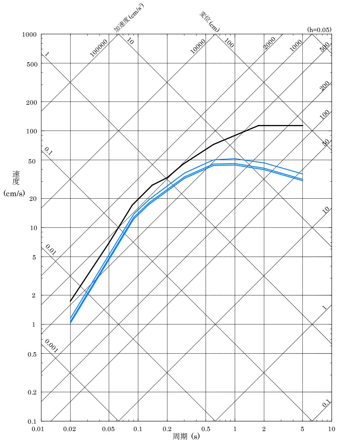
第5.6-14図(2) 基準地震動 S s - D Vの設計用応答スペクトルと応答スペクトルに基づく地震動評価結果の比較（鉛直方向）
