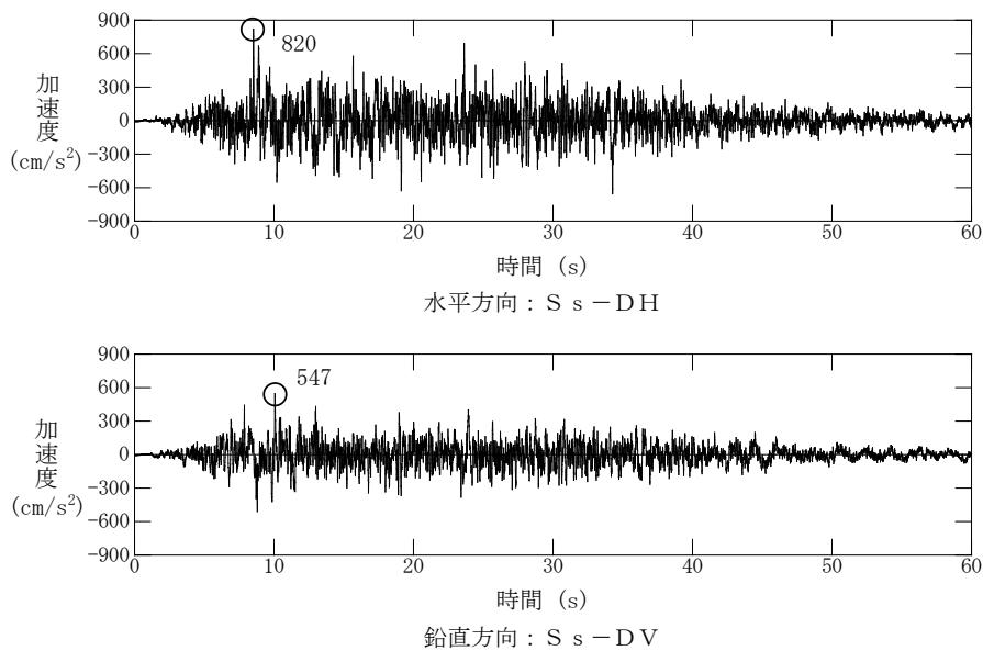
第 5.6-20 図 基準地震動 S s - D の時刻歴波形
