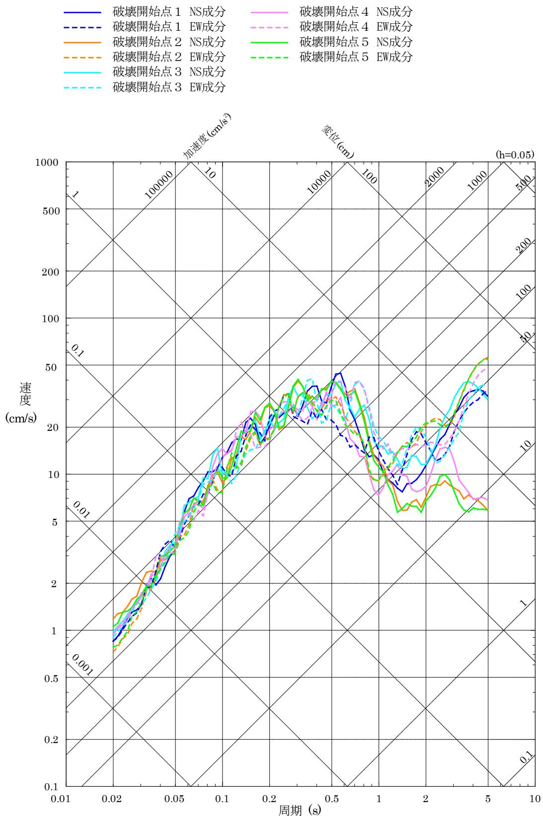
第 5.6-11 図(11)「F-III断層 + F-IV断層 + F-V断層による地震」の断層モデルを用いた手法による地震動評価結果（水平方向）
