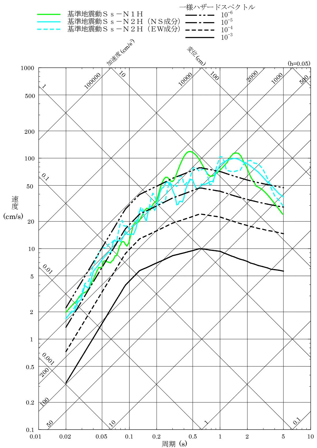
第 5.6-34 図(1) 基準地震動 Ss-N1 及び Ss-N2 の応答スペクトルと領域震源モデルによる一様ハザードスペクトルの比較（水平方向）
