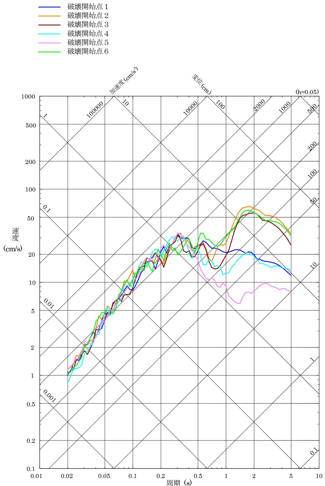
第 5.6-10 図(4) 「宍道断層による地震」の断層モデルを用いた手法による
