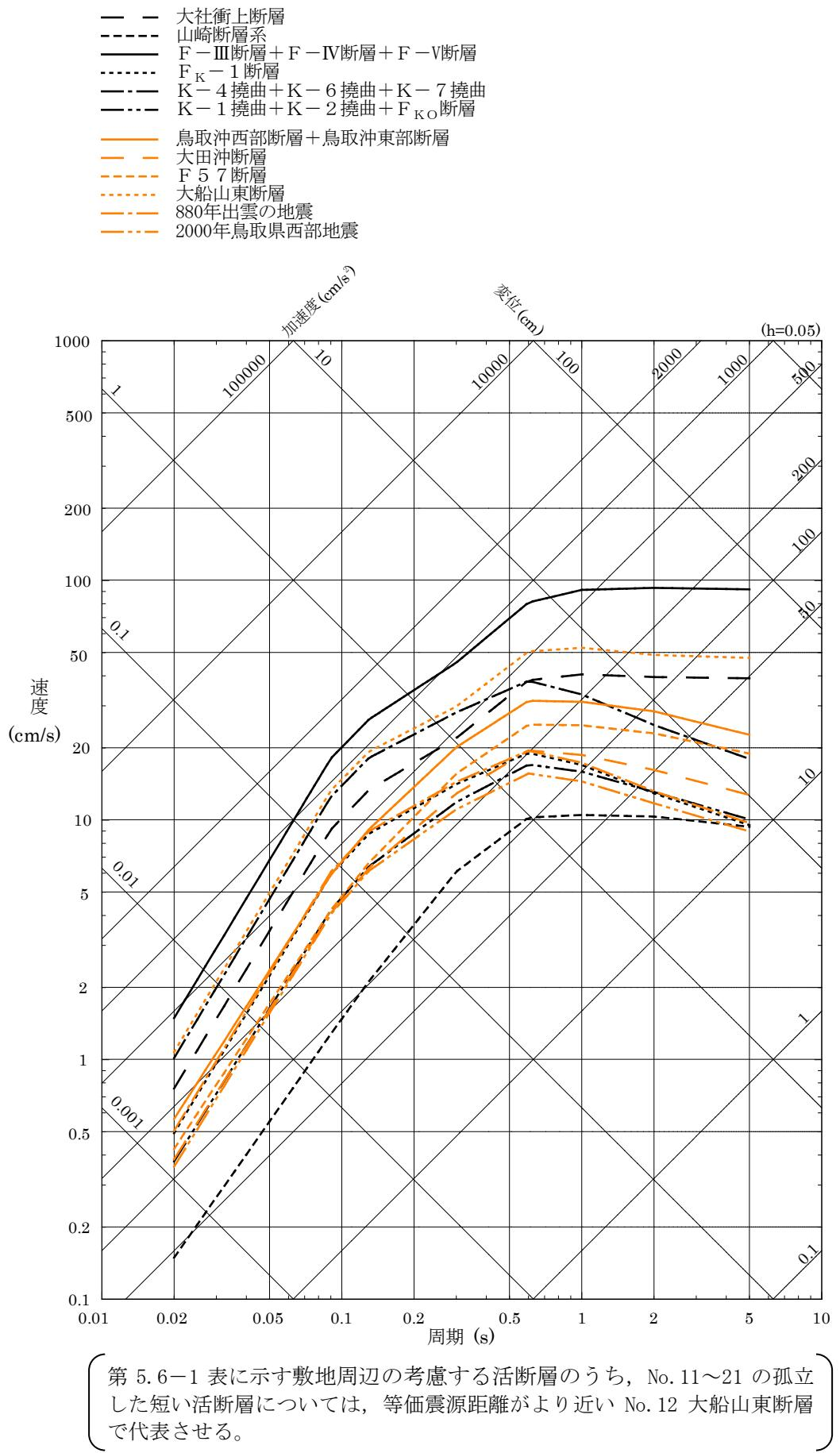
第 5.6-2 図 検討用地震選定のための応答スペクトルの比較
