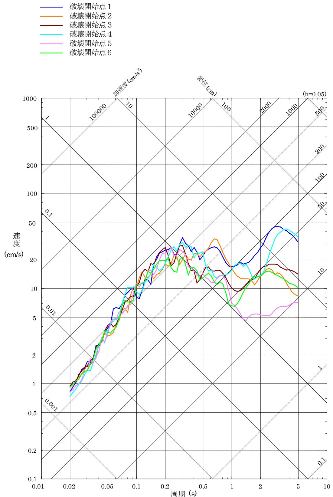
第 5.6-11 図(6) 「F - III断層 + F - IV断層 + F - V断層による地震」の断層モデルを用いた手法による地震動評価結果（鉛直方向）
