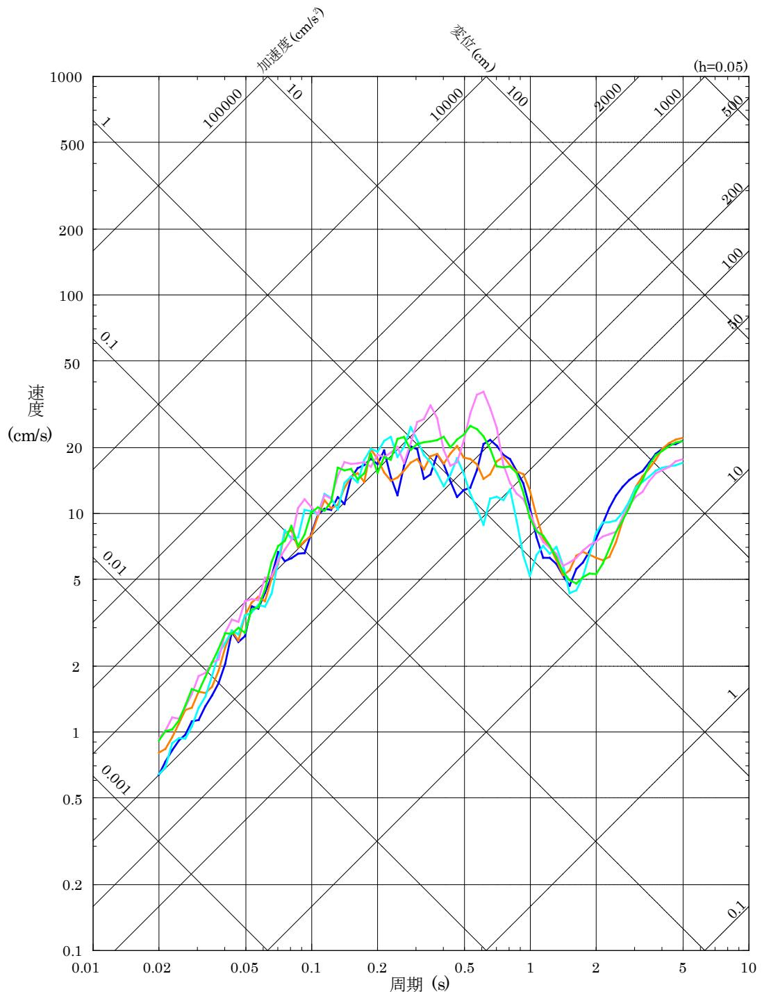
第 5.6-11 図(12) 「F-III断層 + F-IV断層 + F-V断層による地震」の断層モデルを用いた手法による地震動評価結果（鉛直方向）
