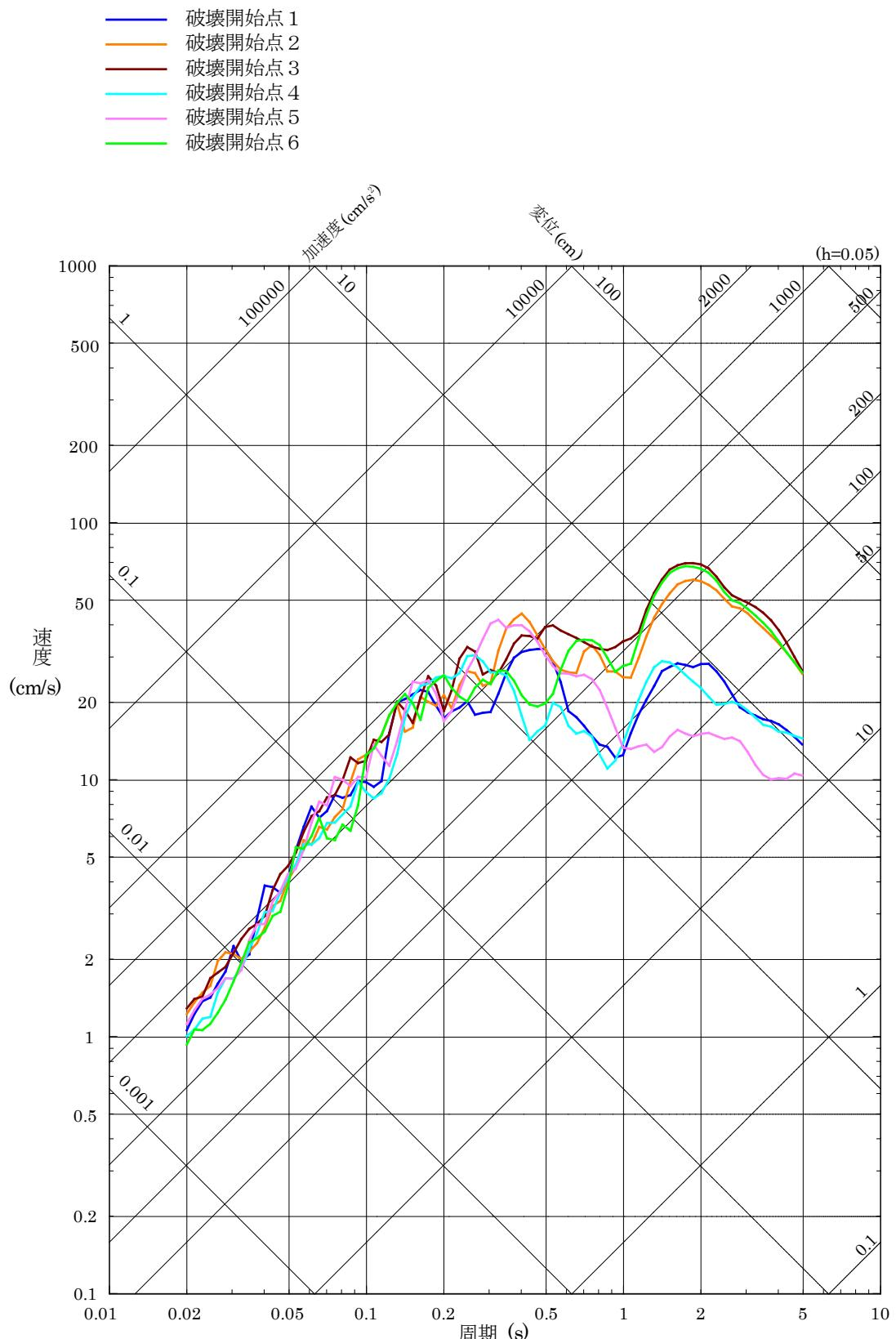
第 5.6-10 図(6) 「宍道断層による地震」の断層モデルを用いた手法による
