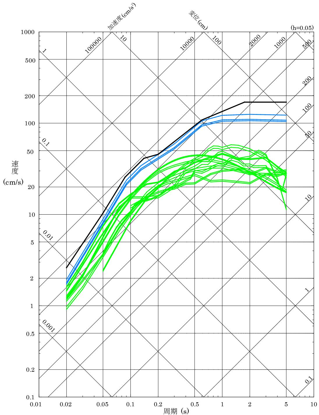
第 5.6-14 図(1) 基準地震動 S s - D H の設計用応答スペクトルと
