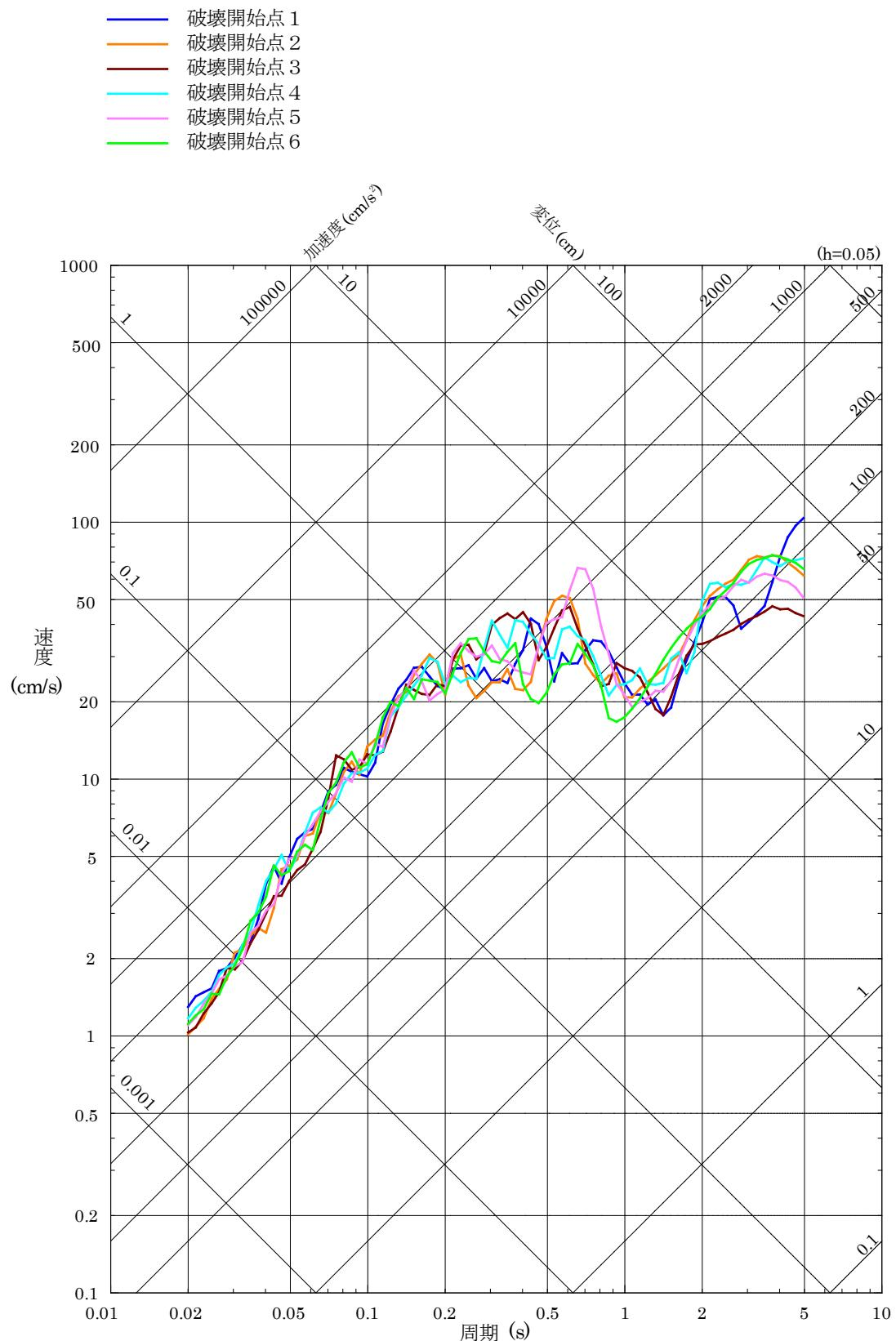
第 5.6-11 図(4) 「F - III断層 + F - IV断層 + F - V断層による地震」の断層モデルを用いた手法による地震動評価結果（鉛直方向）
