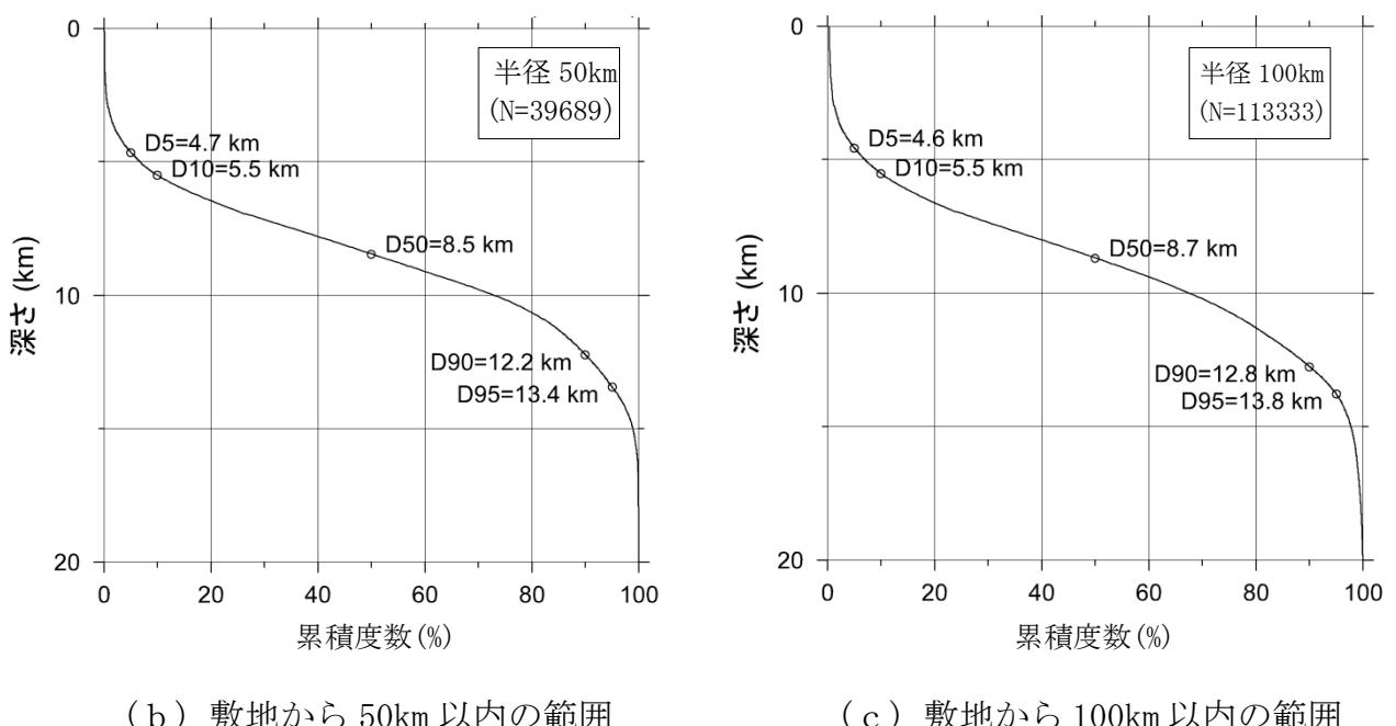
第 5.4-4 図 敷地周辺で発生した地震 ( $M < 3$ ) による D10 及び D90 の算定結果
