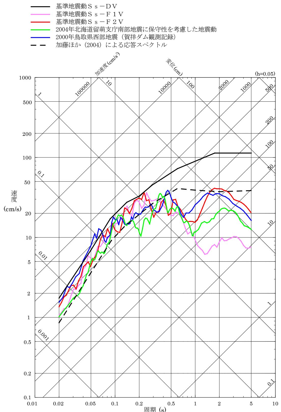
第 5.6-18 図(2) 「震源を特定せず策定する地震動」に基づく基準地震動 S s の応答スペクトル（鉛直方向）
