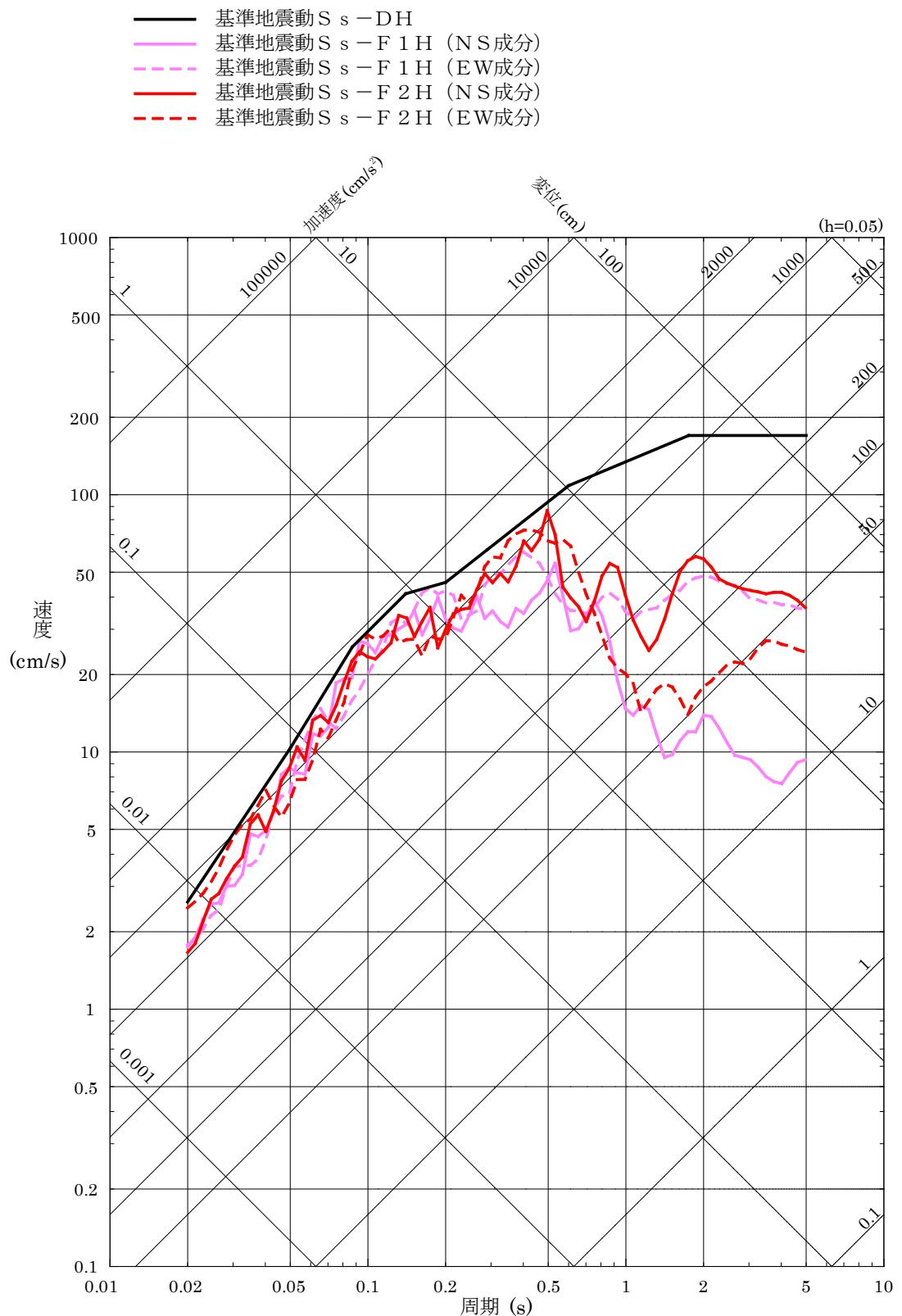
第 5.6-17 図(1) 「敷地ごとに震源を特定して策定する地震動」に基づく基準地震動 S s の応答スペクトル（水平方向）
