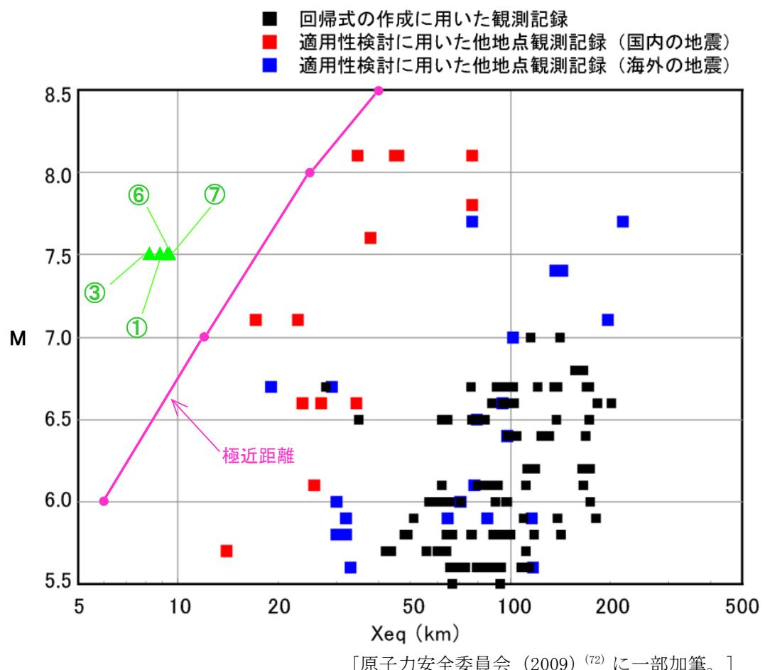
第 5.6-6 図 耐専式の策定に用いられた地震諸元と検討用地震の地震諸元の比較（「宍道断層による地震」）
