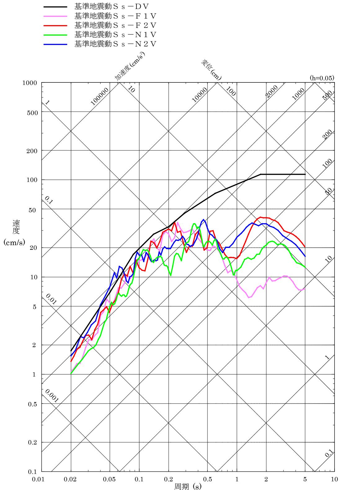
第 5.6-23 図(2) 基準地震動 S s の応答スペクトル (鉛直方向)
