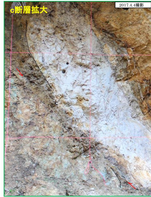
・c断層では逆断層変位を示唆する引きずり構造(解釈線:黒点線)が認められる。
