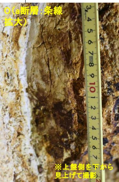
・断層aで認められる条線は最急勾配方向(折尺に平行な方向, T: S1W P: 59°)を示す。
