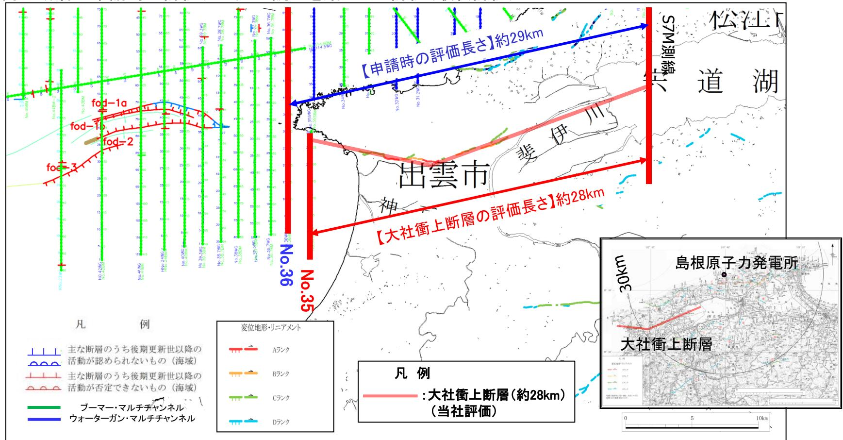
大社衝上断層は、活断層であるとする文献はないが、変位地形・リニアメントが判読されること、上部更新統が欠如し活動性が明確に判断できないこと等を踏まえ、震源として考慮する活断層として考慮し、その端部は海域及び宍道湖で実施した音波探査結果により評価している。
