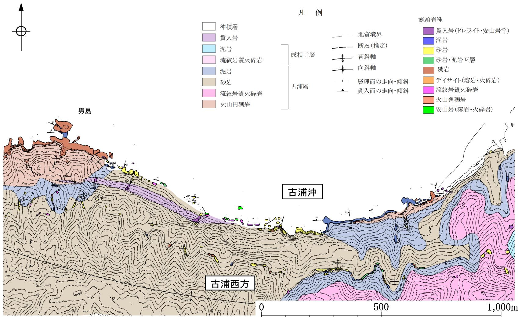
・地表地質踏査の結果、古浦西方の海岸部では古浦層の礫岩、泥岩及び砂岩が連続分布しており、断層は認められない。
