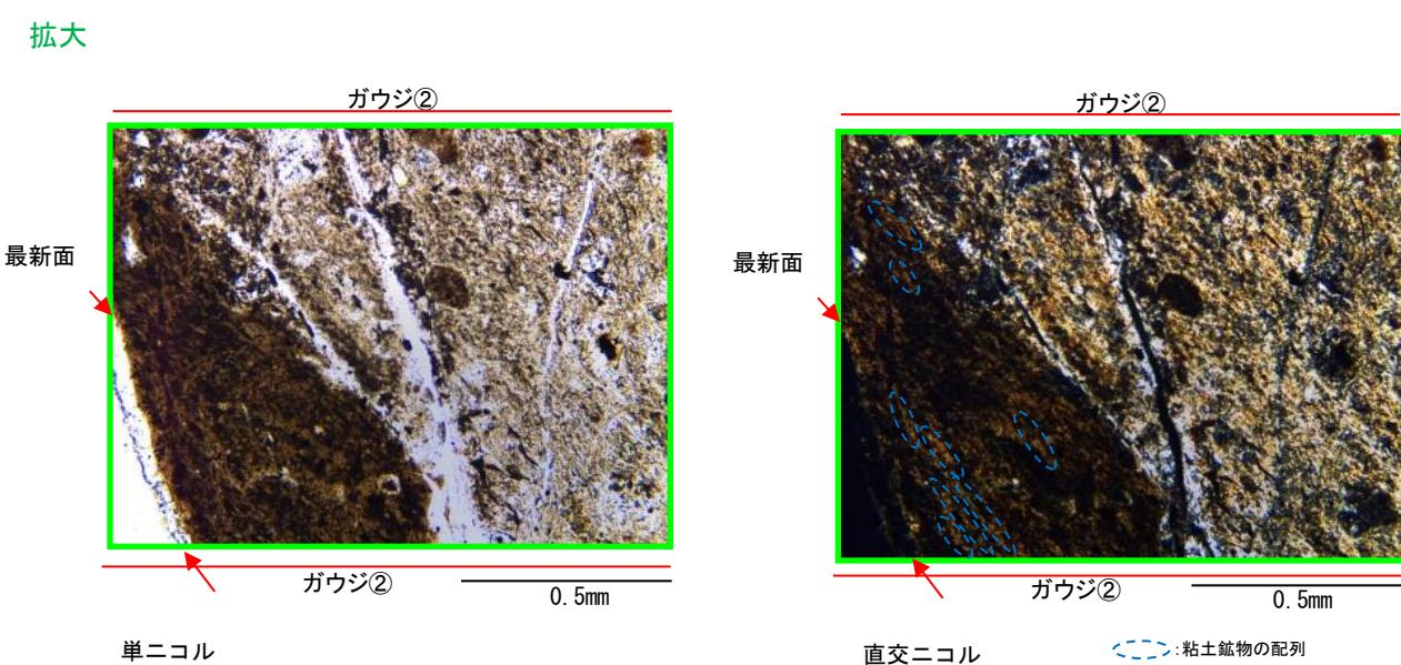
・薄片観察の結果、最新面付近では、粘土鉱物の長軸は最新面に沿った方向に配列している（特徴⑤）。
