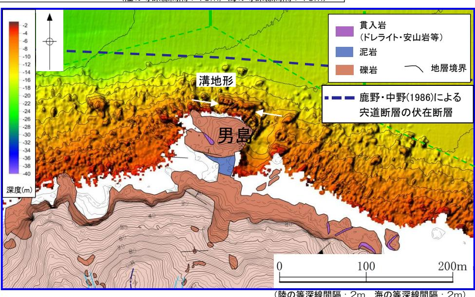
・海底面調査の結果、男島付近の溝地形を除き、海底地形面には東西方向へ連続する構造は認められない。
