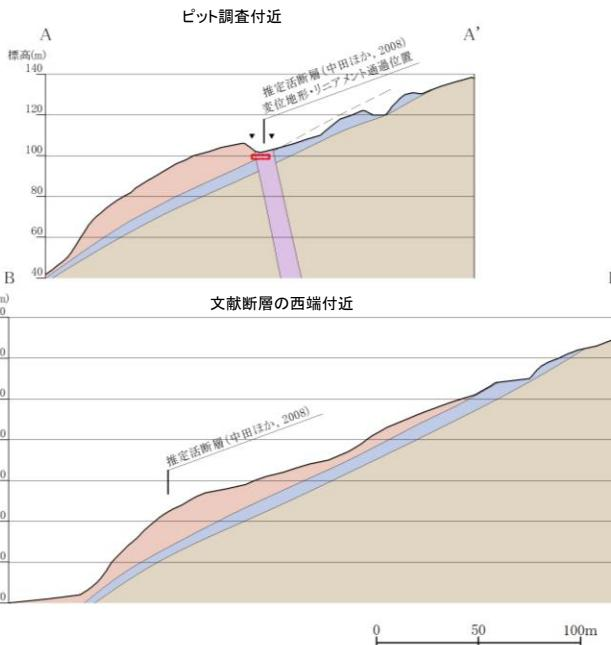
変位地形・リニアメント及び文献断層通過位置において、古浦層の砂岩、泥岩及び火山円礫岩が全体的に緩やかに北に傾斜しており、断層を示唆する構造は認められない。
