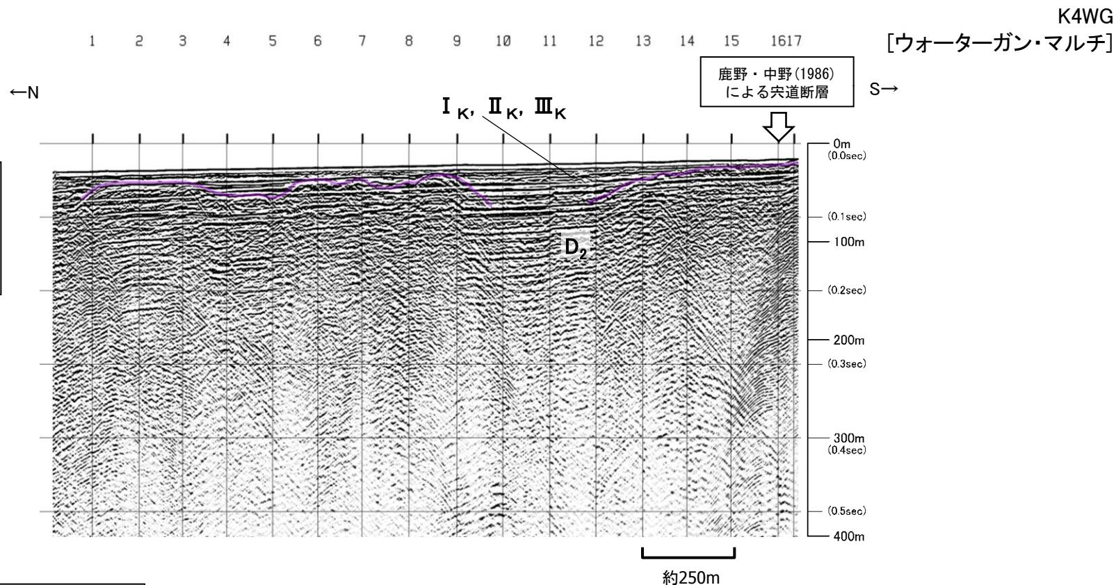
男島付近の溝地形、女島付近の海底地形の高まりの延長部を含む沿岸付近において、音波探査により断層の存否を確認した。
