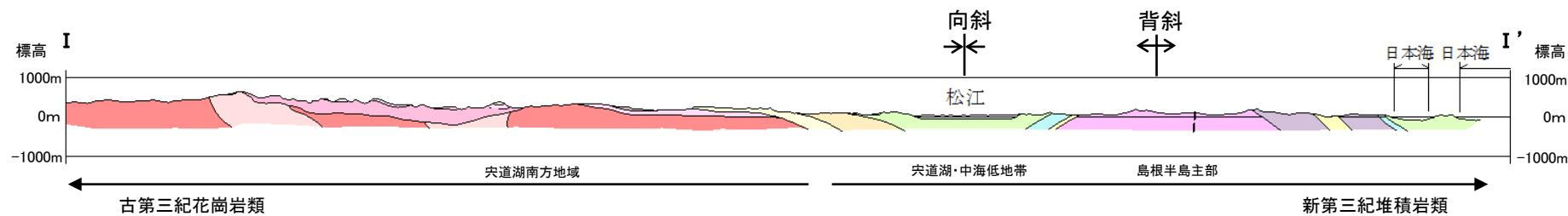
・島根半島主部及び大社山塊には、新第三系中新統が分布し、東西ないし東北東－西南西方向に軸を持つ褶曲構造が認められる。大局的にみると、島根半島主部及び大社山塊ではそれぞれ背斜をなし、宍道湖・中海低地帯では向斜をなす。これらの大構造としての背斜及び向斜は、更に多くの小規模な背斜及び向斜の複合から成り、この島根半島の新第三系の褶曲帶は、宍道褶曲帶(多井(1973)等)と呼ばれている。鹿野ほか(1994)等によると、中期中新世頃から後期中新世頃まで主応力( $\sigma_{Hmax}$ )の方向はNS方向であり、宍道褶曲帶(東西ないし東北東－西南西方向の軸を有する褶曲構造と同方向の逆断層)が形成されたとしている。
