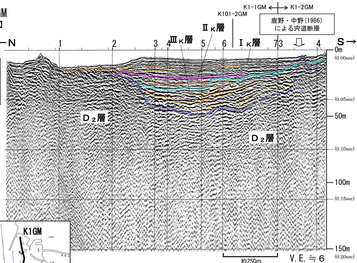
・鹿野・中野(1986)に示される宍道断層の位置付近において、D<sub>2</sub>層上面の高まりが認められるが、III $\kappa$ 層の内部反射面及びD<sub>2</sub>層上面に断層活動を示唆する反射面は確認されない。
