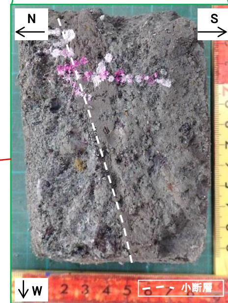
・露頭で確認されたゆるく湾曲し連続性に乏しい性状を示す小断層から試料を採取し、CT画像解析及び実体顕微鏡による条線観察を実施した。
