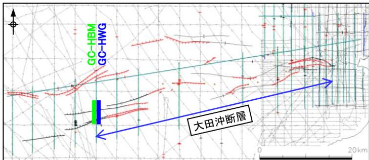
・大田沖断層の西端はfod-8断層及びfod-9断層に相当する。
