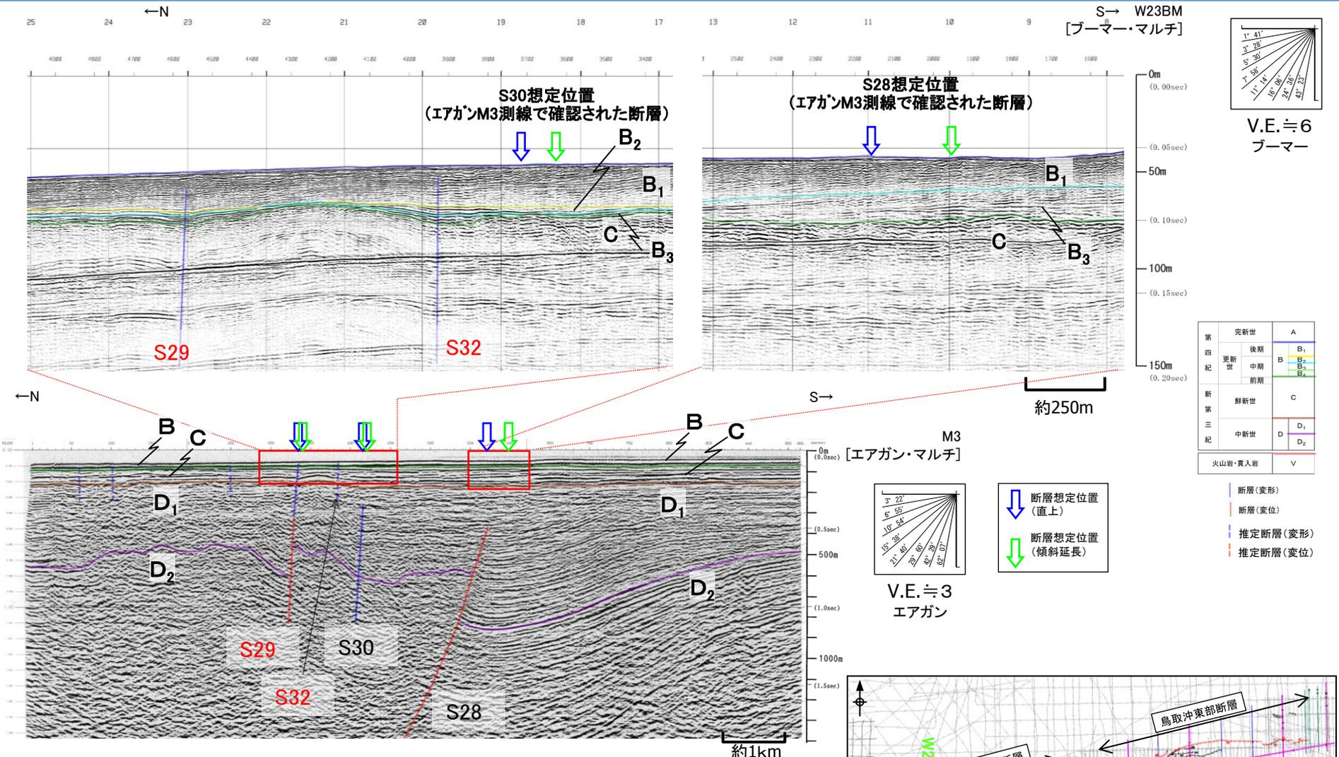
・S28断層は主にD<sub>2</sub>層の高まりの南縁を限っていることから、鳥取沖西部断層の主断層と考えられる。これに対し、そのほかの断層はD<sub>2</sub>層の高まりの中に位置していることから、副次的な断層と考えられる。
