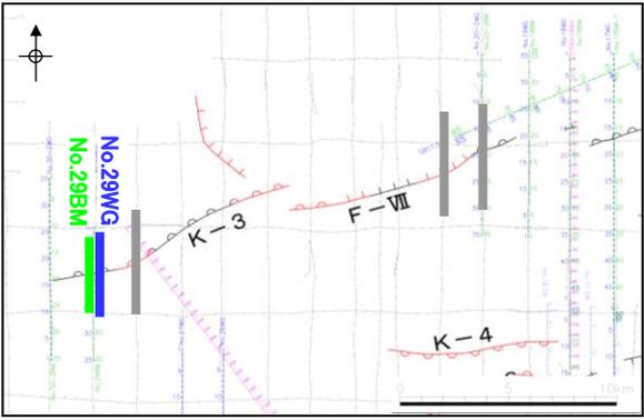
・F<sub>K</sub>-1断層の西端にあたるK-3撓曲は、B<sub>3w</sub>層までに変形が認められるが、B<sub>2w</sub>層以上に断層活動を示唆する変位や変形は認められない。
