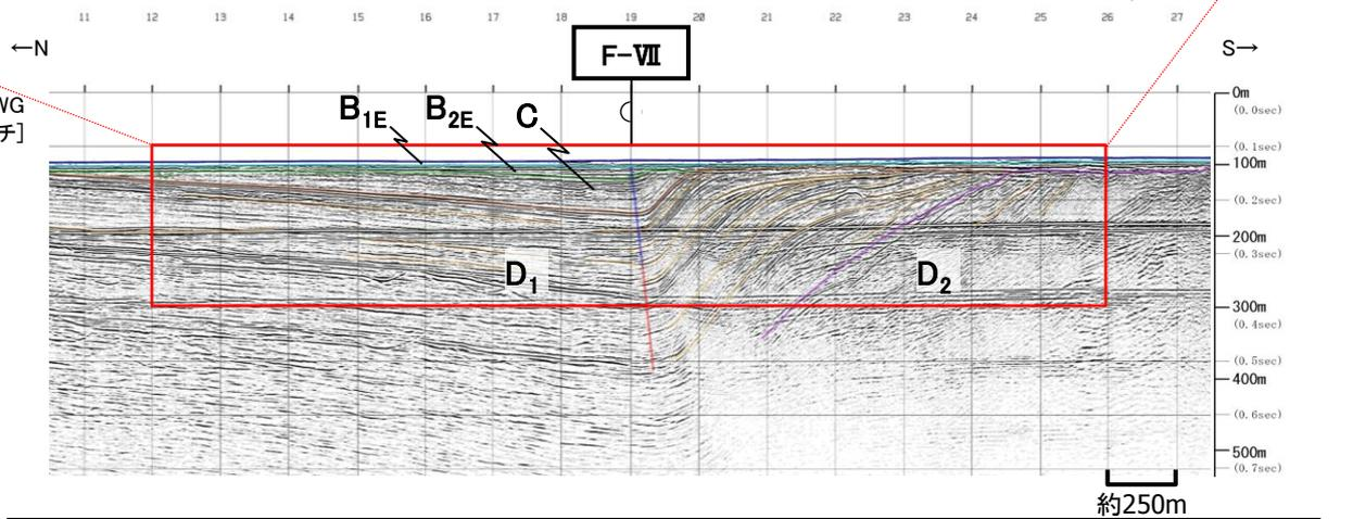
・F<sub>K</sub>-1断層の東端にあたるF-VII断層は、C層までに変形が認められるが、B<sub>1E</sub>層以上に断層活動を示唆する変位や変形は認められない。
