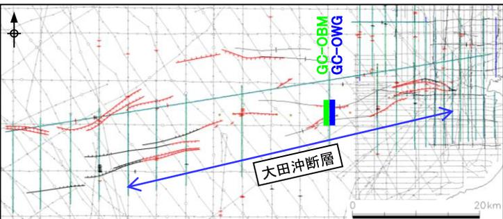
・大田沖断層の中央部には、fod-4断層及びfod-5断層が分布する。
