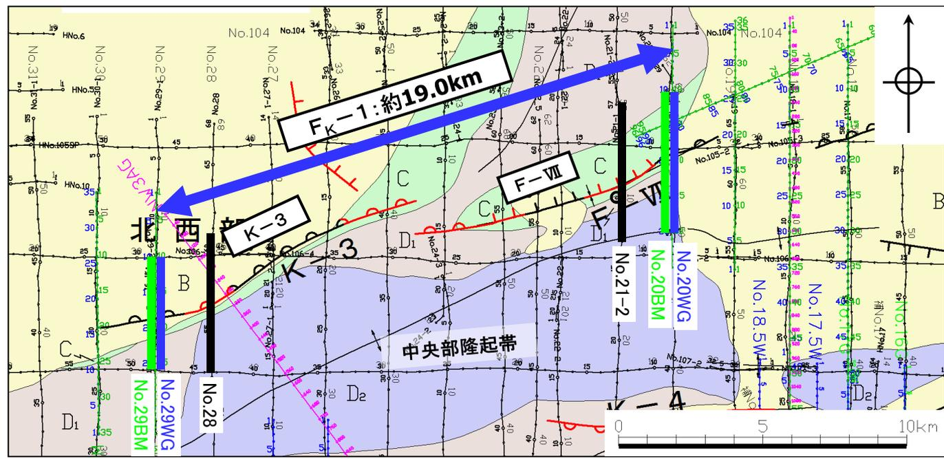
地質図に記載された断層線の端点は断層が確認される測線と確認されない測線との中点までを表示している。
