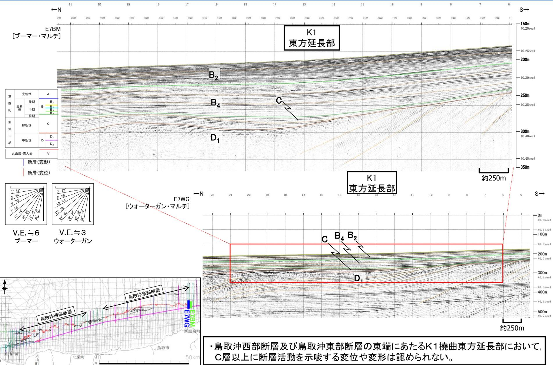
・鳥取沖西部断層及び鳥取沖東部断層の東端にあたるK1撓曲東方延長部において、C層以上に断層活動を示唆する変位や変形は認められない。
