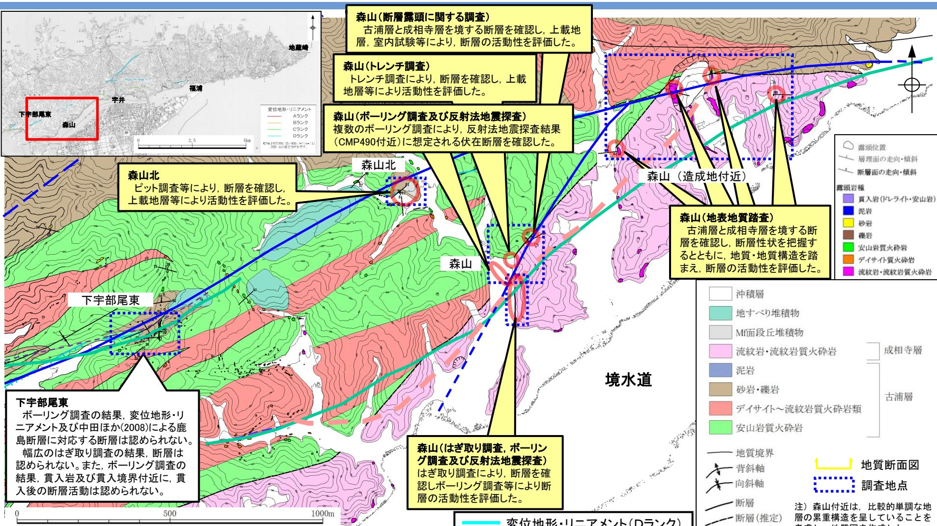
・変位地形・リニアメント及び文献断層の通過位置付近において、はぎ取り調査、ボーリング調査、ピット調査、トレンチ調査、反射法地震探査等の詳細な調査を実施し、後期更新世以降の断層活動の有無を確認した。
