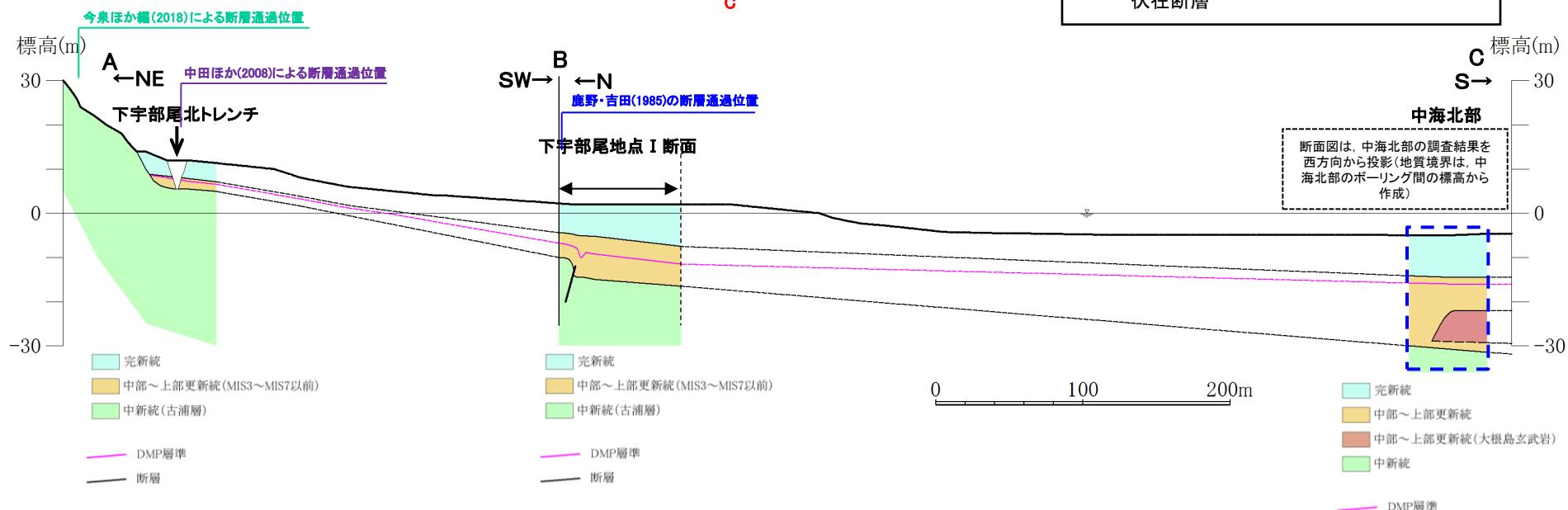
・下宇部尾北トレンチからほぼ谷筋に沿って下宇部尾平野部から中海北岸に至る地質断面図では、沖積層やDMP層準は谷の傾斜と調和的な高度分布を示しており、断層活動を示唆する変位や変形は認められない。
