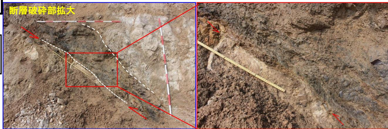
・破碎幅は最大で70cm程度で、一部、風化は進んでいるが固結・密着している。
