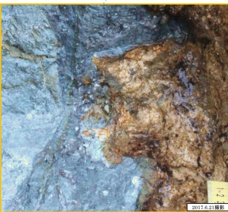
c断層 凹凸部 接写写真
