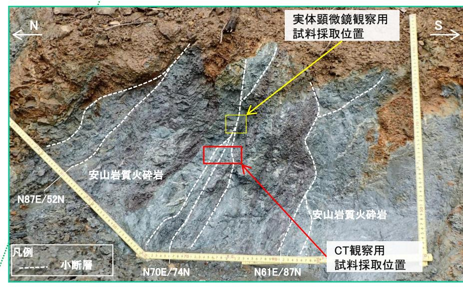
・粘土を伴い、ゆるく湾曲し連続性に乏しい性状を示す小断層が見られる箇所(热水変質部(中央))で試料採取を行い、CT画像撮影、実体顕微鏡観察及びX線回折分析等を実施した。
