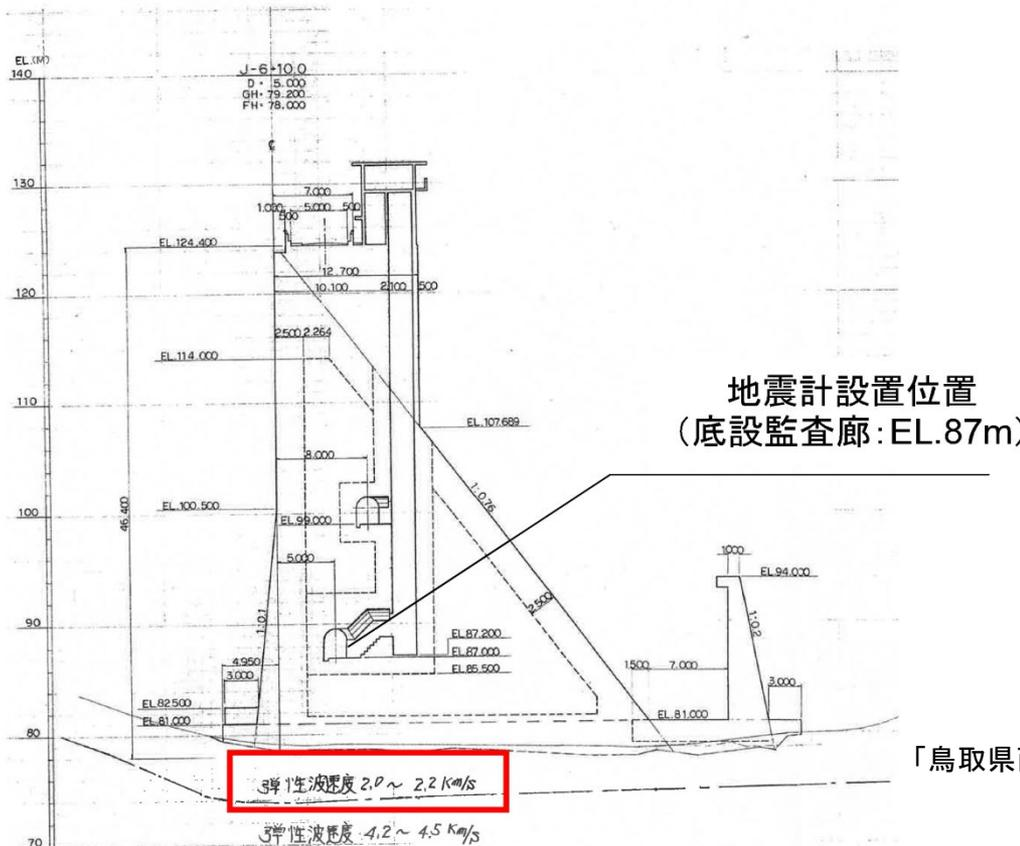
ダム堤体底部はCM級岩盤に設置
