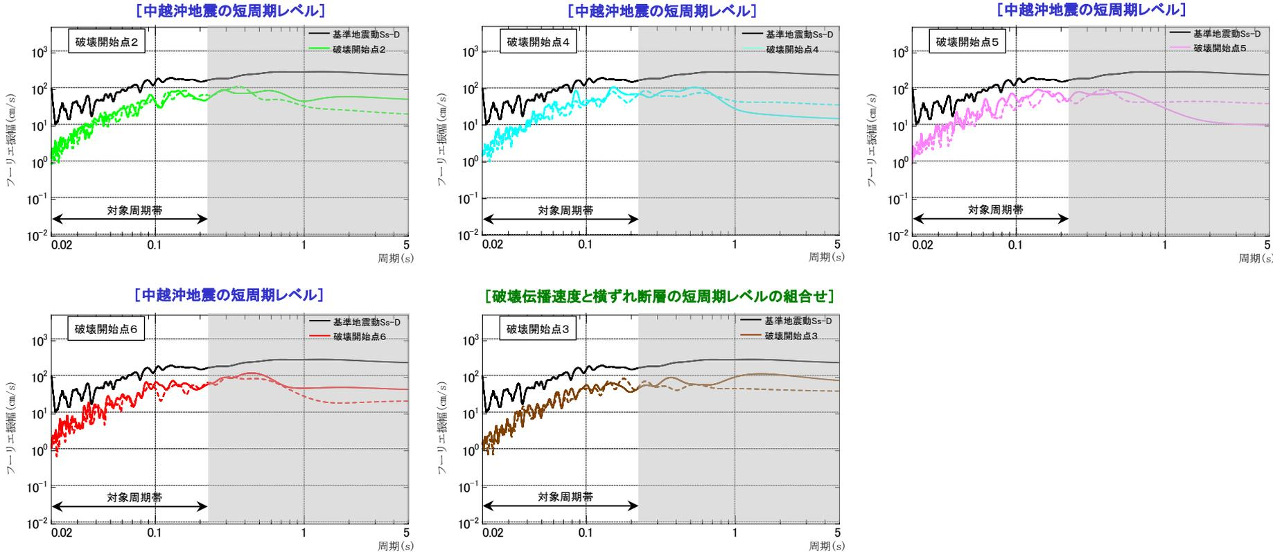
※ 各周期毎の「 $S_s-D$ /断層モデル」を対象周期帯の範囲で平均して算出(対象周期帯の各周期において地震動レベルが大きい方のフーリエ振幅スペクトルを用いて算出)
