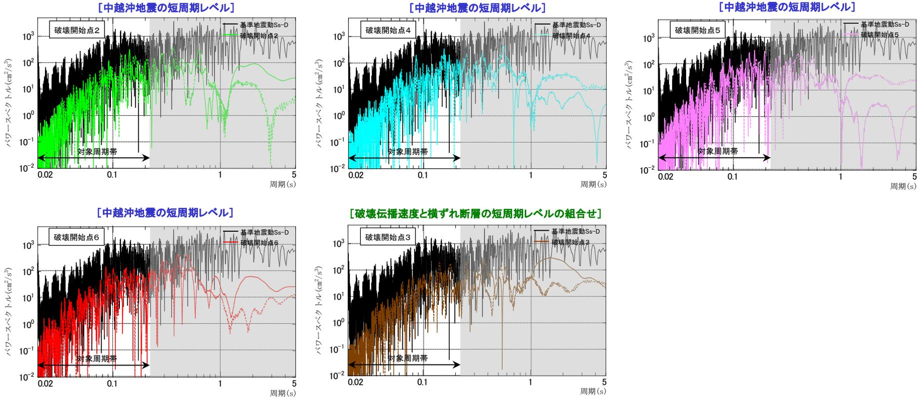
基準地震動Ss-D及び選定した断層モデル手法による地震動評価結果のパワースペクトルの比較
