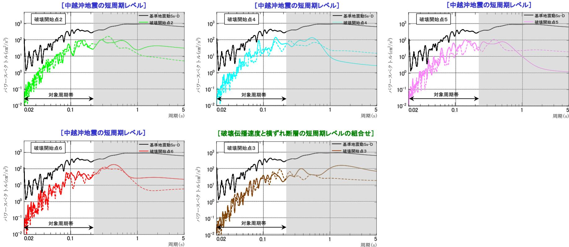
※ 各周期毎の「 $S_s-D$ /断層モデル」を対象周期帯の範囲で平均して算出(対象周期帯の各周期において地震動レベルが大きい方のパワースペクトルを用いて算出)
