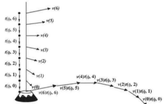
図 3 移流の概念図
