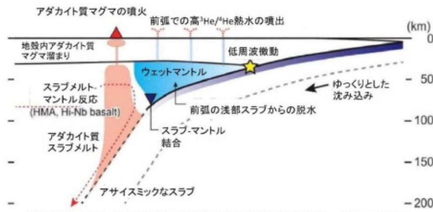
図 2.1.13 西南日本の沈み込み帯におけるマグマ供給系モデル (Kimura et al.
