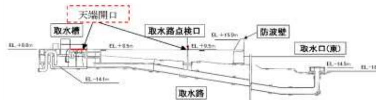
第 2.2-19 図 3号炉 取水施設の断面図
