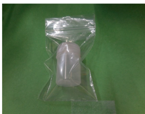
実験室への移動に用いる密閉容器 (試料を密閉容器 (ポリエチレン製) に入れた後、 ポリエチレン袋で養生)
