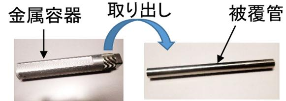
金属容器に収納された核燃料物質で汚染された被覆管(ステンレス鋼)等
