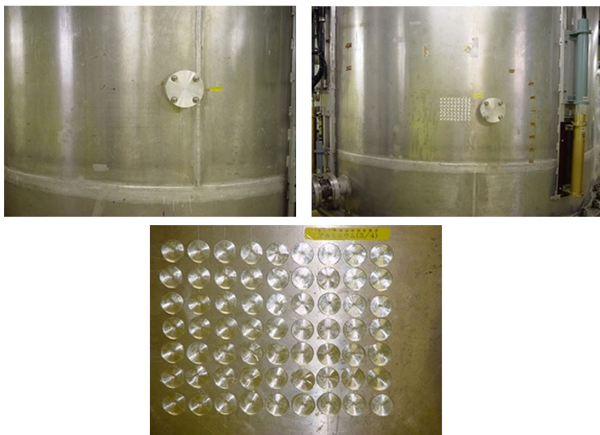
サンプリング箇所(原子炉容器)
