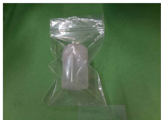
実験室への移動に用いる密閉容器 (試料を密閉容器 (ポリエチレン製) に入れた後、 ポリエチレン袋で養生)
