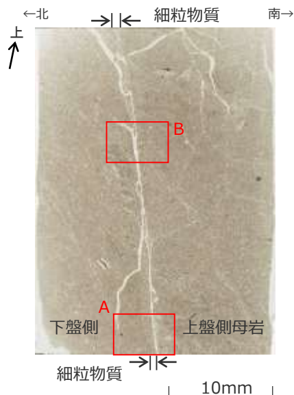
<ブロック試料から作成した薄片写真（単ニコル）>
