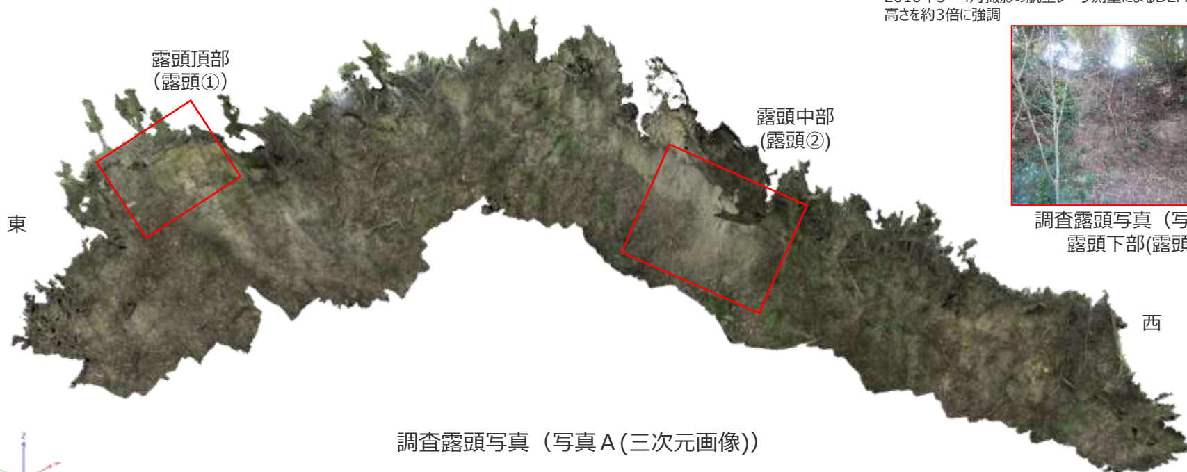
2010年3～4月撮影の航空レーザ測量によるDEMデータより作成 高さを約3倍に強調
