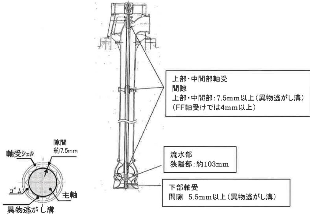
図3 海水ポンプ軸受構造図
