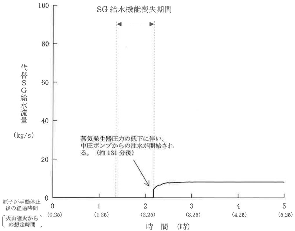
第4図 蒸気発生器2次側への注水流量
