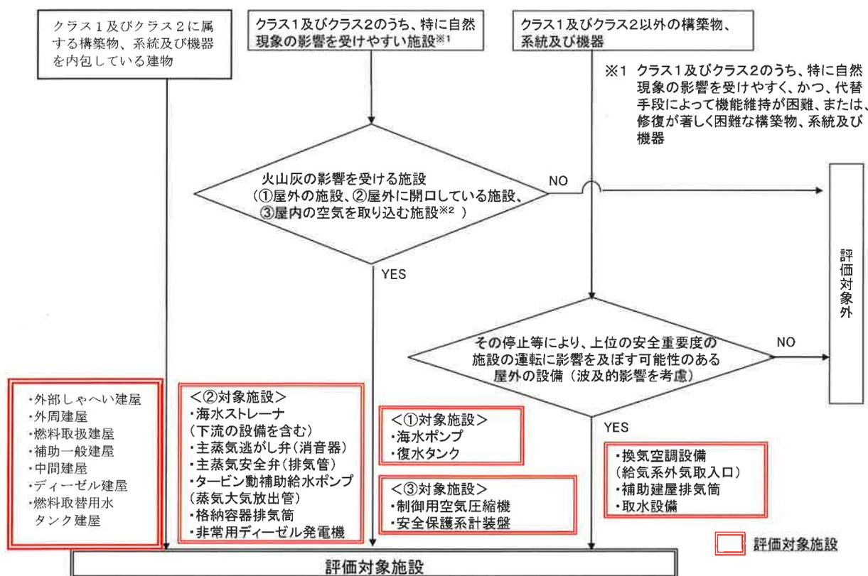
※2 火山灰を含む外気・室内空気を機器内に取り込む機構を有しない施設又は取り込んだ場合でも、その影響が非常に小さいと考えられる施設(ポンプ、モータ、弁、盤内に換気ファンを有しない制御盤、計器等)については、評価対象外とする。
