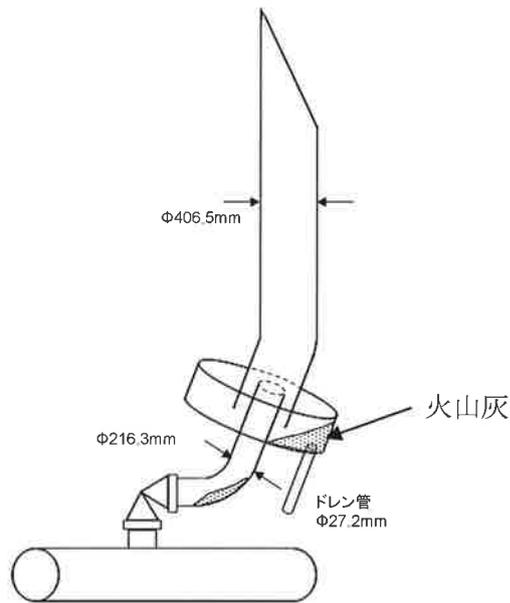
図 1 主蒸気安全弁排気管の構造図
