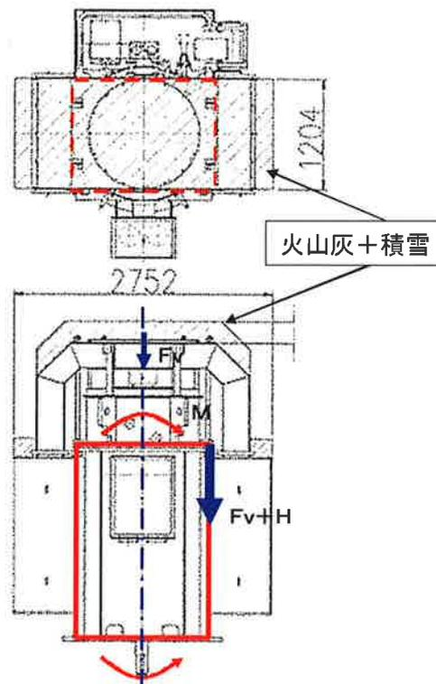
図1 海水ポンプモータフレーム構造
