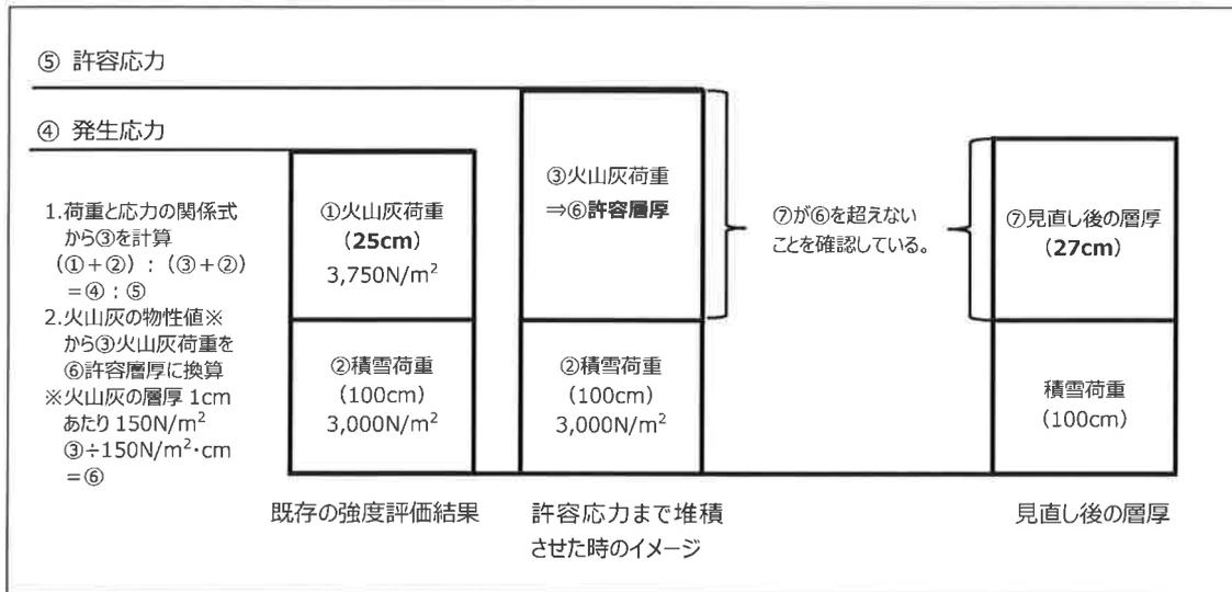
図 2 成立性確認の概要図 (許容層厚)
