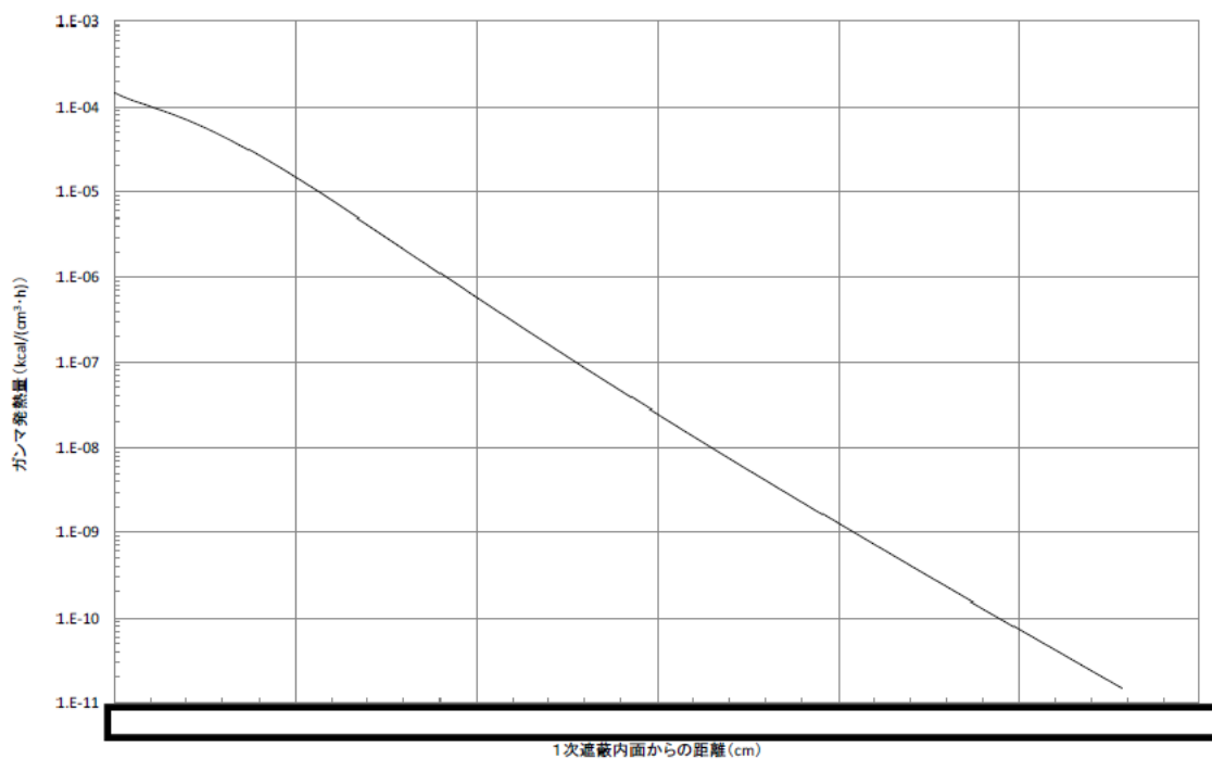
図2 1次遮蔽壁（コンクリート）内のガンマ発熱量分布
