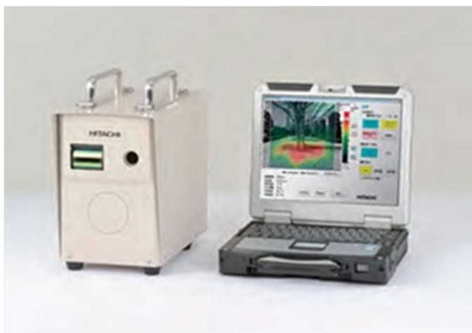
ピンホール型ガンマカメラ 日立製 HDG-E1500
