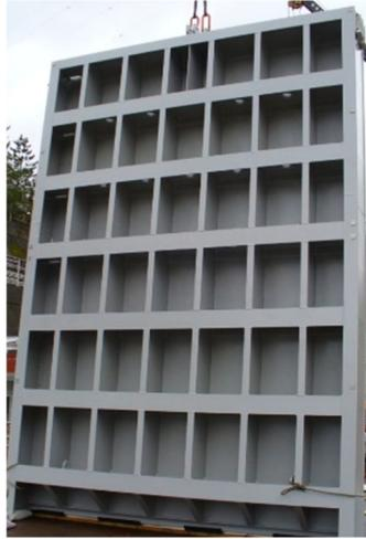
第 7-1-13 図 取水路下流側から見たゲート扉体の構造
