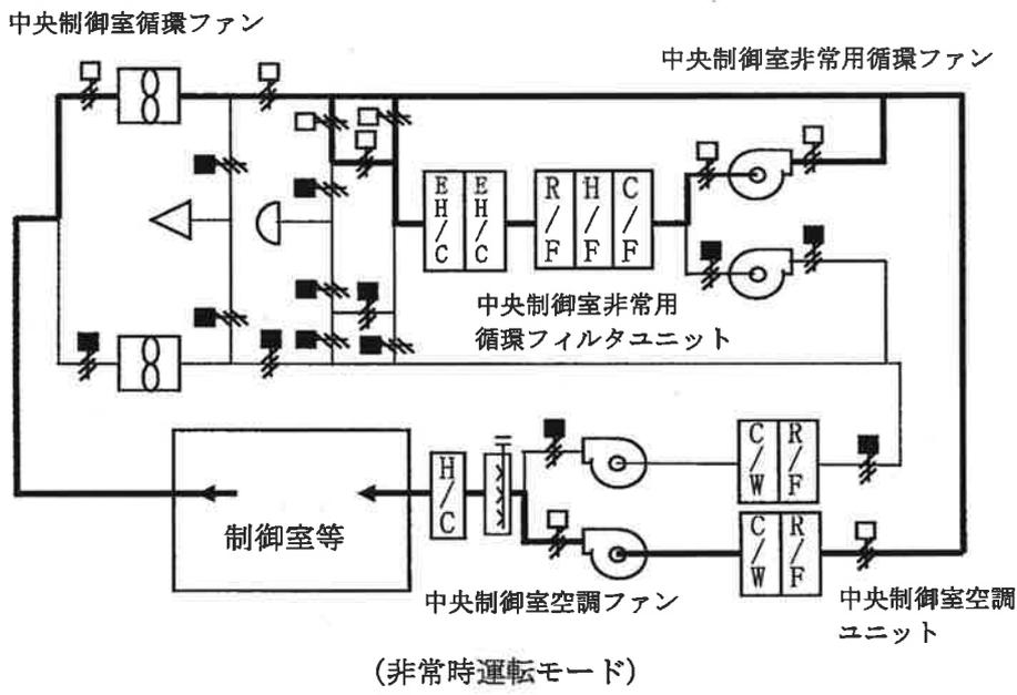
(注)上記は3号炉の制御室換気空調設備の概要図を示す。4号炉も同じ。
