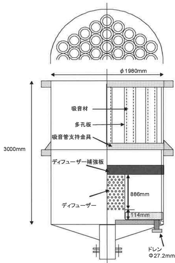
図1 主蒸気逃がし弁消音器の構造図
