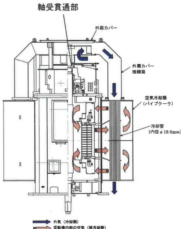
図 4 海水ポンプモータの冷却方式
