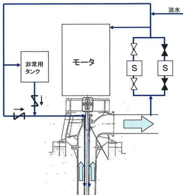
図2 海水ポンプ軸受潤滑水系統概略図
