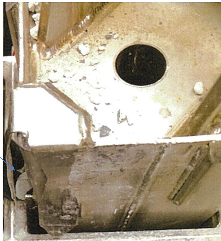
振動付与により引き抜けた模擬燃料
