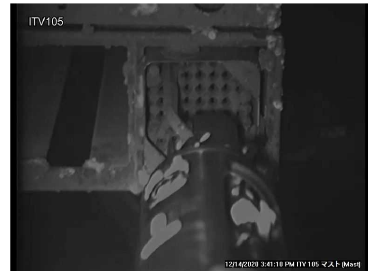
吊り上げ確認の状況 (24燃料)
