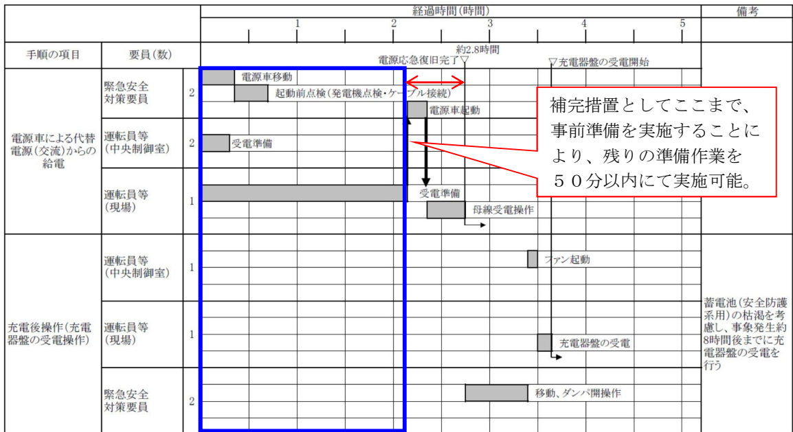
第1.14.15図 電源車による代替電源(交流)からの給電 タイムチャート
