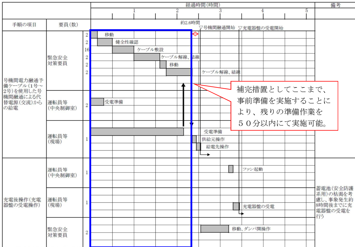
第1.14.18図 号機間電力融通予備ケーブル(1号~2号)を使用した号機間融通による代替電源(交流)からの給電 タイムチャート
