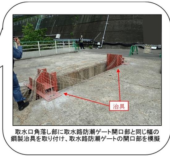
別添図 1 挿入試験における配置図
