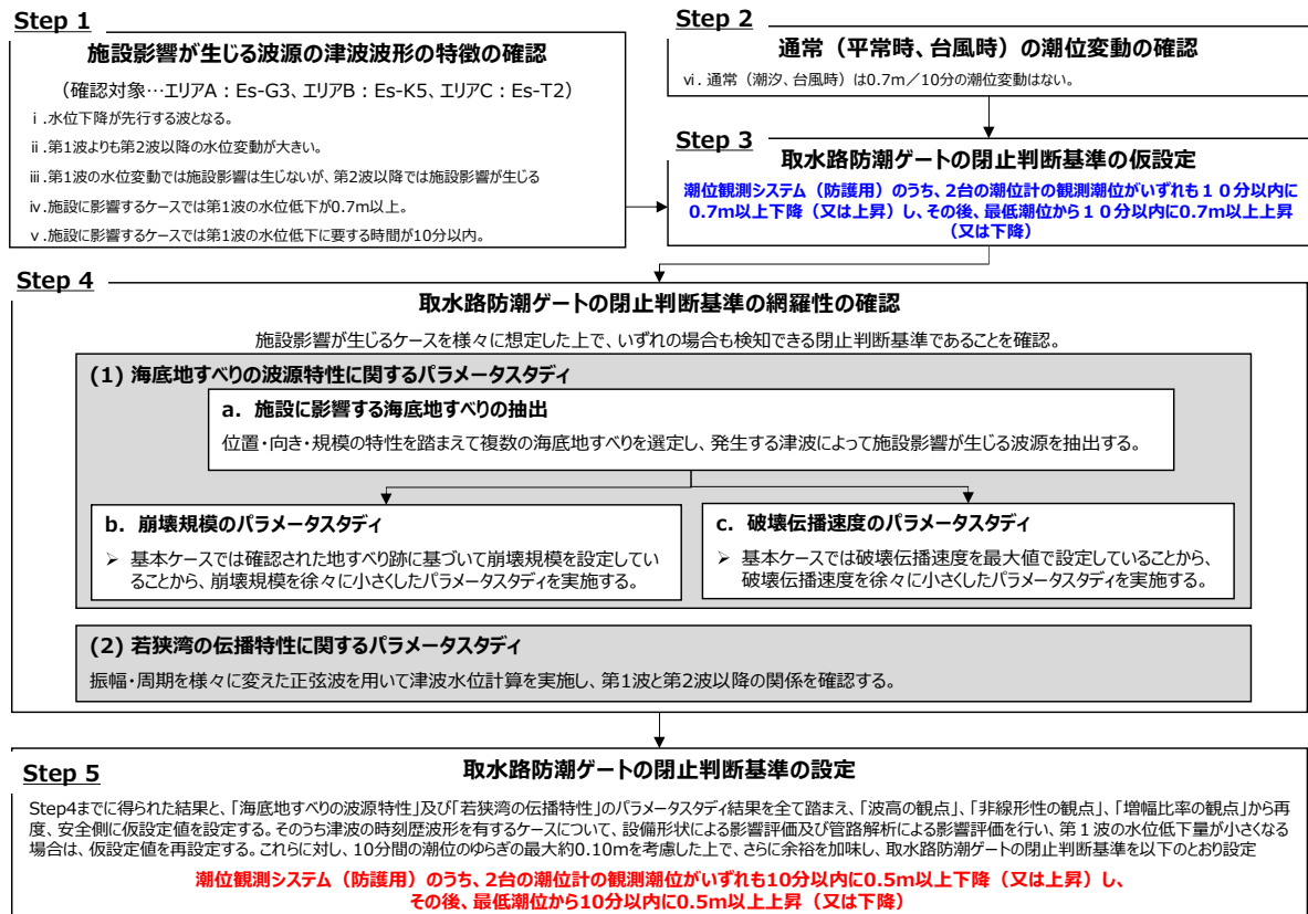
第2-6-1図 取水路防潮ゲートの閉止判断基準の設定フロー
