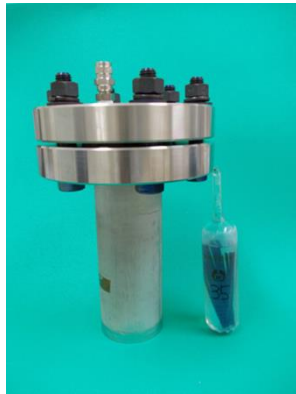
図 2.3-3 180°Cの脱酸素条件でのジルカロイの腐食量測定方法の概略図と写真
