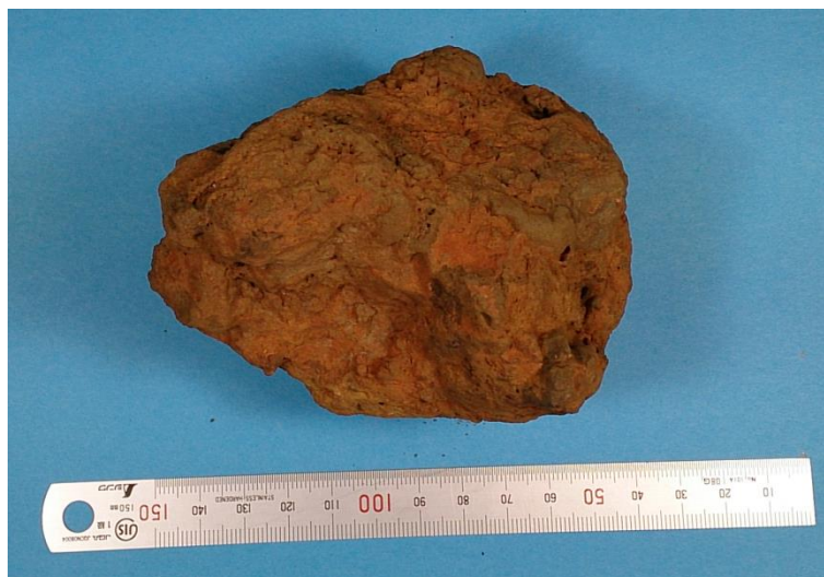
図 2.2-21 宮原金山遺跡から出土した鉄滓試料（番号 12-3）
