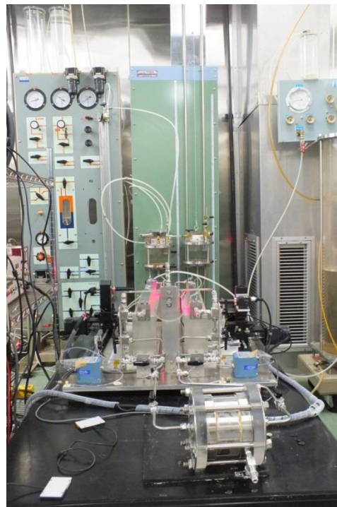
図 2.5-9 高精度定水位試験装置の外観
