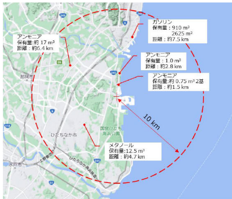
図-4 敷地外固定源と再処理施設の位置関係 (google map に加筆)
