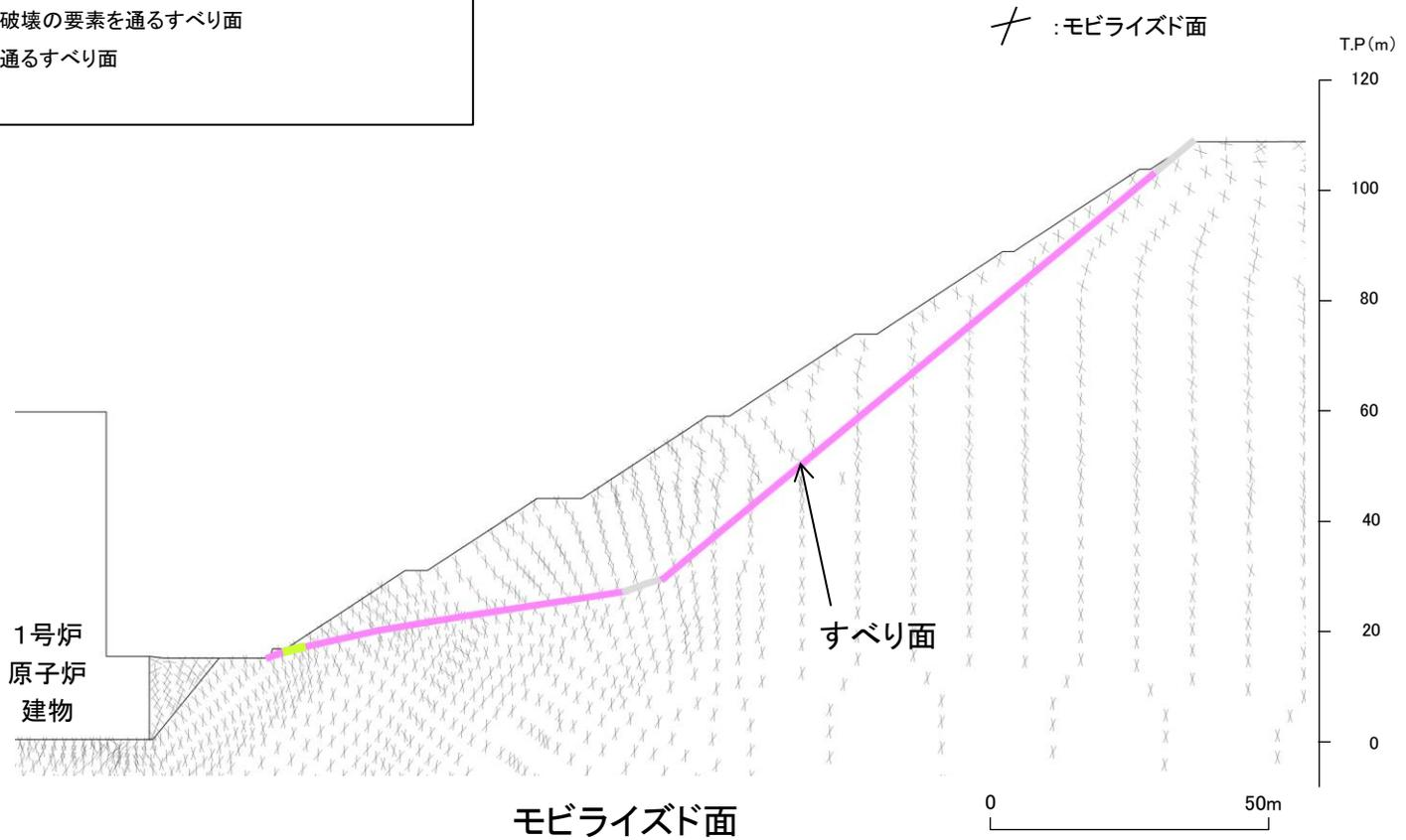
・モビライズド面を通過していないが、強度の低いシームや破壊領域を通るすべりになっている。
