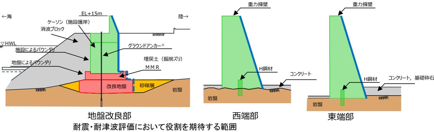
※ 防波壁(波返重力擁壁)は、グラウンドアンカー(自主設備)の効果も期待しなくても、耐震・耐津波安全性を担保している。
