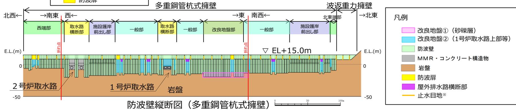
防波壁縦断図 (多重鋼管杭式擁壁)
