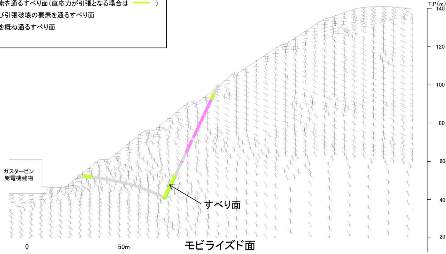
・モビライズド面を通過していないが、強度の低いシームや破壊領域を通るすべりになっている。
