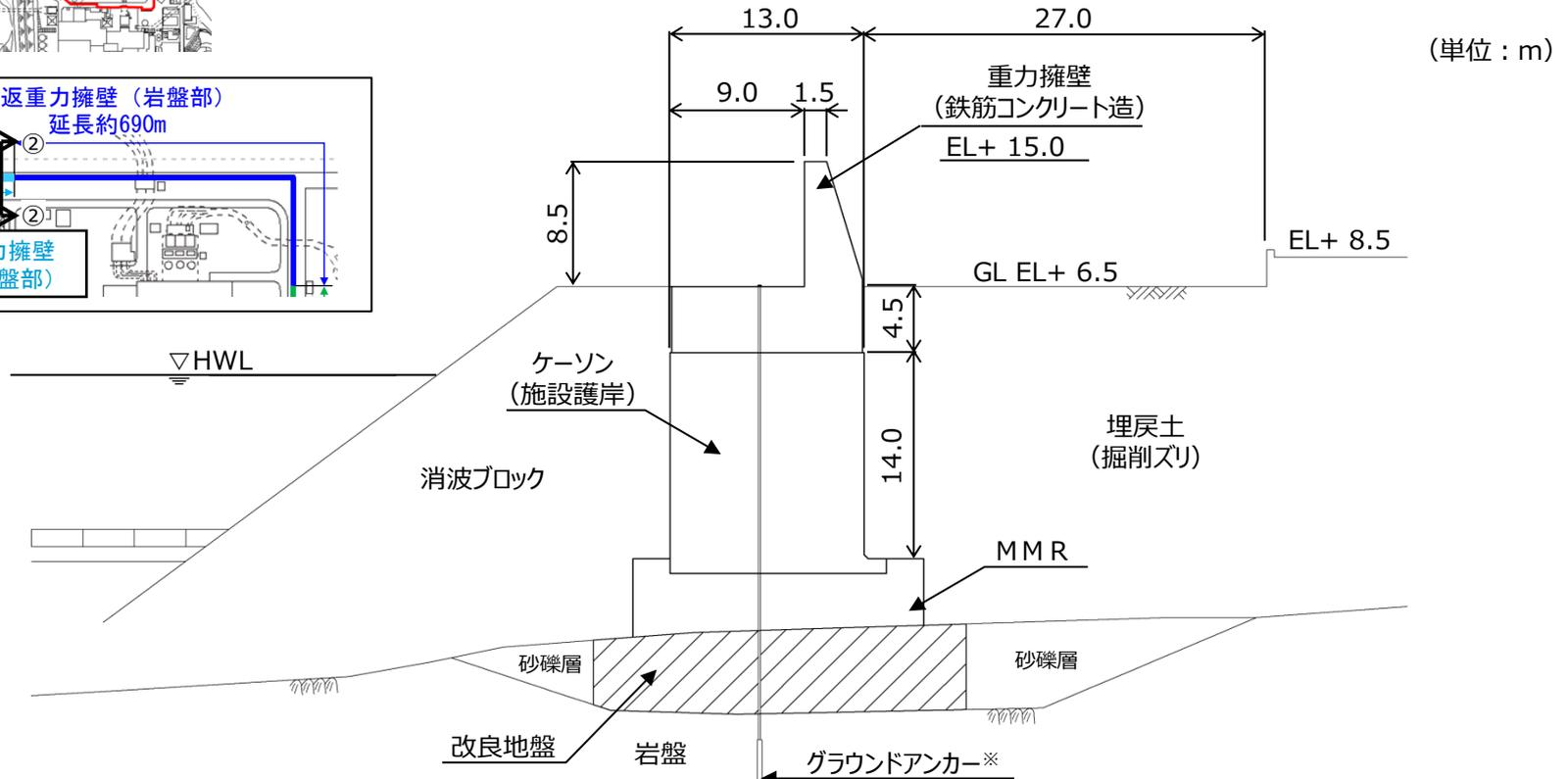
※ 防波壁(波返重力擁壁)は、グラウンドアンカーの効果을期待しなくても、耐震・耐津波安全性を担保している。
