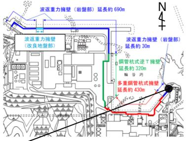
■ 防波壁(波返重力擁壁)東端部(⑤-⑤断面)については、地震及び津波による沈下やずれを生じさせないため、岩盤を露出させ、H鋼(H-350×350×12×19)を1m間隔で打設し、重力擁壁を堅硬な地山に直接設置する設計とした。また、前面及び背面をコンクリートで被覆した。
