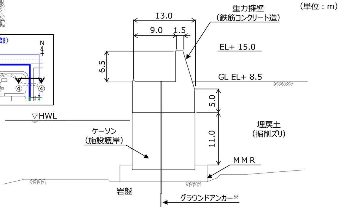
※ 防波壁(波返重力擁壁)は、グラウンドアンカーの効果을期待しなくても、耐震・耐津波安全性を担保している。
