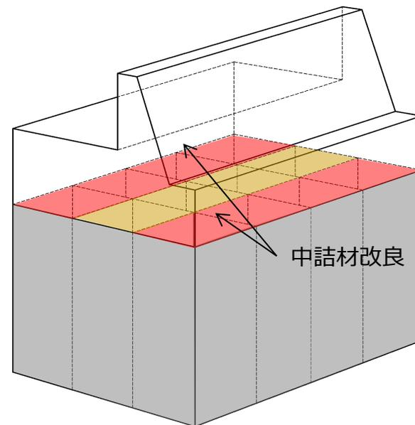
ケーソン(輪谷部)耐震補強対策工(例)
