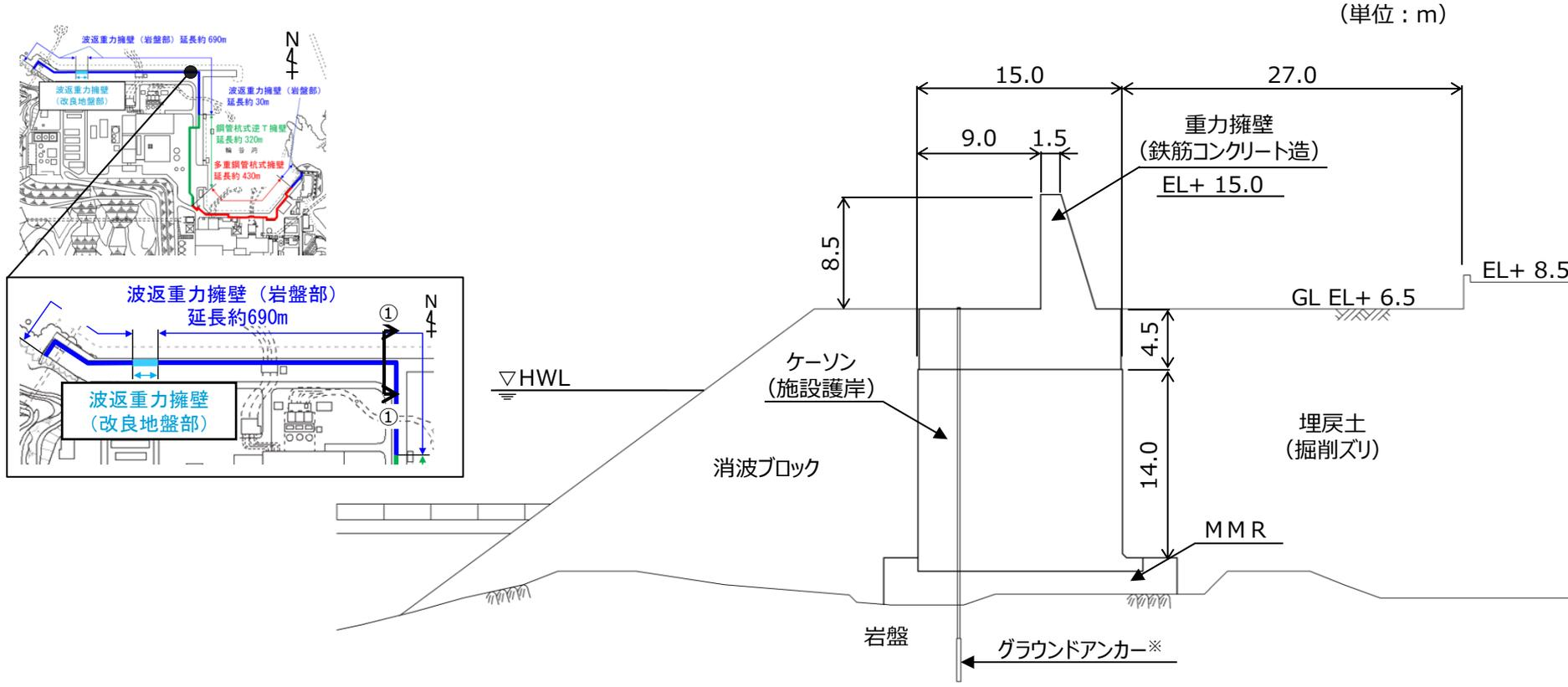
\* 防波壁(波返重力擁壁)は、グラウンドアンカーの効果을期待しなくても、耐震・耐津波安全性を担保している。
