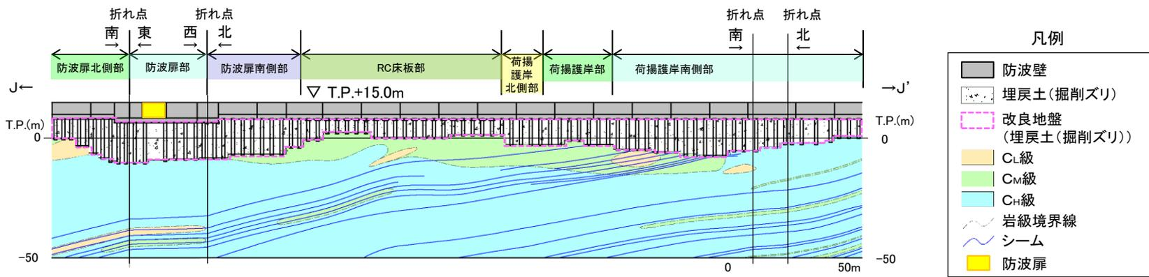
※1 図中の [ ] については、地盤改良を実施しているが、元の埋戻土(掘削ズリ)の分布を示すために、改良前の地質状況を示している。 ※2 図中の杭は投影している。
