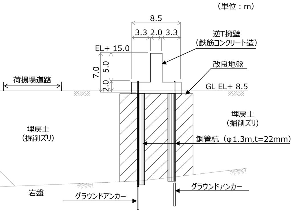
防波壁(鋼管杭式逆T擁壁)防波扉南側部(④-④断面) 断面図
