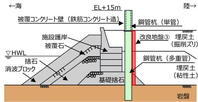
防波壁(多重鋼管杭式擁壁)断面図
