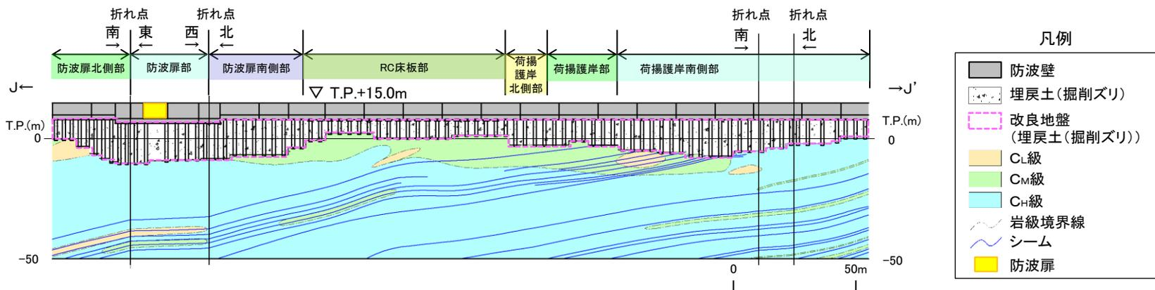
※1 図中の [改良地盤] については、地盤改良を実施しているが、元の埋戻土(掘削ズリ)の分布を示すために、改良前の地質状況を示している。 ※2 図中の杭は投影している。
