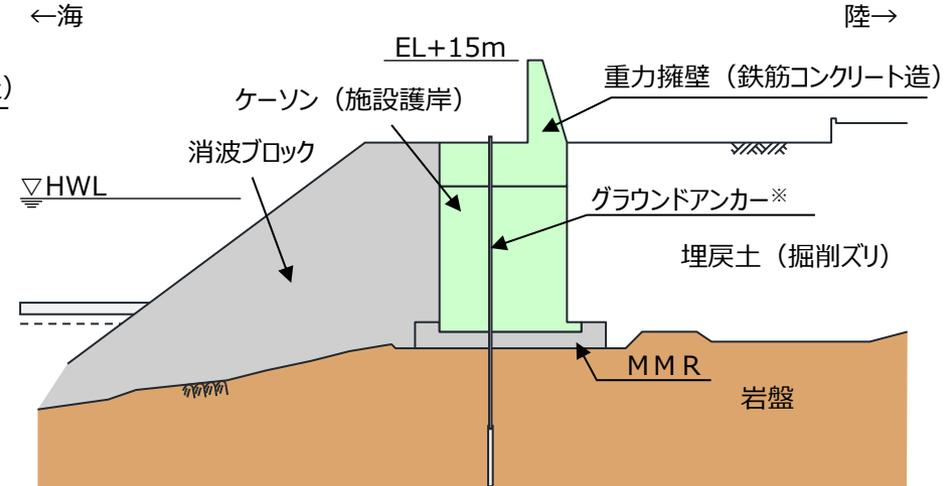
※ 防波壁(波返重力擁壁)は、グラウンドアンカーの効果을期待しなくても、耐震・耐津波安全性を担保している。
