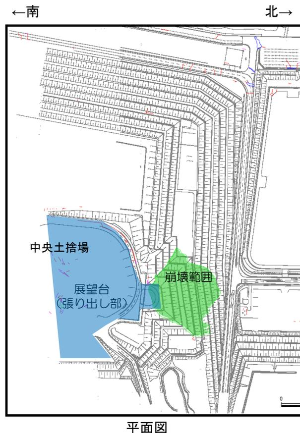
新潟県中越沖地震時に中央土捨場の展望台付近で表層崩壊が発生。崩壊土砂は法尻までには到達せず、斜面部に留まっていた。
