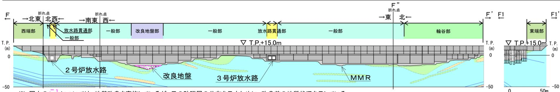
※ 図中の [ ] については、地盤改良を実施しているが、元の砂礫層の分布を示すために、改良前の地質状況を示している。
