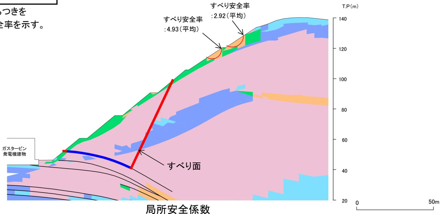
・引張応力が発生した要素が斜面に連続しており、これを通るすべり面になっている。
