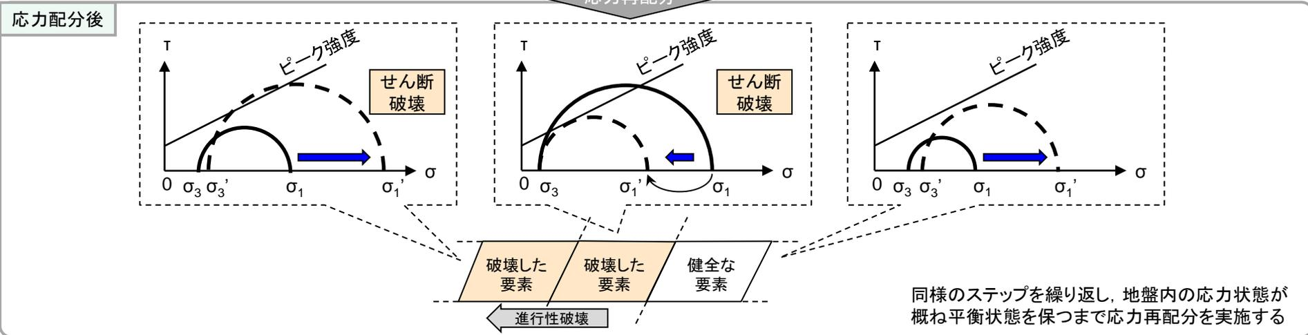
同様のステップを繰り返し、地盤内の応力状態が概ね平衡状態を保つまで応力再配分を実施する
