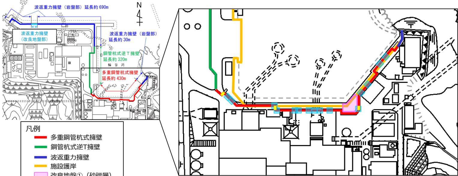
防波壁平面図 (多重鋼管杭式擁壁)
