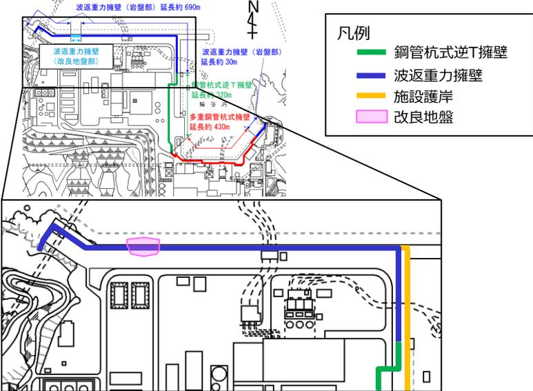
防波壁平面図(波返重力擁壁)
