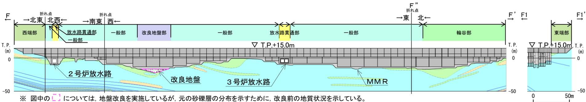
※ 図中の [ ] については、地盤改良を実施しているが、元の砂礫層の分布を示すために、改良前の地質状況を示している。
