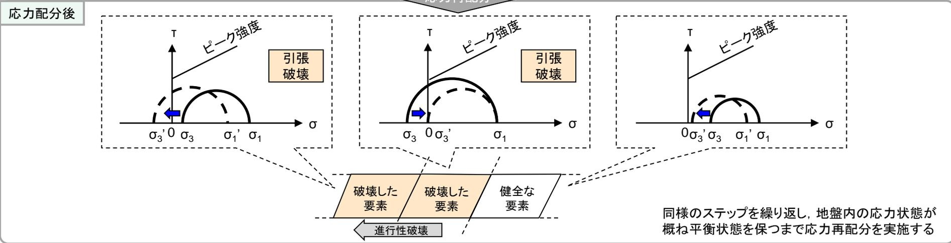
応力再配分前後のモールの応力円(引張破壊の場合)
