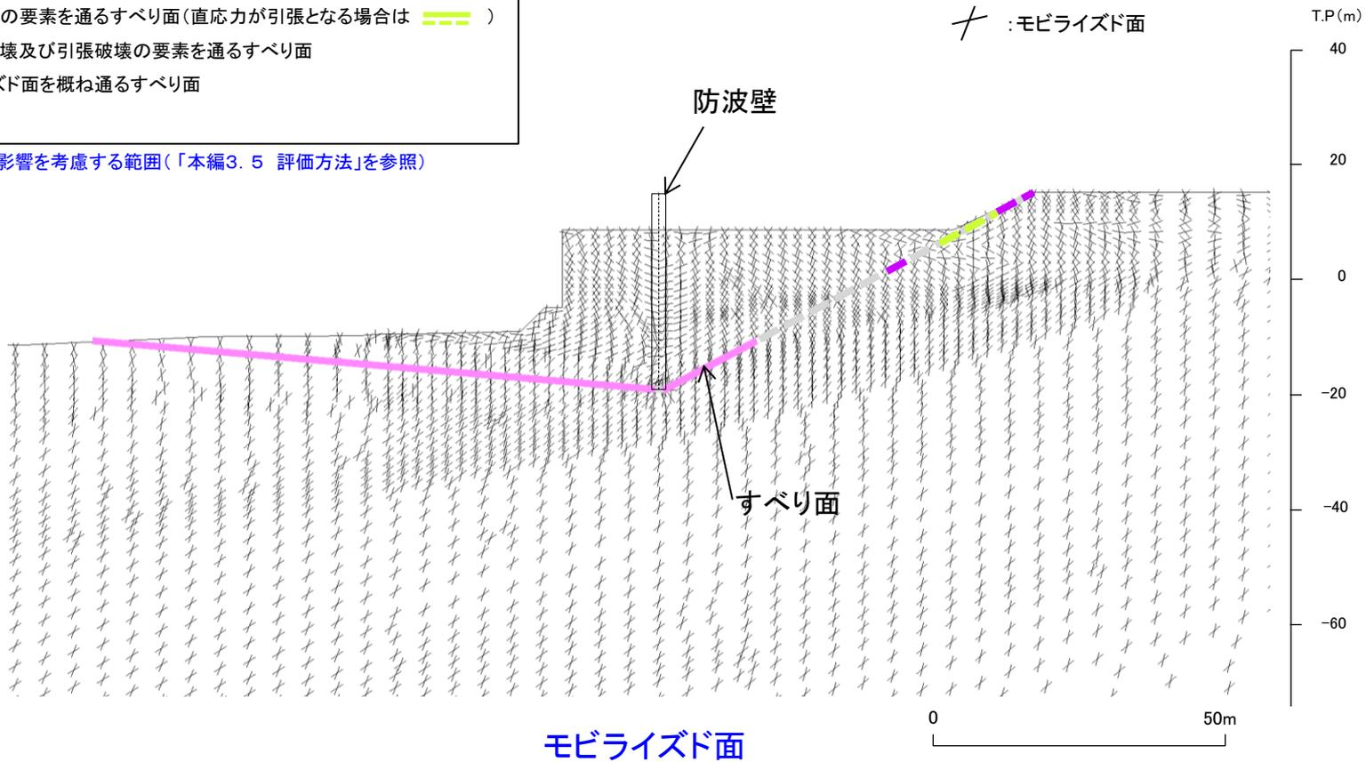
・モビライズド面を通過していないが、破壊領域を通るすべりになっている。
