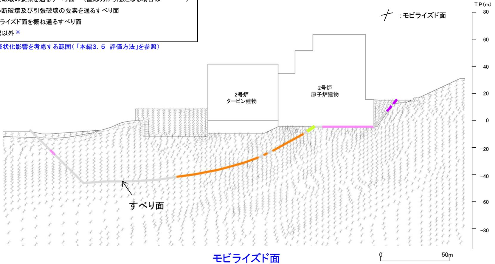
・モビライズド面を通っていないが、すべり安全率がより厳しくなるシームや破壊領域を通るすべり面になっている。
