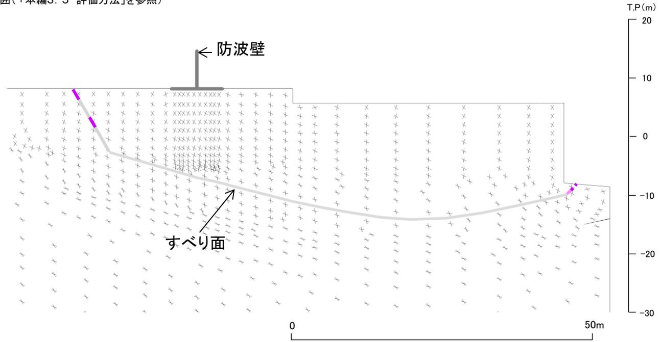
・モビライズド面を通過していないが、強度の低いシームや破壊領域を通るすべりになっている。
