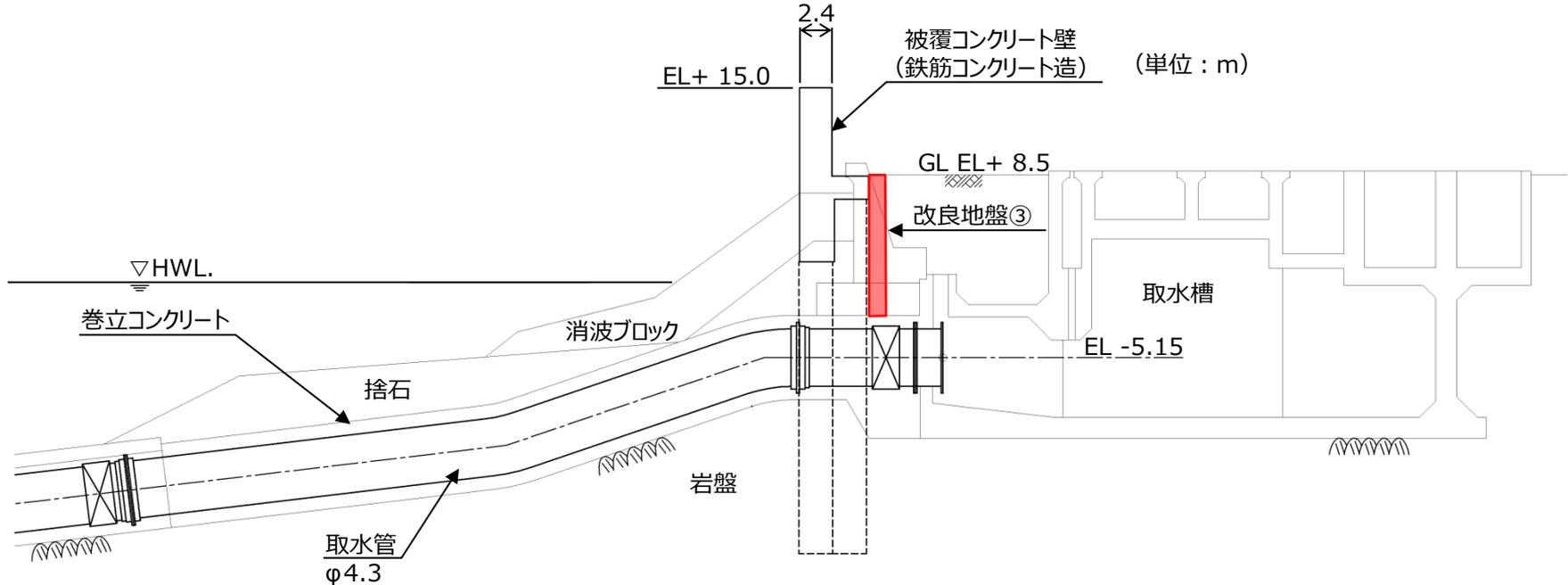
防波壁(多重鋼管杭式擁壁)取水路横断部(④-④断面) 断面図
