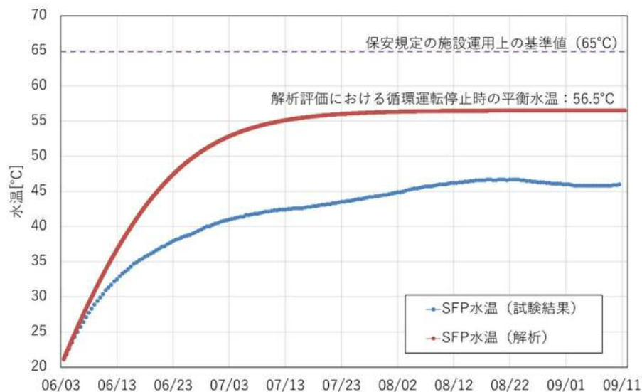
図 2-9 FPC 循環運転停止時の SFP 水温評価結果
