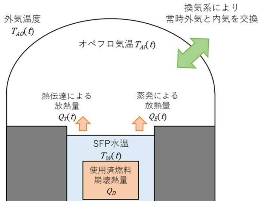
図2-8 FPC循環運転停止時のSFP水温評価モデル
