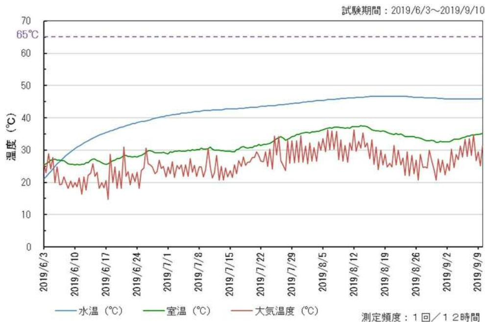
図 2-4 試験時の SFP 水温、室温及び気温の測定結果
