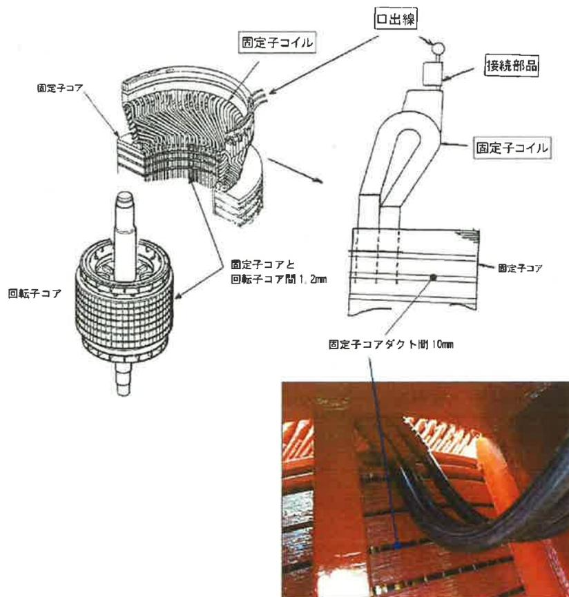
図 6 海水ポンプモータの内部構造
