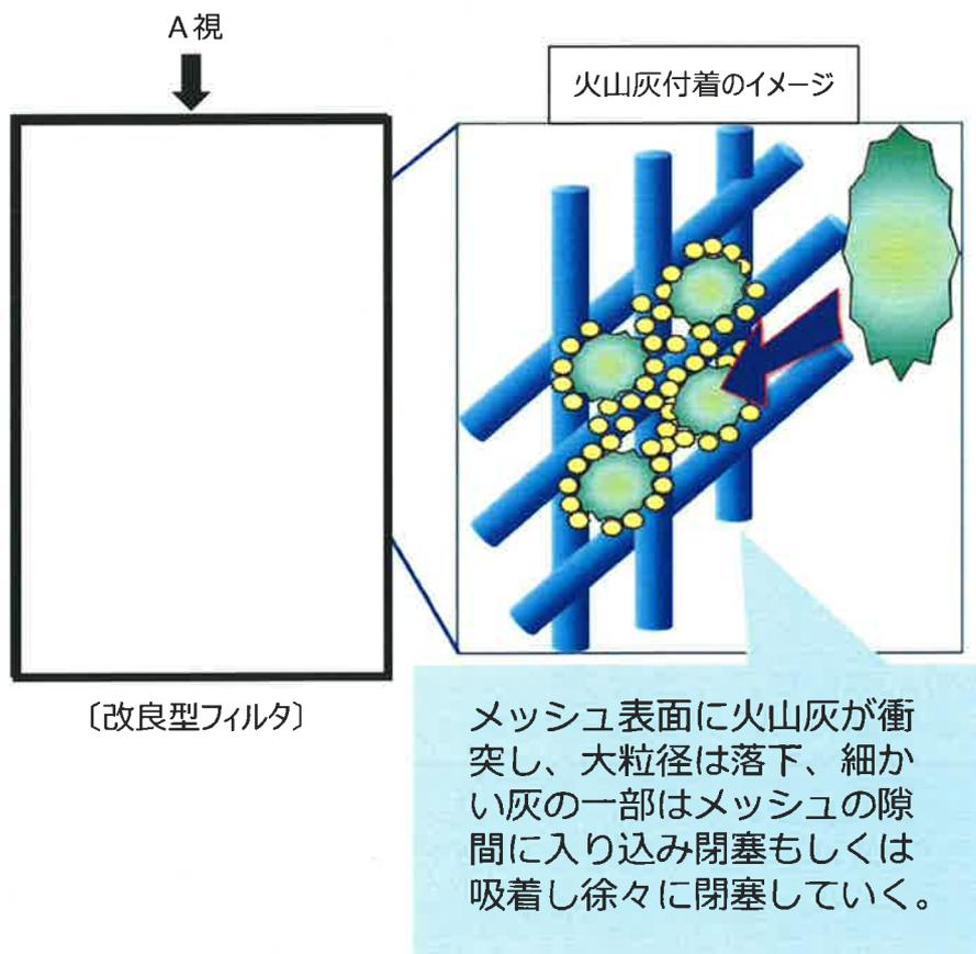
図2 改良型フィルタの火山灰捕集の概要図
