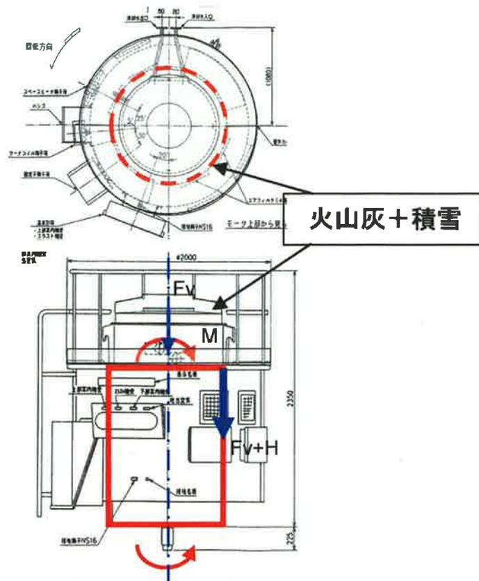
図1 海水ポンプモータフレーム構造
