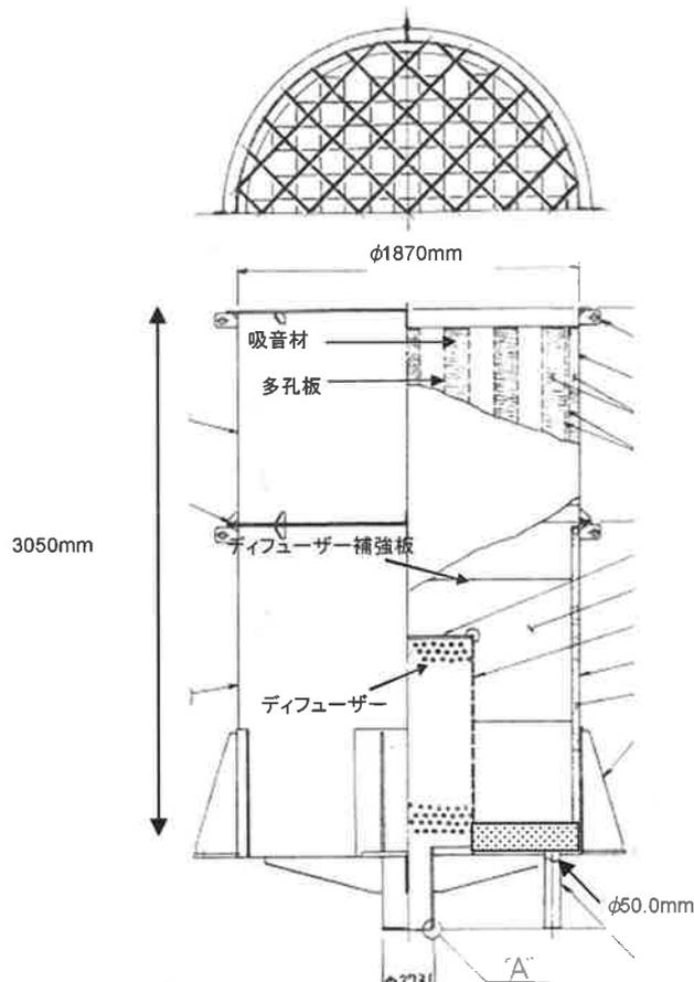
図1 主蒸気大気放出弁消音器の構造図
