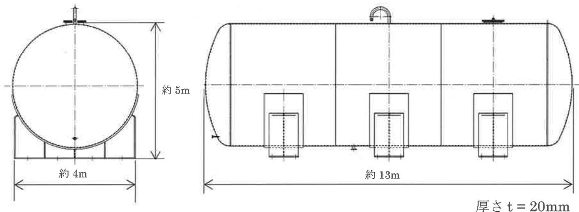
図 1 消火水バックアップタンクの構造
