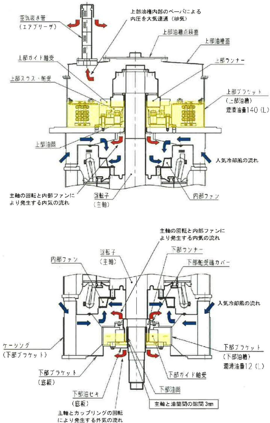
図5 海水ポンプモータの軸受構造図
