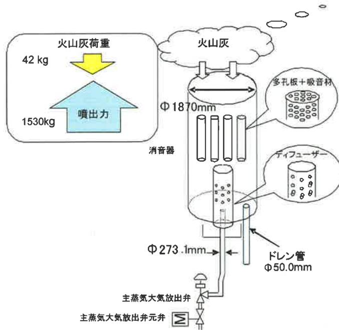
図2 主蒸気大気放出弁出口配管形状および消音器の構造
