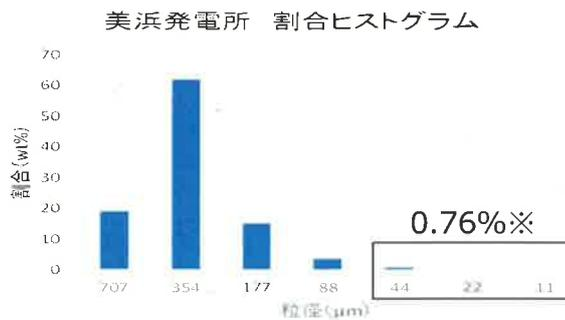
※改良型フィルタの仕様は、300メッシュ（開き目45 $\mu\text{m}$ 程度）であるため、数値シミュレーション（Tephra2）結果の粒径分布による44 $\mu\text{m}$ 以下の小粒径割合となる。
