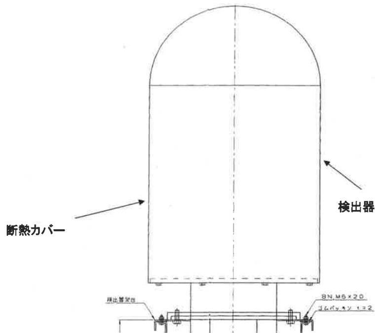
図 モニタリングポストの外観図
