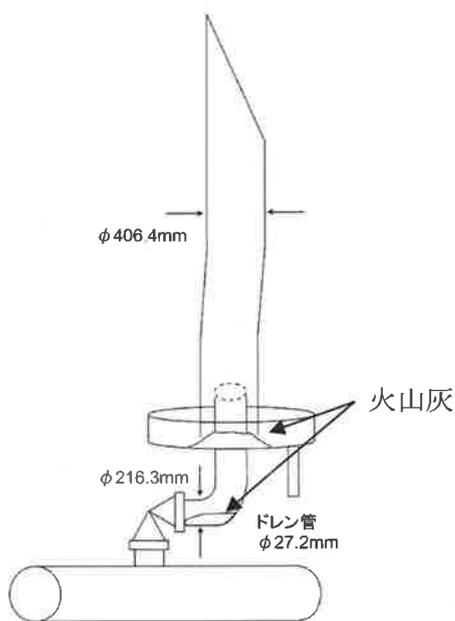
図 1 主蒸気安全弁排気管の構造図
