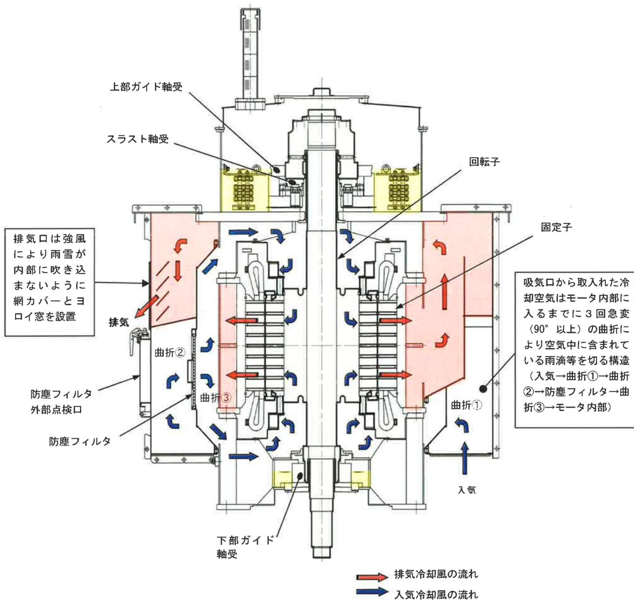
図4 海水ポンプモータの冷却方式
