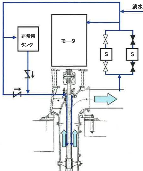
図2 海水ポンプ軸受潤滑水系統概略図
