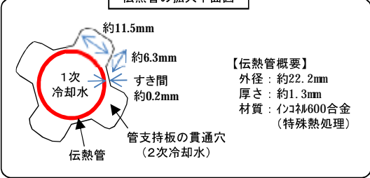
伝熱管の拡大平面図
