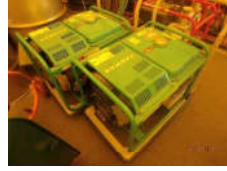
⑨可搬型発電機
