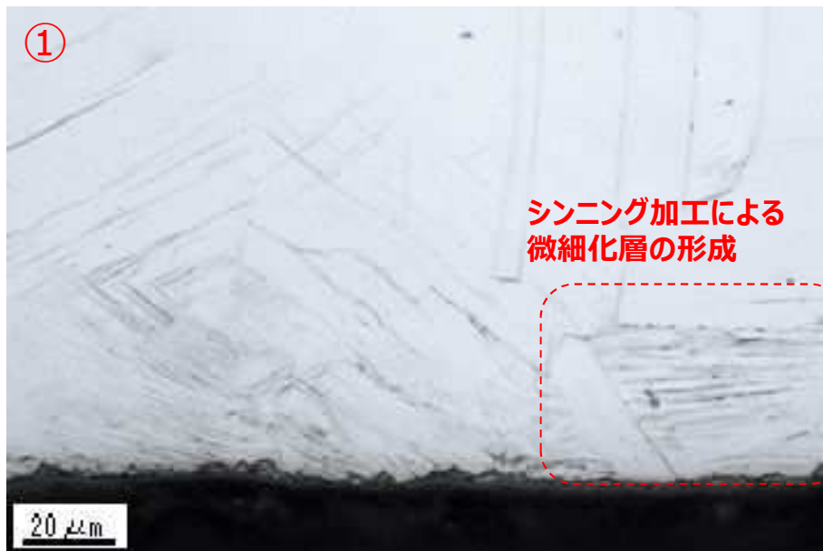
図：当該部の溶接境界近傍とシンニング部の断面ミクロ比較
