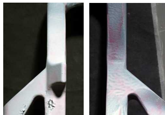
ハンドル引張試験後の浸透探傷試験結果 （9×9燃料（A型），荷重26kN）
