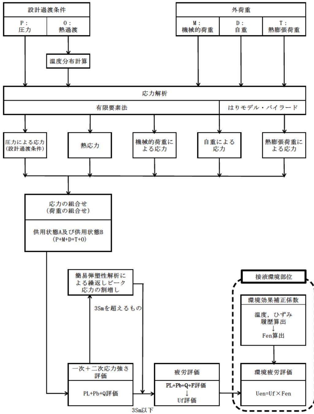
図 5(1/2) 疲労評価の解析フロー (スタッドボルトを除く部位)
