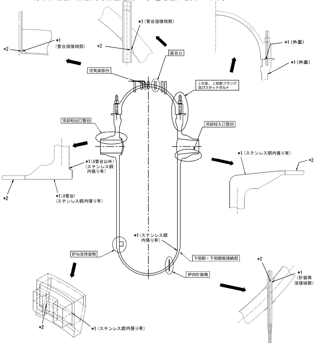
\*1: 「設計・建設規格」に基づく疲労評価対象部位(最大) (非接液部の場合は ( ) 内に理由を記載)
