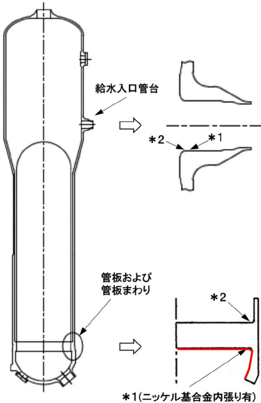
\*1 : 「設計・建設規格」に基づく疲労評価対象部位(最大)
