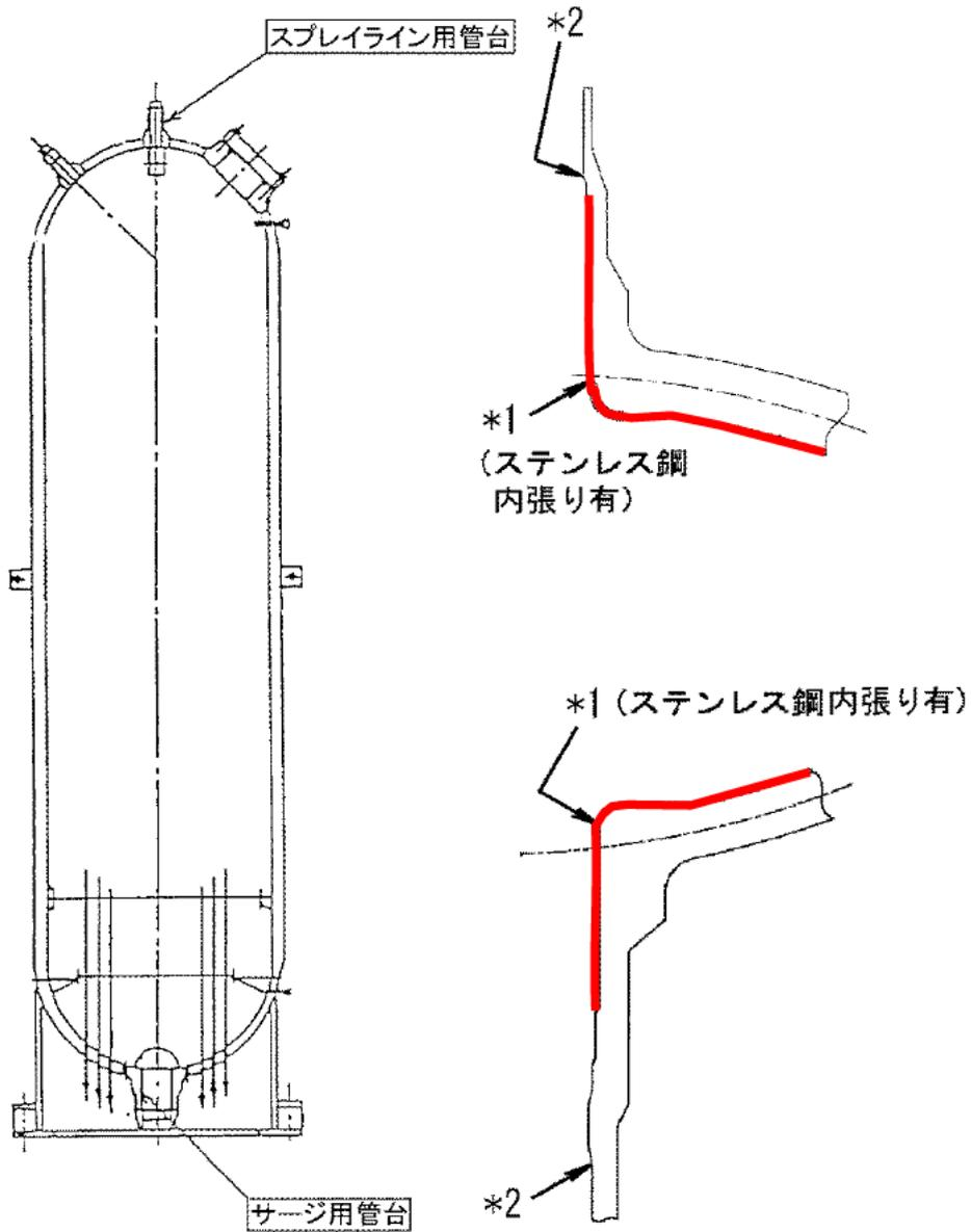
\* 1 : 「設計・建設規格」に基づく疲労評価対象部位(最大)
