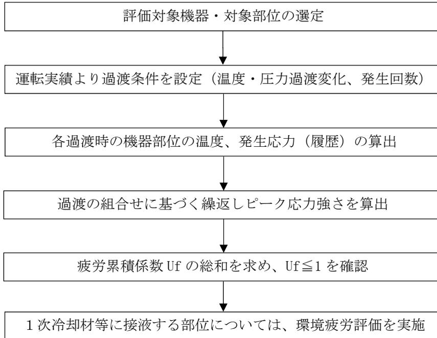
図1 低サイクル疲労の技術評価フロー
