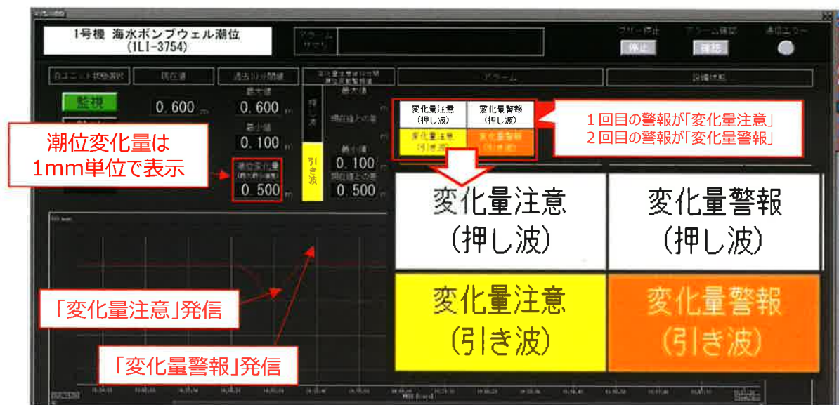
図3 監視モニタ画面イメージ（変化量警報（引き波）発信後）
