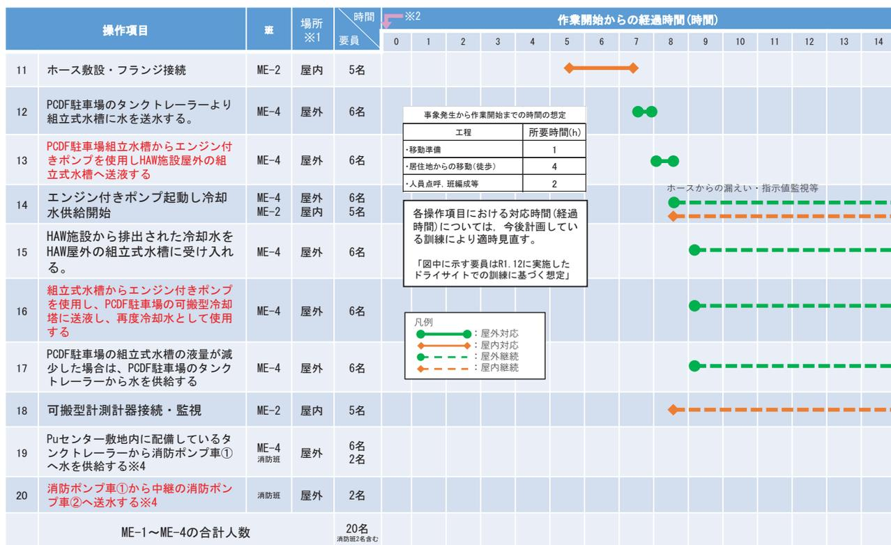
未然防止対策 ②1/2：冷却コイルに水を供給し、可搬型冷却塔により冷却する（訓練実績整理表）
