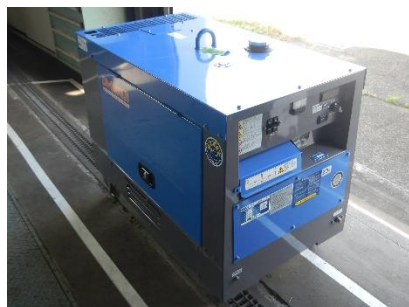
可搬型発電機
